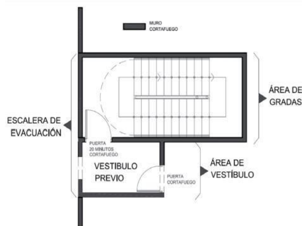
Figura: escalera de evacuación
