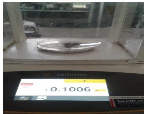
Pesos de las diferentes dosis de la ceniza de cascarilla de arroz
