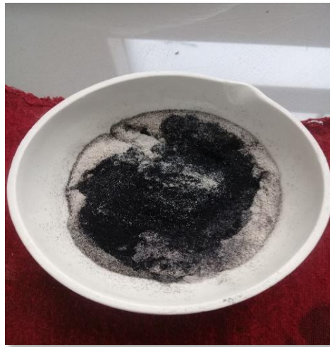
Calcinación de cascarilla de arroz
