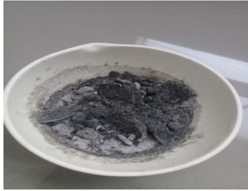
Activado de la ceniza de cascarilla de arroz con NaOH
