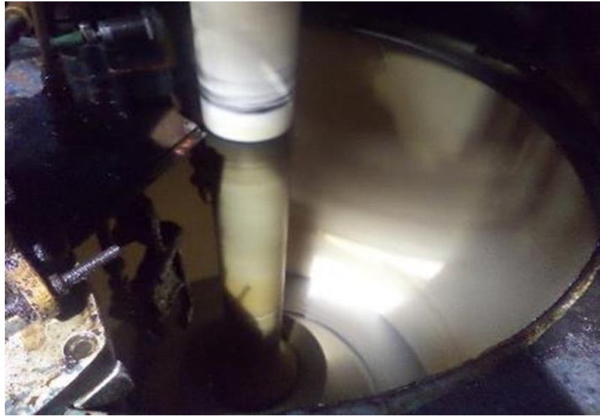
Figura 6. Centrífuga automática ejecutando el proceso de centrifugación
