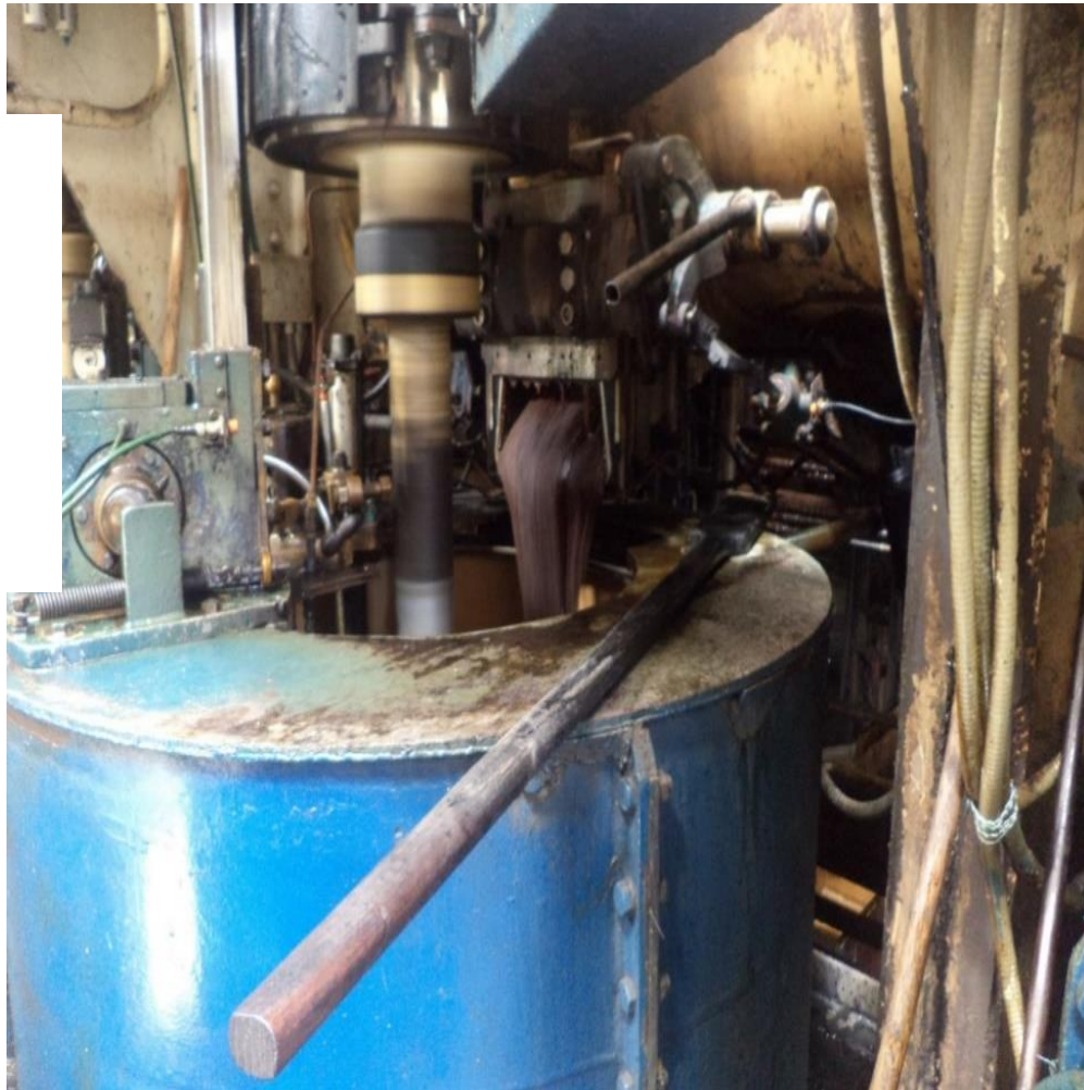
Figura 5. Centrífuga automática acogiendo la masa cocida para el proceso de centrifugación
