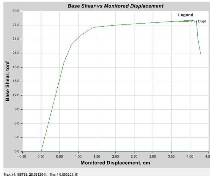
Figura 53: Curva de capacidad de estructura regular ER1-C
