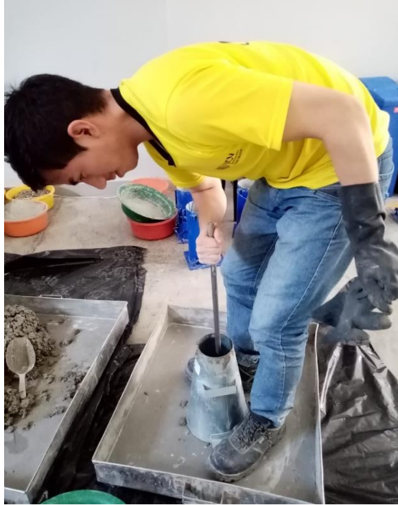
Prueba del slump.
