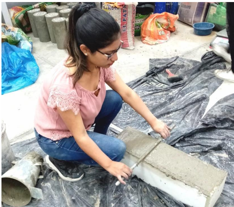
Enrasado de las vigas para eliminar material sobrante.
