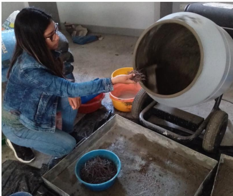
Adición de la fibra de acero tipo CHO 80/60 NB al trompo mezclador.
