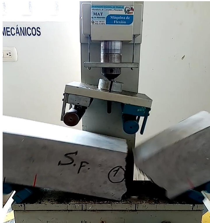
Rotura de viga sin fibra de acero.
