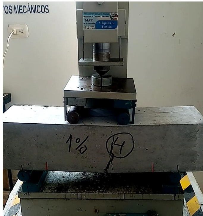
Rotura de viga con fibra de acero.
