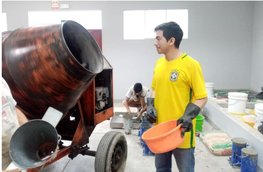
Preparación de mezcla para vigas prismáticas.
