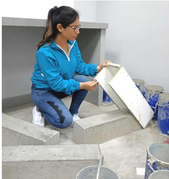
Desmoldado de las vigas prismáticas.
