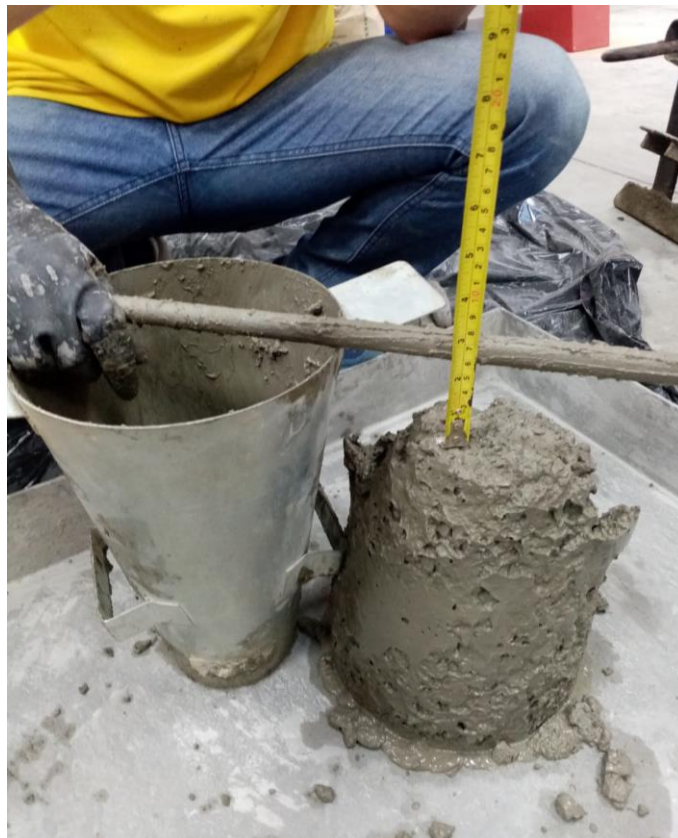
Prueba de Slump antes del llenado a los moldes de vigas.
