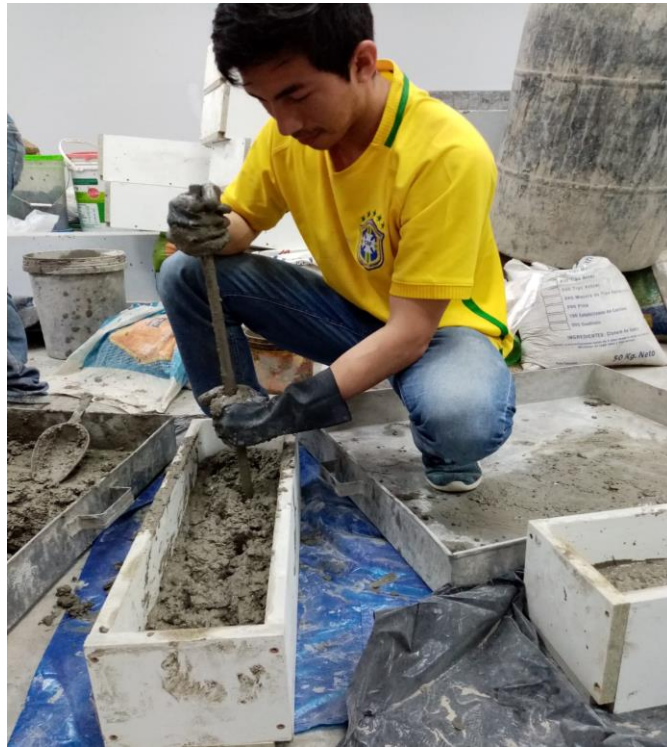
Varillado de la mezcla para eliminar vacíos.
