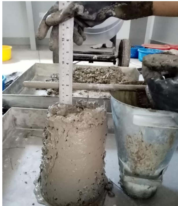
Prueba del slump.
