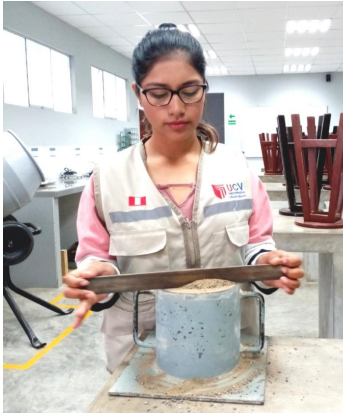
Enrasado del agregado fino para ensayo de peso unitario y vacío.
