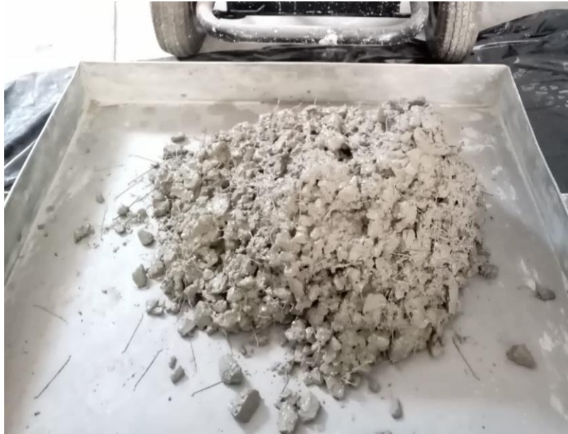
Mezcla de concreto con adición de fibra de acero tipo CHO 80/60 NB.
