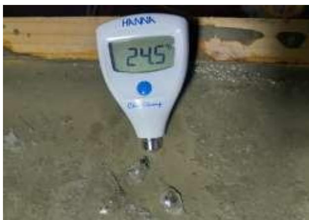
Figura 8. Termómetro para medición de temperatura del concreto. Fuente: Jauregui Guerra (2019)
