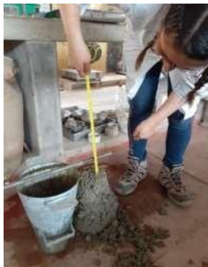
Figura 5. Medición de SLUMP
