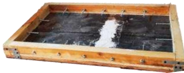
Figura 14. Molde de losa para ensayo de potencial de fisuración
