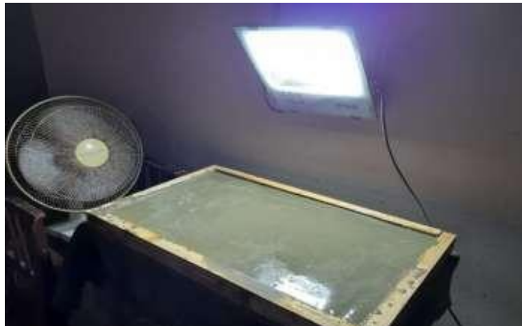
Figura 18. Concreto expuesto a extremas condiciones.
