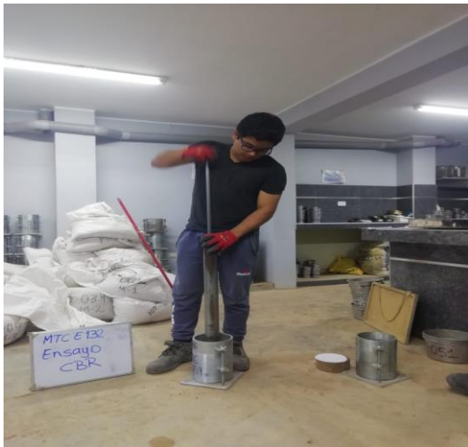
Figura 60. Compactación en molde 6" para CBR
