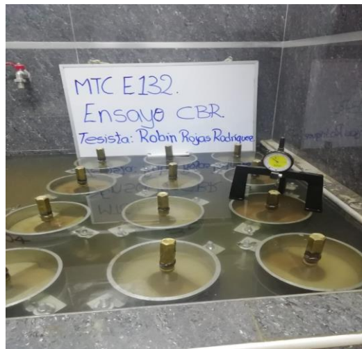
Figura 61. Moldes sumergido por 4 días
