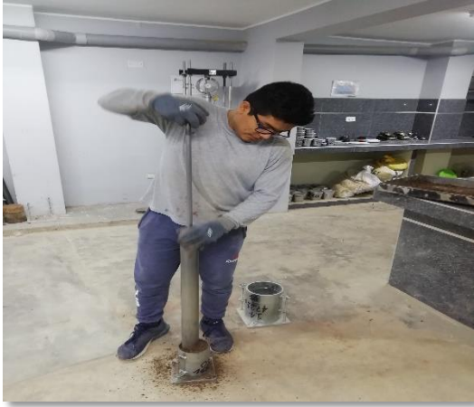
Figura 52. Compactacion en 5 capas
