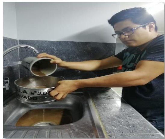
Figura 43. Lavado del suelo por tamiz N° 200
