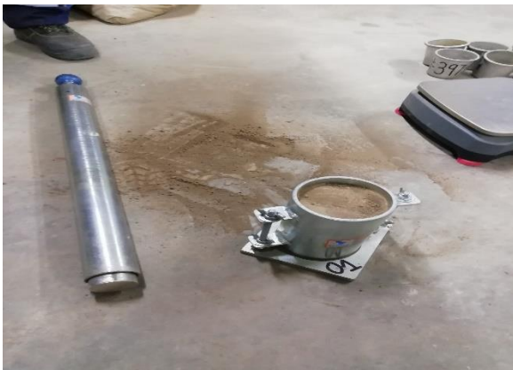
Figura 48. Pison y molde de compactacion proctor
