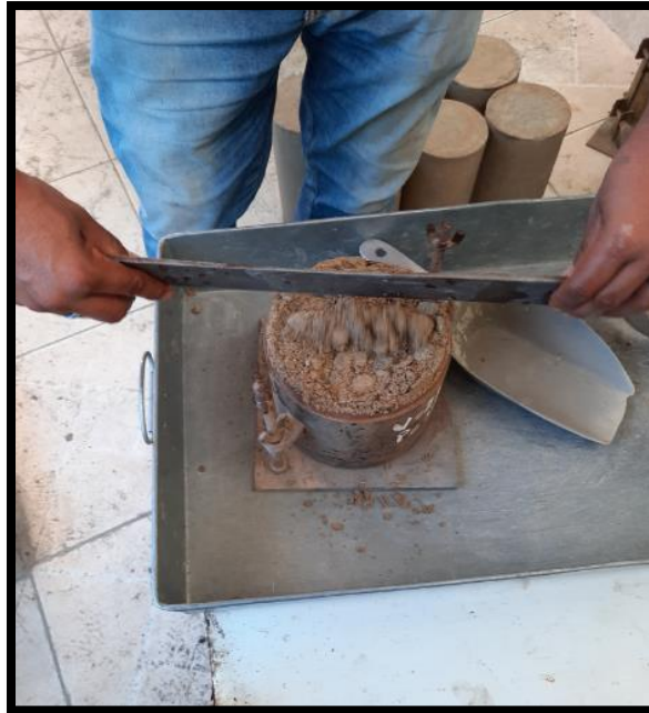
Figura 7. Ensayo de Proctor modificado
