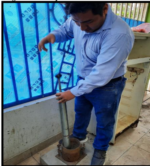
Figura 8. Ensayo de Proctor modificado
