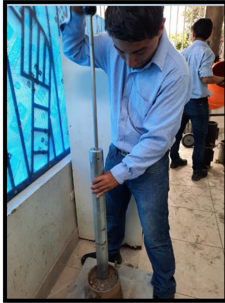
Figura 9. Ensayo de Proctor modificado
