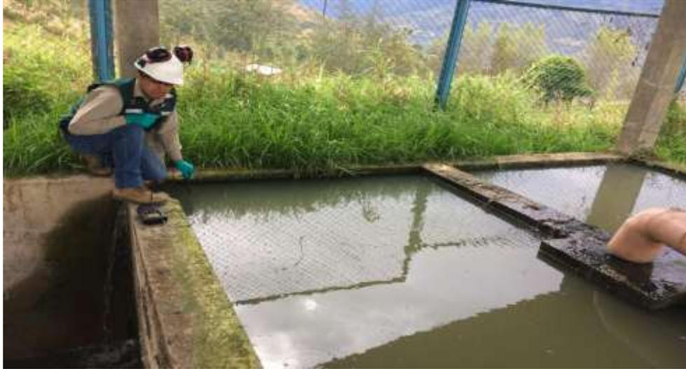
Fotografía N° 02: Instalación de vasos para realizar la prueba de jarras
