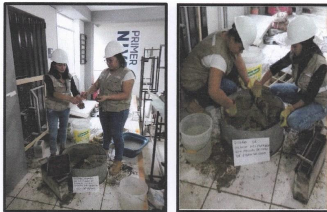
Fotografía 23 y 24: Esparcimiento de la fibra de coco sobre la mezcla de concreto para proceder a realizar una mezcla uniforme y consolidada.
