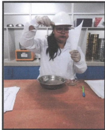
Fotografía 41 y 42: Determinación del peso específico con la bomba de vacío y el peso de la fiola + el peso de la arena + el peso del agua.
