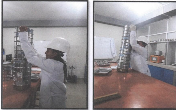
Fotografía 31 y 32: Ensayo de granulometría de los diferentes agregados fino y grueso con la norma técnica NTP 339.128. (ASTM D 4318): Proceso de tamizado para determinar el módulo de finura NTP 339.128. (ASTM D 4318).
