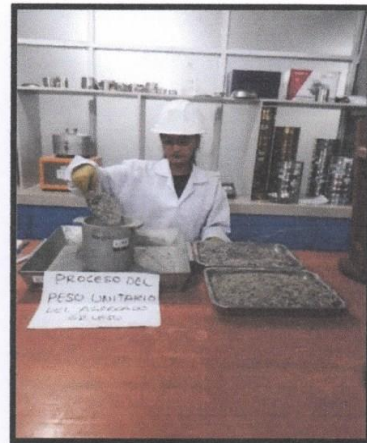
Fotografía 52 y 53: Ensayo del peso unitario del agregado grueso con la Norma Técnica NTP 400.017: Peso del molde y colocación del agregado grueso.
