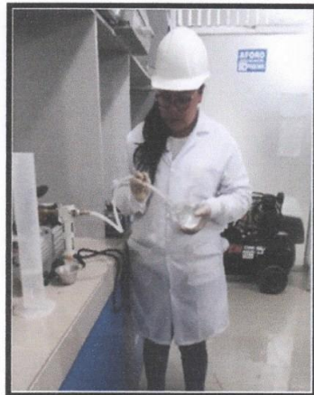
Fotografía 37 y 38: Proceso de desaireación del agua con la bomba de vacío y pesado fiola + agua.
