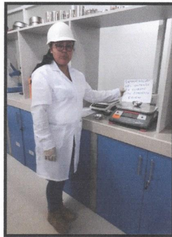
Fotografía 14 y 15: Proceso del ensayo del contenido de humedad del agregado grueso con la Norma Técnica Peruana” NTP 339.127 (ASTM D 2216).
