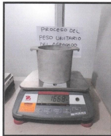
Fotografía 52 y 53: Ensayo del peso unitario del agregado grueso con la Norma Técnica NTP 400.017: Peso del molde y colocación del agregado grueso.
