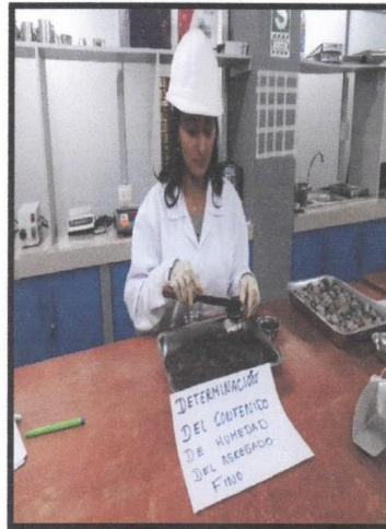
Fotografía 11 y 12: Proceso del llenado del material a las taras para el ensayo del contenido de humedad del agregado fino de la cantera Fepeca NTP 339.127 (ASTM D 2216).
