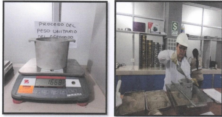
Fotografía 46 y 47: Proceso de enrase del agregado fino y pesaje en estado suelto (molde + arena).
