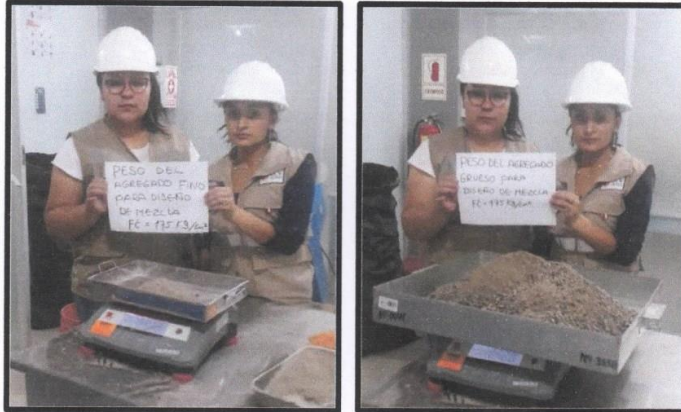
Fotografía 1 y 2: Se inicia con el pesaje de los materiales agregado fino y grueso en kg para dosificación de 3 bloques de concreto (arena gruesa, confitillo). Observar tabla 2.
