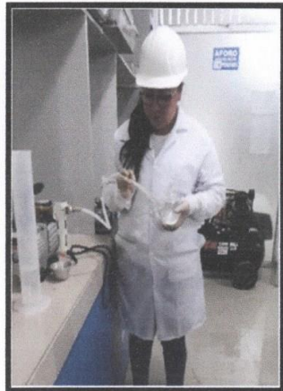
Fotografía 82 y 83: Proceso de desaireación del agua con la bomba de vacío
