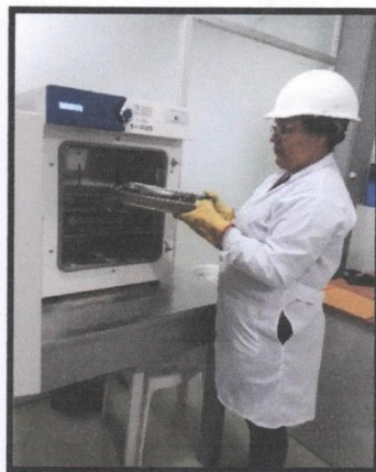
Fotografía 29 y 30: Proceso de secado del agregado fino y grueso con una temperatura de 110°C durante 24 horas.
