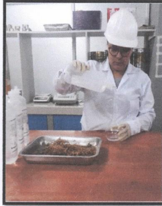
Fotografía 80 y 81: Ensayo del peso específico de la fibra de coco: Peso y puesto en agua en la fiola.
