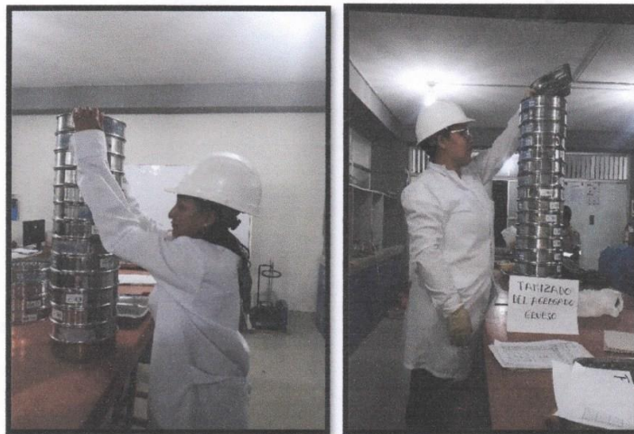
Fotografía 33 y 34: Proceso de tamizado con la Norma Técnica NTP 339.128. (ASTM D 4318).
