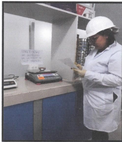
Fotografía 64: Ensayo de contenido de humedad en estado húmedo.
