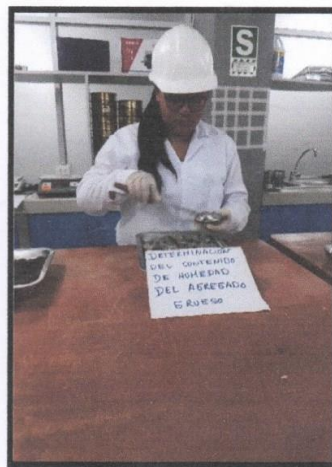
Fotografía 14 y 15: Proceso del ensayo del contenido de humedad del agregado grueso con la Norma Técnica Peruana” NTP 339.127 (ASTM D 2216).
