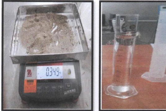
Fotografía 21 y 22: Se pesa 0.35 kg de arena gruesa para la mezcla de 3 bloques de concreto. Cemento, confitillo y agua es la misma dosificación que para los bloques de concreto convencionales. Observar la tabla 2.
