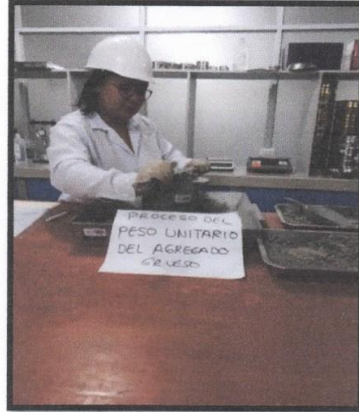
Fotografía 58 y 59: Proceso de enrase del agregado grueso y el pesado, en estado compactado (molde + confitillo).
