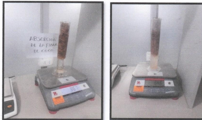
Fotografía 70 y 71: Ensayo de absorción de la fibra de coco y proceso de peso de (probeta + agua + fibra de coco).
