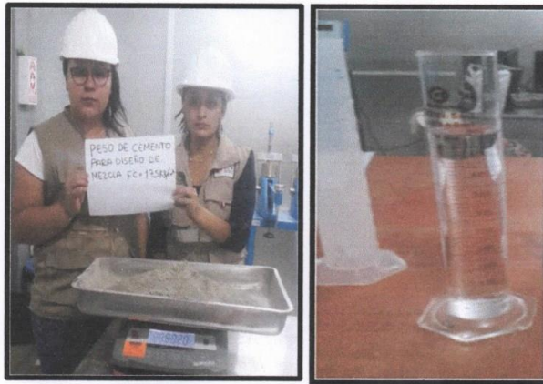
Fotografía 3 y 4: Se continúa pesando el cemento en kg y se mide la cantidad de agua potable en Lts a utilizar en la mezcla, como se observa en la tabla 2.
