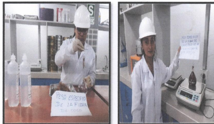
Fotografía 86 y 87: Determinación del peso específico con la bomba de vacío y el peso de la fiola + el peso de la fibra de coco + el peso del agua.
