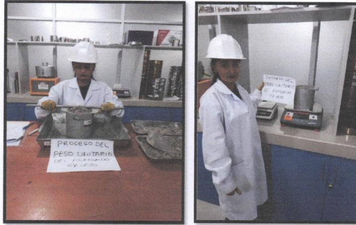
Fotografía 54 y 55: Proceso de enrase del agregado grueso y el pesado, en estado suelto (molde + arena).
