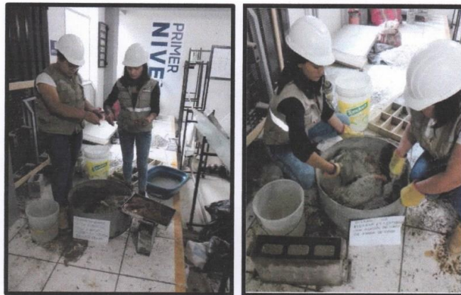
Fotografía 31 y 32: Esparcimiento de la fibra de coco sobre la mezcla de concreto para proceder a realizar una mezcla uniforme y consolidada.
