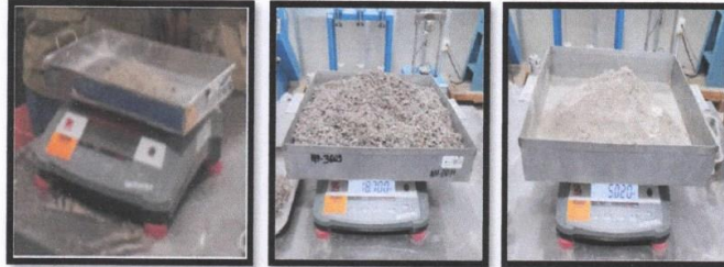
Fotografía 29 y 30: Se continua con el pesaje de los materiales agregado fino en cantidad de 0.33 kg, fibra de coco 0.08 kg, confitillo 18.70 kg, cemento 5.02 kg y agua 2.70 Lts. Observar la tabla 2.
