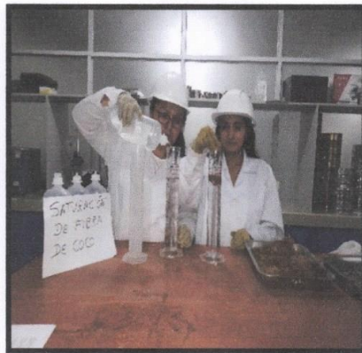
Fotografía 67: Proceso de la colocación del agua destilado y la fibra de coco en la probeta de 500 ml.
