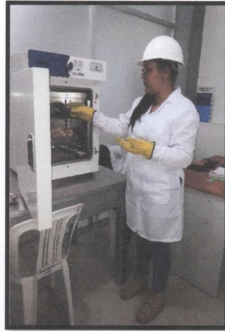
Fotografía 16: Proceso de pesado y secado del agregado grueso a una temperatura de 110°C.
