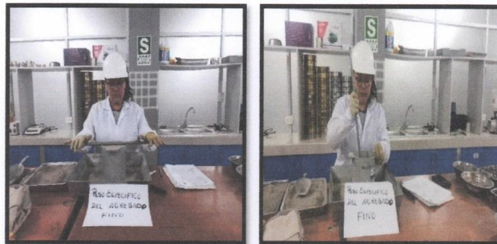
Fotografía 46 y 47: Proceso de enrase del agregado fino y pesaje en estado suelto (molde + arena).
