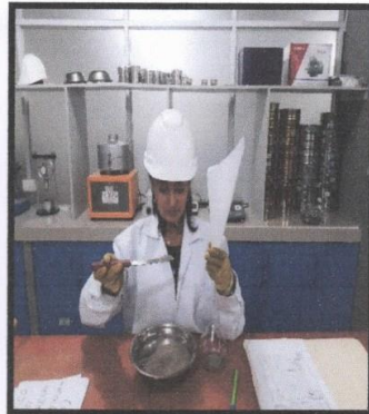
Fotografía 39 y 40: Ensayo del peso específico del agregado fino con la norma técnica NTP 339.131. (ASTM D 854): Peso de la arena y colocado en la fiola para el proceso de desaireación del agregado
