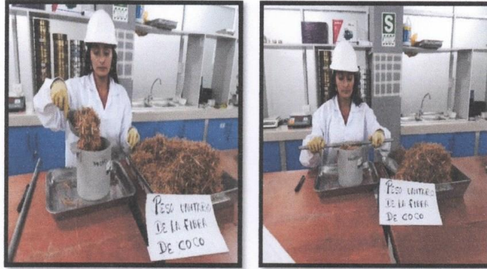
Fotografía 76 y 77: Colocación de la fibra de coco en el molde y el proceso de enrase, compactado en estado suelto.
