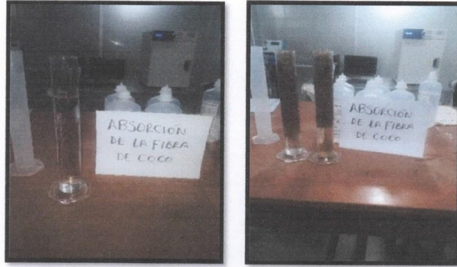
Fotografía 68 y 69: Ensayo de absorción de la fibra de coco sumergida en agua destilada en una probeta de 500 ml.
