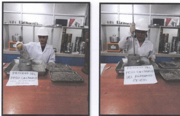
Fotografía 56 y 57: Ensayo del peso unitario del agregado grueso con la Norma Técnica NTP 400.017: Colocación del agregado grueso en el molde y compactación del agregado grueso.
