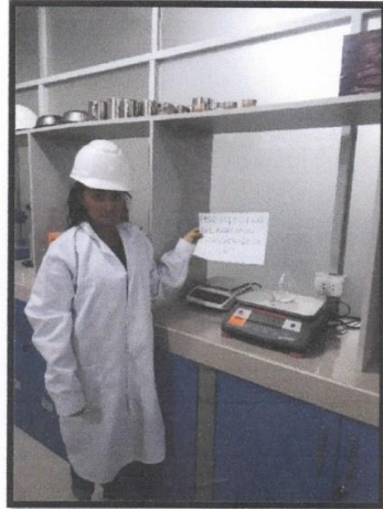
Fotografía 35 y 36: Ensayo del peso específico del agregado fino con la Norma Técnica NTP 339.131. (ASTM D 854): Peso y puesta de agua en la fiola.
