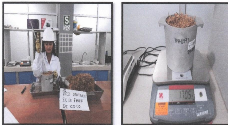
Fotografía 78 y 7: Colocación de la fibra de coco en el molde y el proceso de enrase, compactado en estado suelto.
