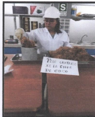
Fotografía 72 y 73: Ensayo de peso unitario de la fibra de coco: Proceso de peso del molde y colocación de la fibra de coco.
