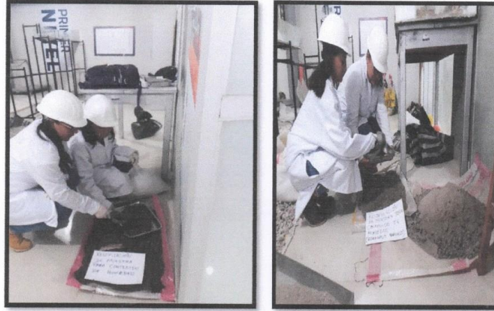
Fotografía 05 y 06: Proceso de recopilación del agregado fino y agregado grueso para el ensayo del contenido de humedad.
