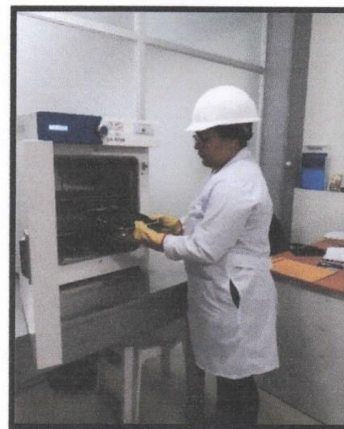
Fotografía 29 y 30: Proceso de secado del agregado fino y grueso con una temperatura de 110°C durante 24 horas.
