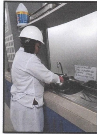
Fotografía 27 y 28: Proceso de lavado del agregado grueso de la cantera fepeca: Proceso de lavado del agregado grueso por las mallas N° 200 y N° 4.
