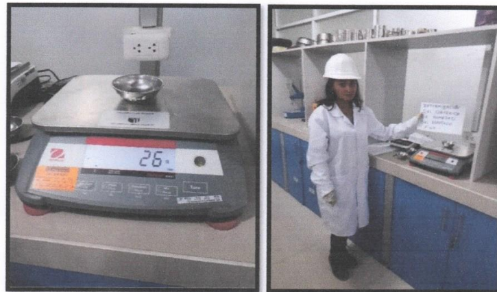
Fotografía 07 y 08: Proceso del ensayo de contenido de humedad, agregado fino con la norma técnica NTP 339.127 (ASTM D 2216): Peso de las taras para el ensayo del contenido de humedad del agregado fino
