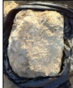
Figura 120. Extracción de muestra inalterada - Calicata 02 - Reservoirio
