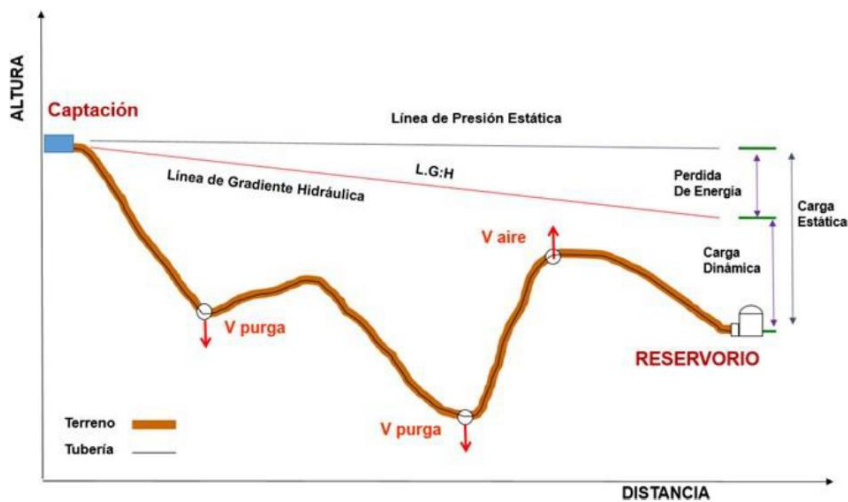
Figura 7. Línea de conducción
