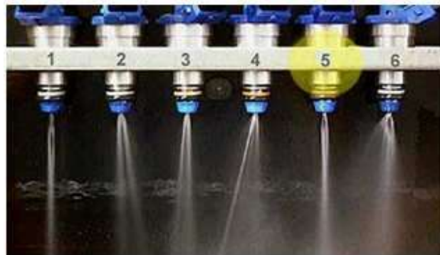
Figura 8. Observación de la pulverización de los inyectores
