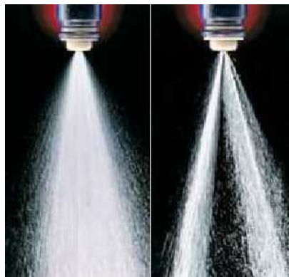
Figura 6. Buena atomización y mala atomización de combustible
