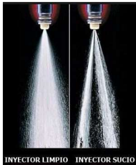
Figura 22. Forma de pulverización del inyector
