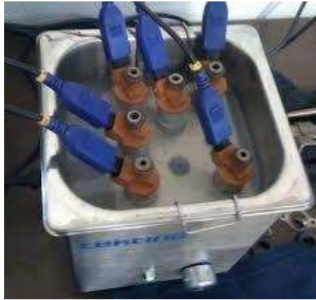
Figura 9. Limpieza a ultrasonido de inyectores
