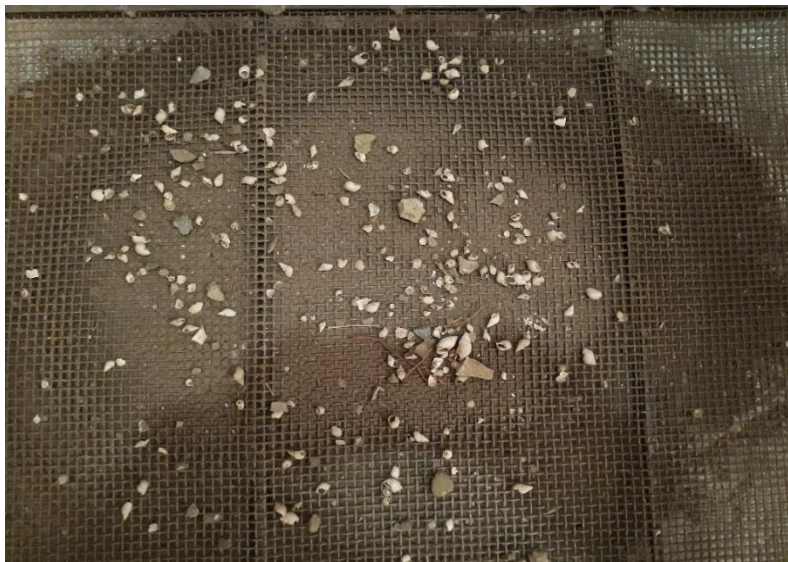
Figura 2. Presencia de conchas de mar en la muestra de la calicata N°1 y 2
