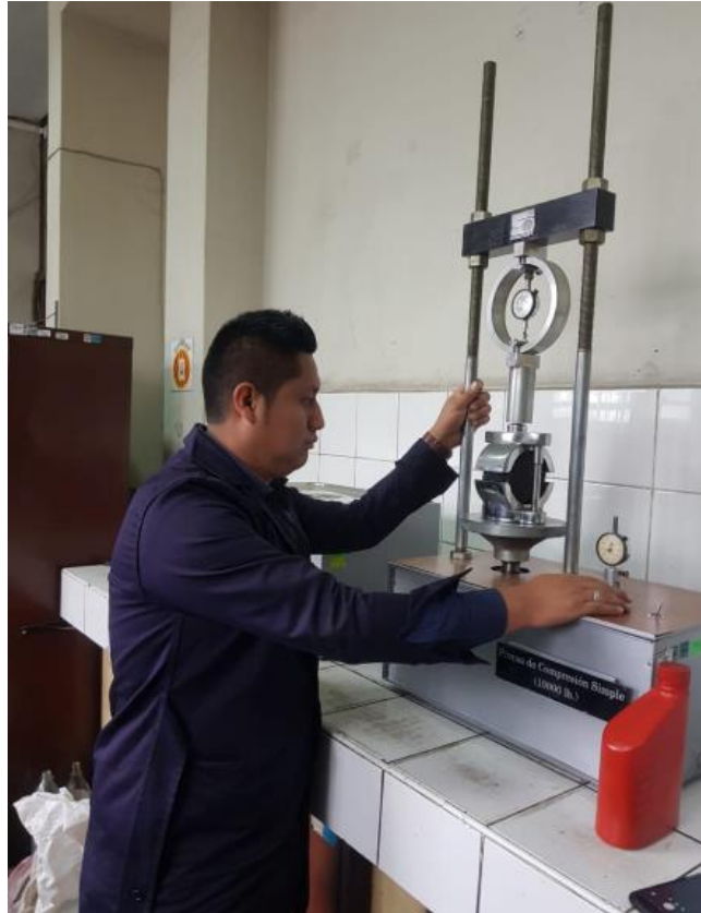
Figura 40 Aplicando compresión diametral a la briqueta convencional en la maquina marshall
