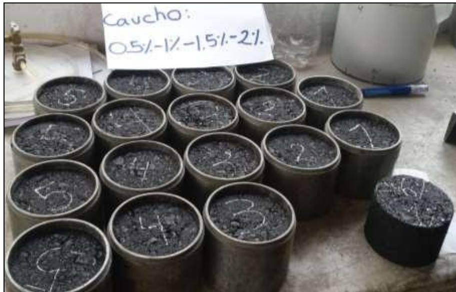
Figura 45 Probetas de mezcla asfáltica modificada a temperatura de 140°C. Fuente: Resultado de la Investigación
