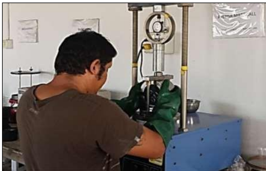
Figura 46 Ensayo Marshall de la mezcla asfáltica modificada con caucho. Fuente: Resultado de la Investigación
