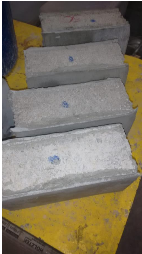
Figura 30. Bloques de concreto con neumáticos reciclados apilados
