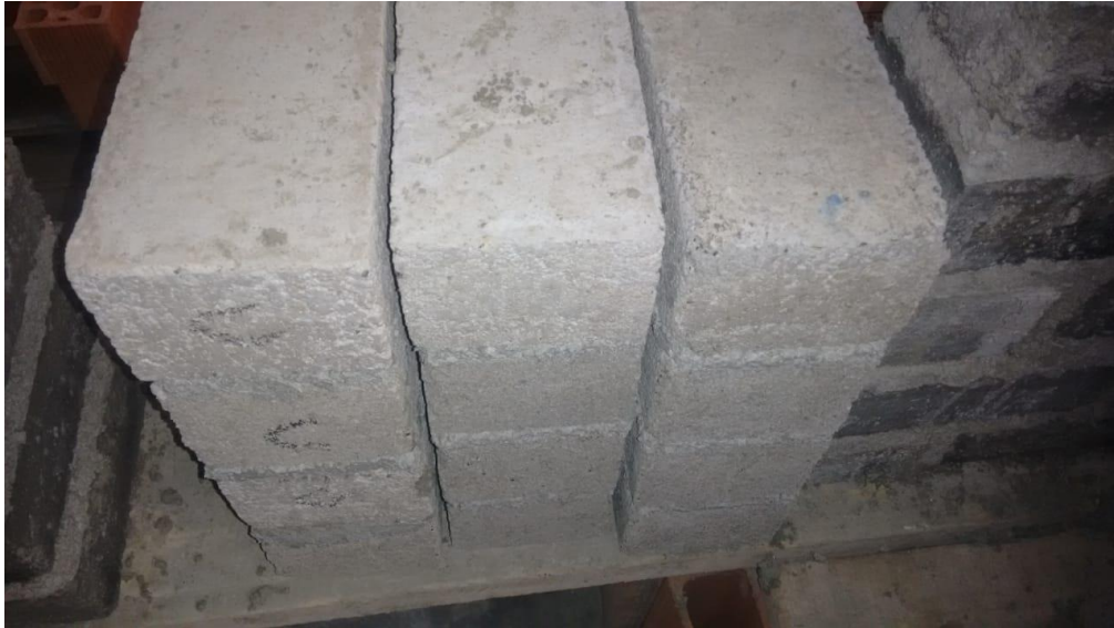
Figura 39. Pilas con bloques de concreto con neumáticos al 5%, 9% y 16%
