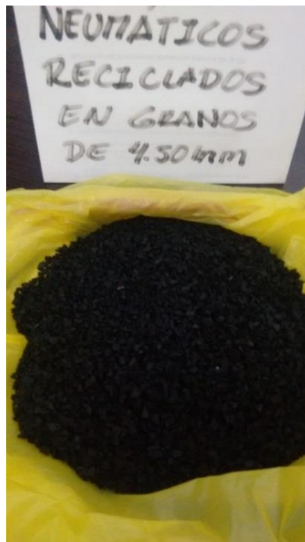
Figura 29. Muestra de neumáticos reciclados triturado a 4.50mm
