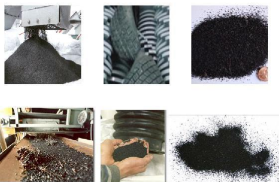
Figura 13. Obtención de fibras de neumáticos reciclados
