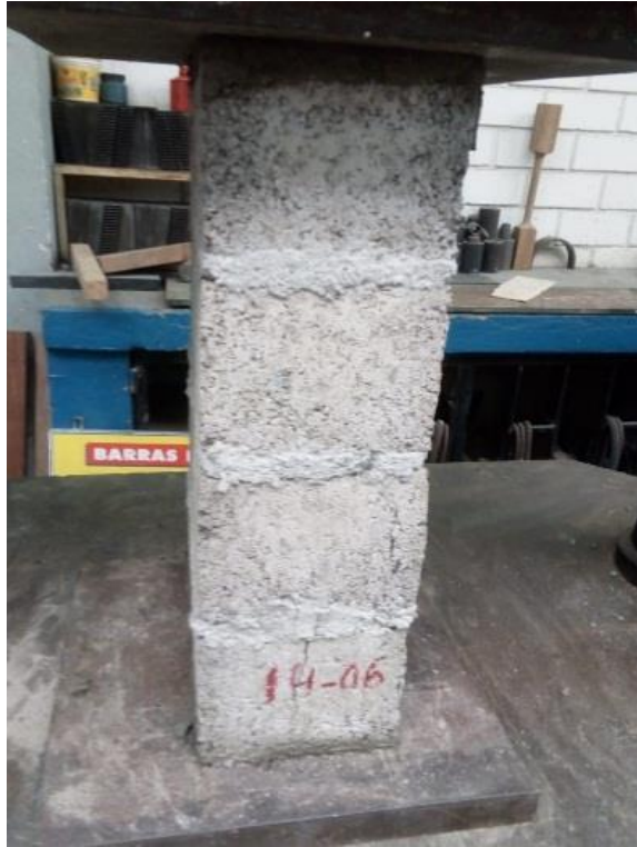
Figura 40. Ensayo a compresión de pilas
