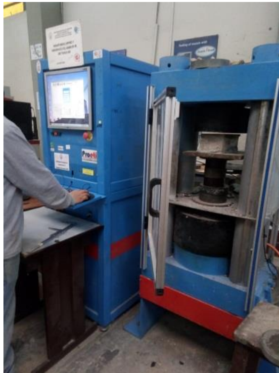
Figura 31. Ensayo a compresión de los bloques
