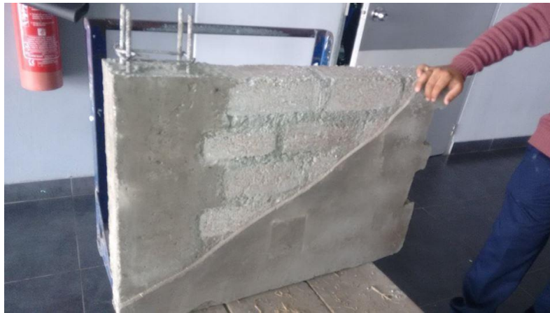
Figura 18. Murete de albañilería confinada con el uso de bloques de concreto con plásticos reciclados
