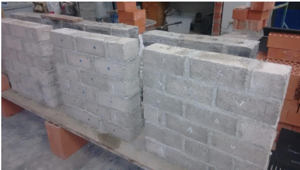
Figura 38. Murete con bloques de concreto con neumáticos al 5%, 9% y 16%
