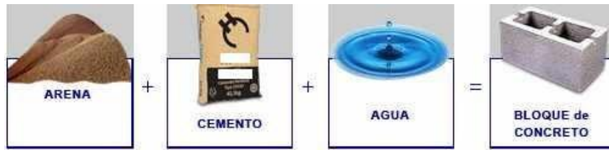
Figura 8. Componentes de un Bloque de Concreto
