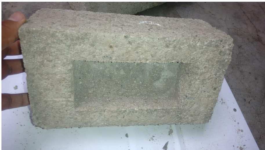
Figura 33. Bloque de concreto con neumáticos reciclados
