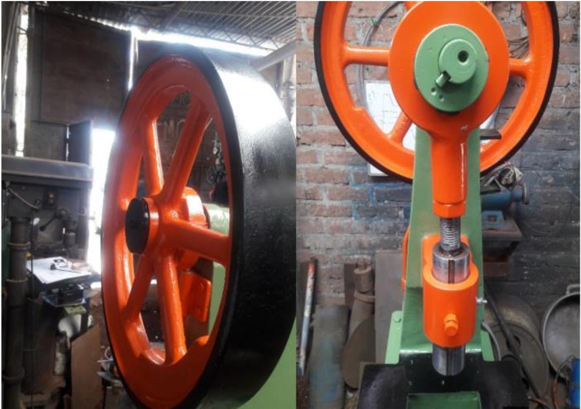
Figura 23. Volante de inercia.
