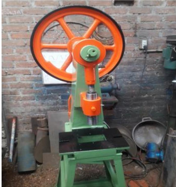
**Figura 15. Ensamblado final de la prensa excéntrica.**
