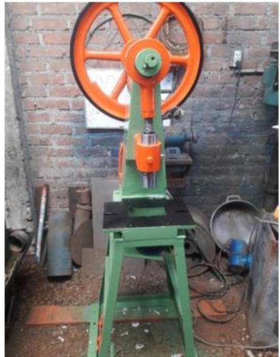
Figura 22. Diseño de prensa excéntrica.
