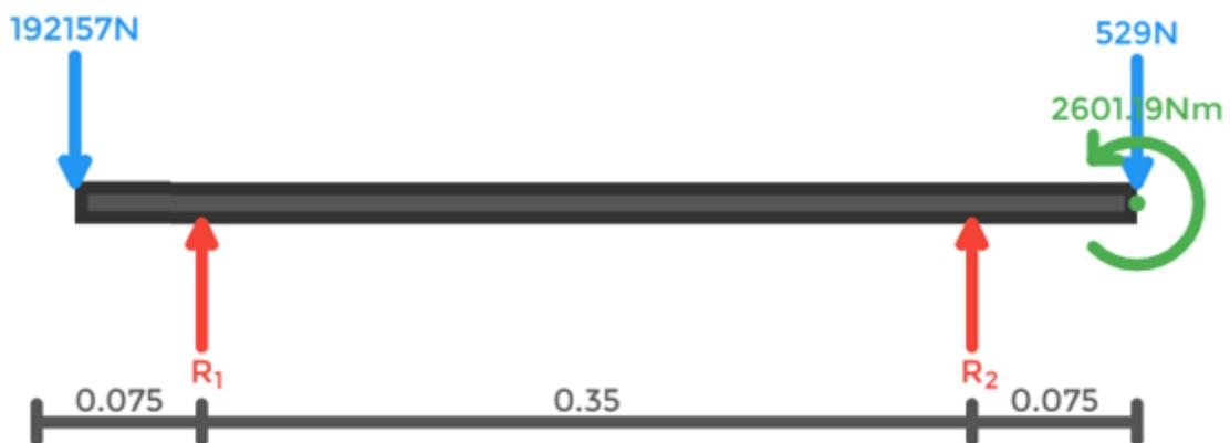
Figura 9. Análisis estático del eje
