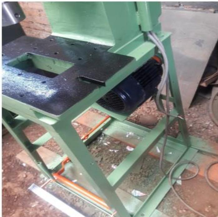
**Figura 16. Prensa excéntrica parte inferior.**
