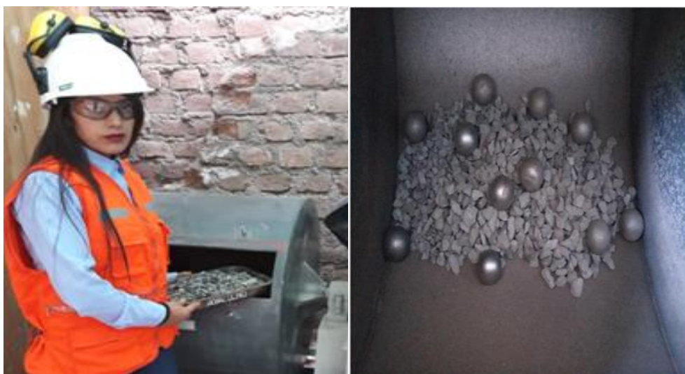
Figura 18: Abrasión los Ángeles de agregado grueso.
