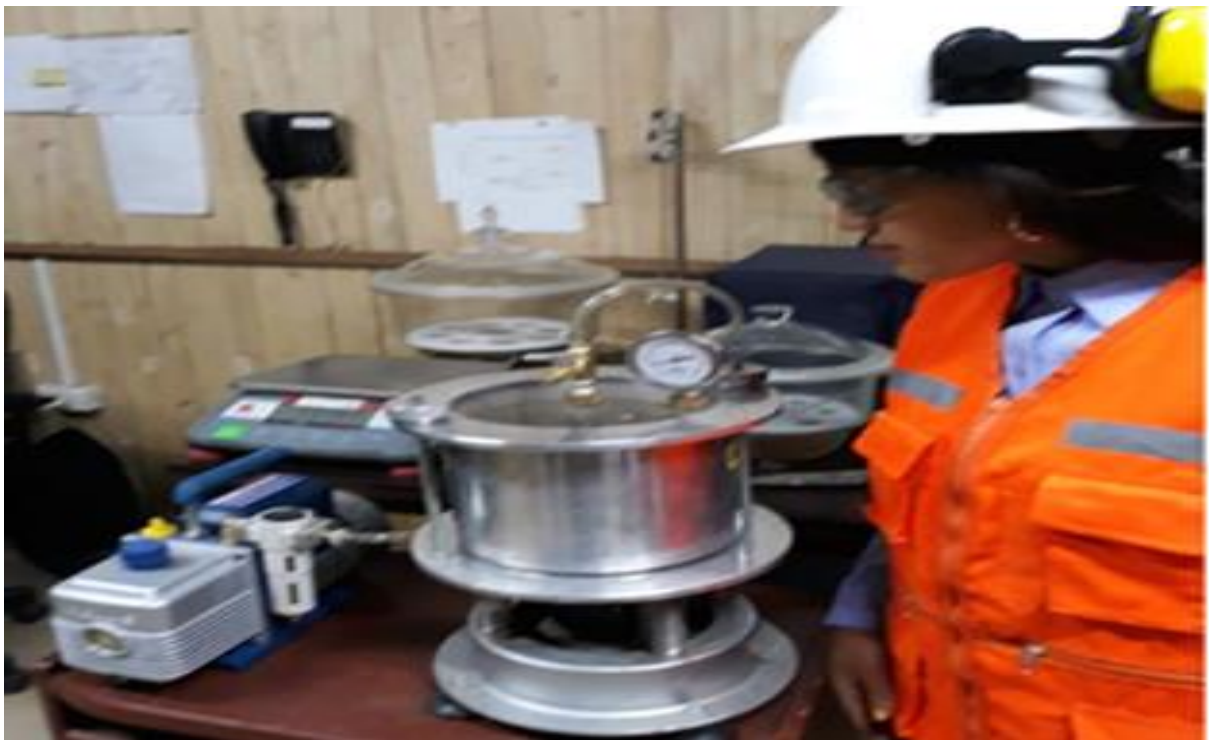
Figura 40: Realizando el ensayo de Peso específico máximo teórico (Rice) ASTM D2041, a CA.
