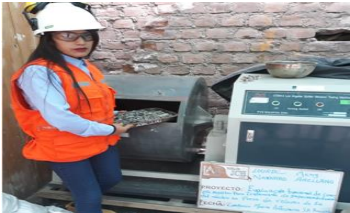
Figura 38: Realizando el ensayo de Abrasión los Ángeles ASTM C 131, para grava.
