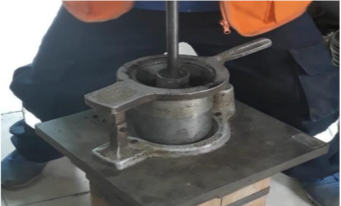
Figura 39: Compactaciones de briquetas según Marshall ASTM D 6926., para 6.7%, 7% y 7.3% de CA.
