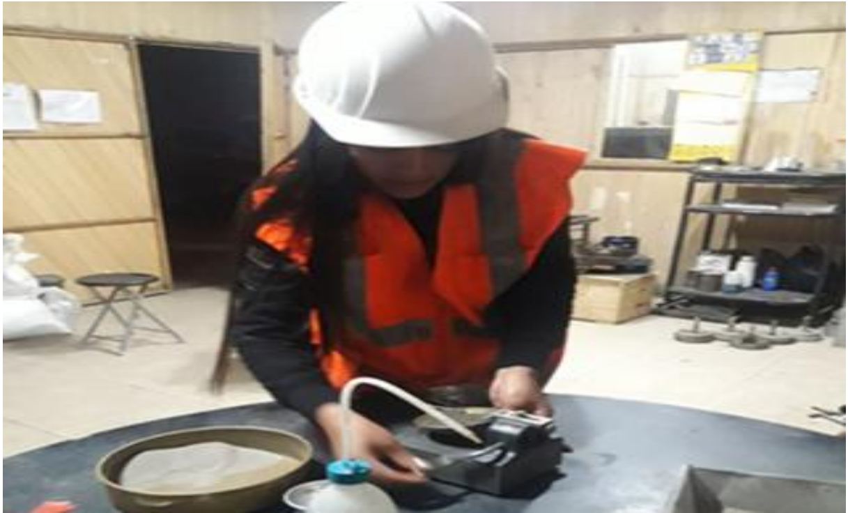
Figura 35: Realizando el ensayo de Índice de plasticidad ASTM D 4318, para arena.
