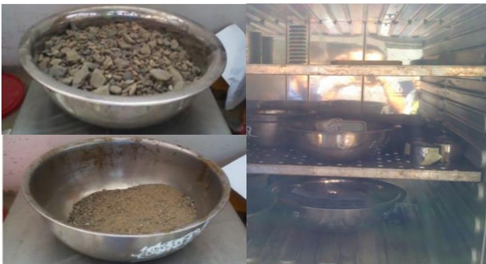
Figura 16: Contenido de humedad de agregado grueso y fino.
