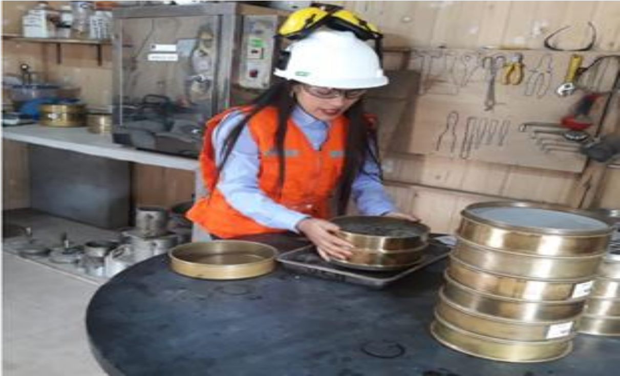
Figura 33: Realizando el ensayo de Análisis granulométrico ASTM C136, para grava, gravilla y arena.
