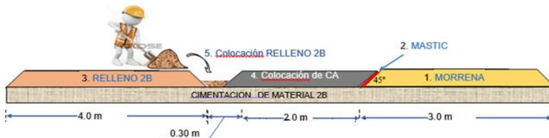
Figura 25: Relleno de zanja.
