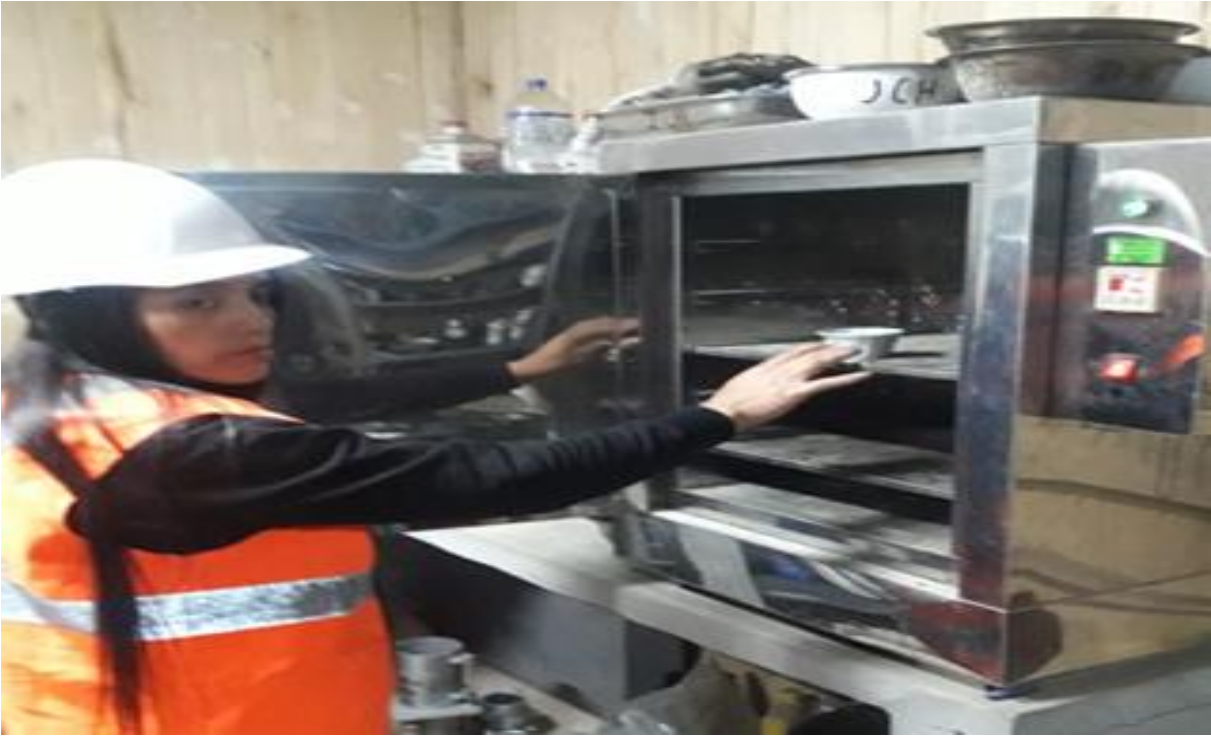
Figura 34: Realizando el ensayo de contenido de humedad ASTM D 2216, para grava y arena.
