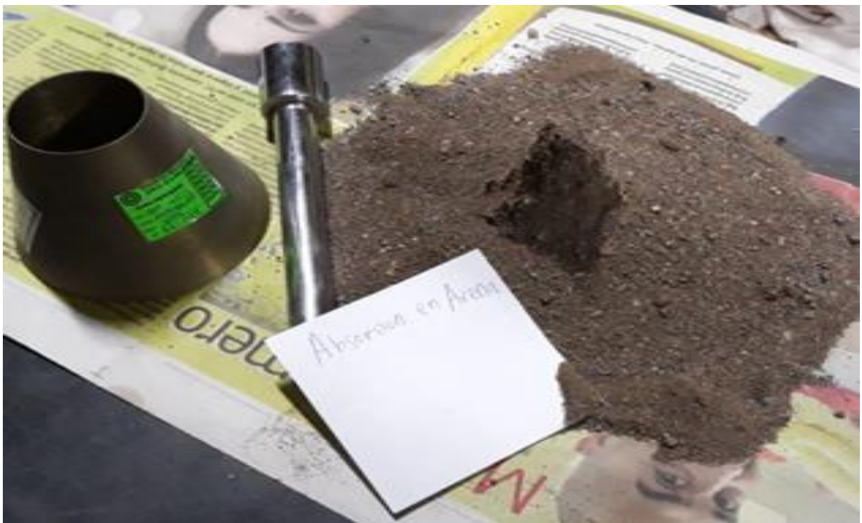
Figura 36: Realizando el ensayo de Absorción ASTM C 128, para arena.
