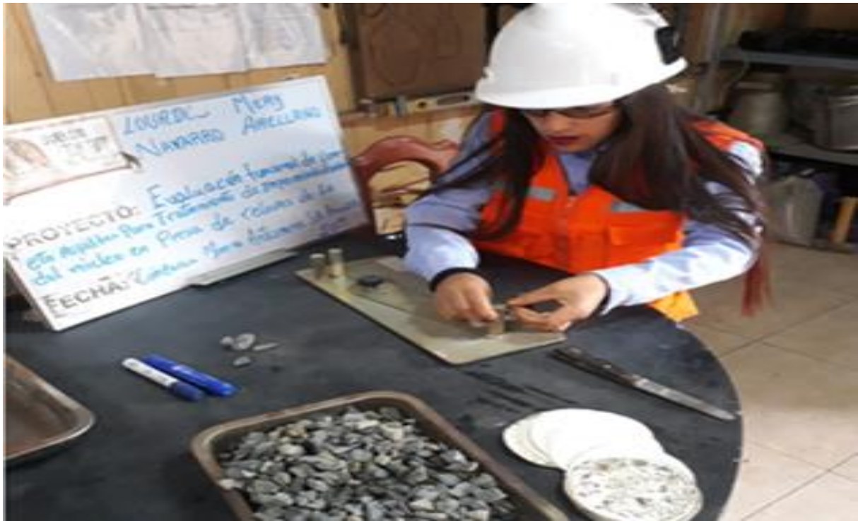
Figura 37: Realizando el ensayo de Partículas chatas y alargadas ASTM D 4791, para grava.
