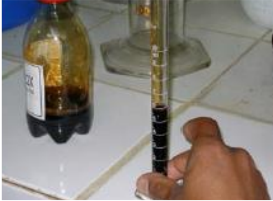
FOTO 06: Se observa el aditivo Topsoil para efectuar el ensayo CBR
