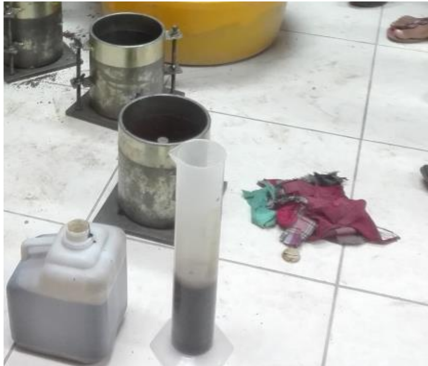
FOTO 06: Se observa el aditivo Topsoil para efectuar el ensayo CBR
