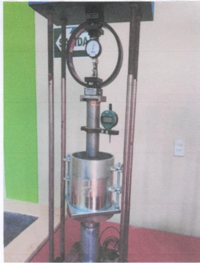
Foto.- Se aprecia la penetración del espécimen para determinar el CBR de la muestra patrón.
