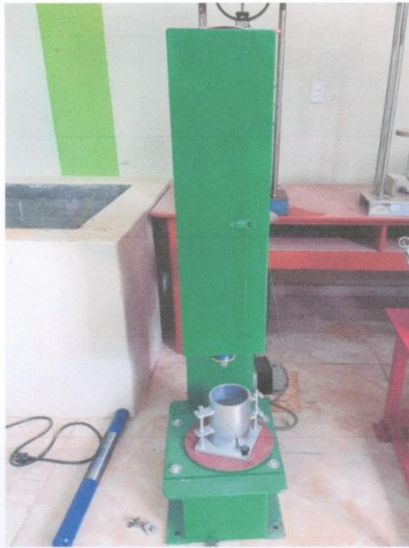
Foto.- Se aprecia el equipo de compactación automática utilizada para el ensayo de proctor y CBR.
