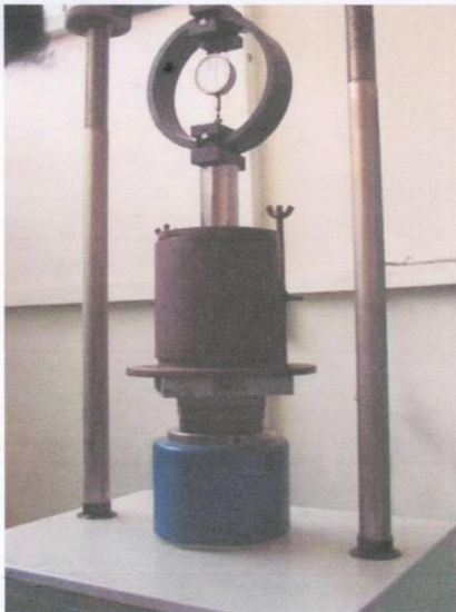
Foto.- Se aprecia la penetración del espécimen para determinar el CBR de la muestra con óptimo contenido de aditivo.
