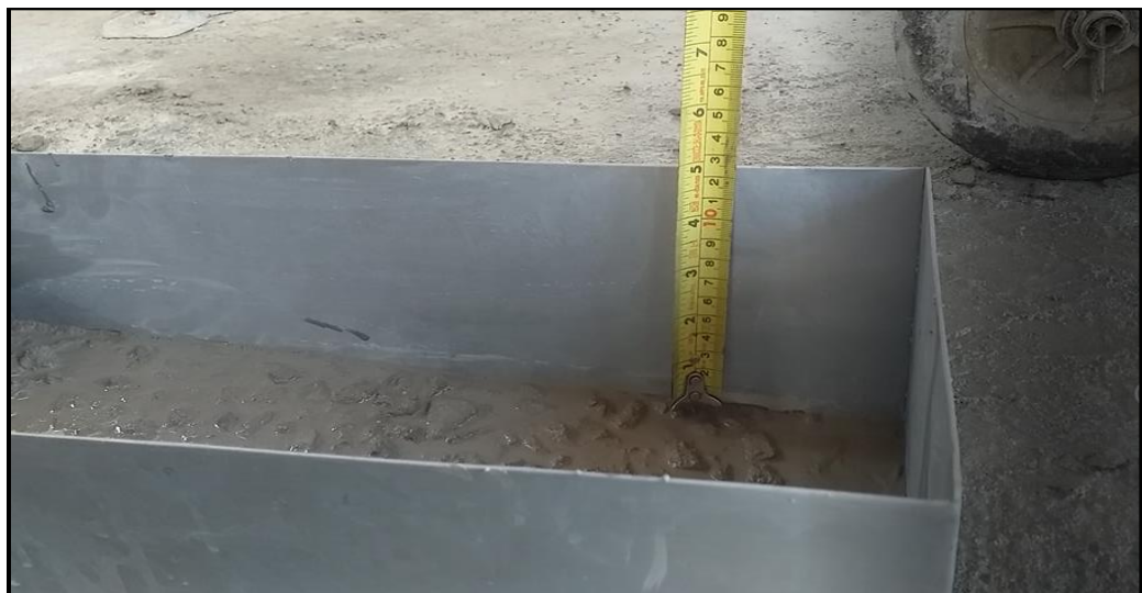
Fotografía 85. Medida para sacar la altura h_2 , grupo al 10% de adición – ensayo caja L.
