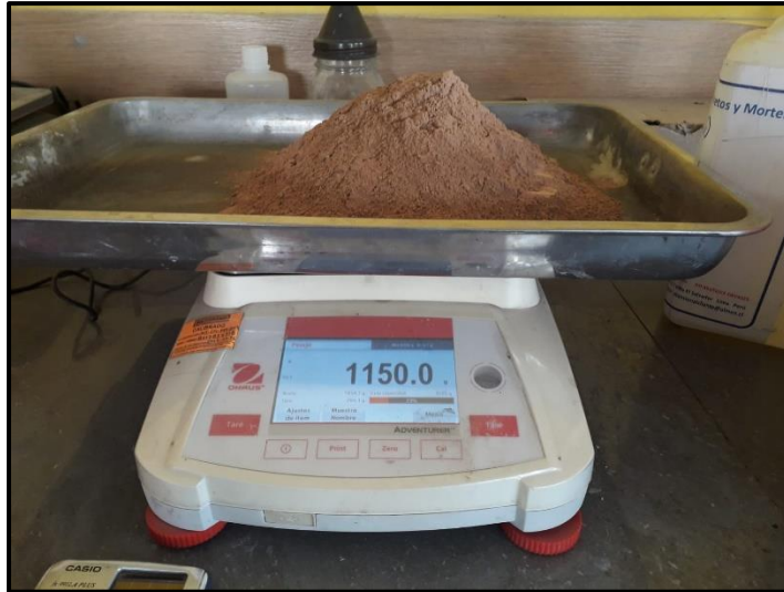
Figura 47. 1.150 kg de adición, arcilla tamizada por la malla 200, representa el 10 % del peso del cemento.
