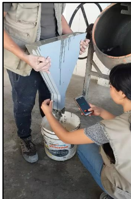
Fotografía 70. Ensayo de Funnel V, se inicia la descarga y simultáneamente se inicia a tomar el tiempo.
