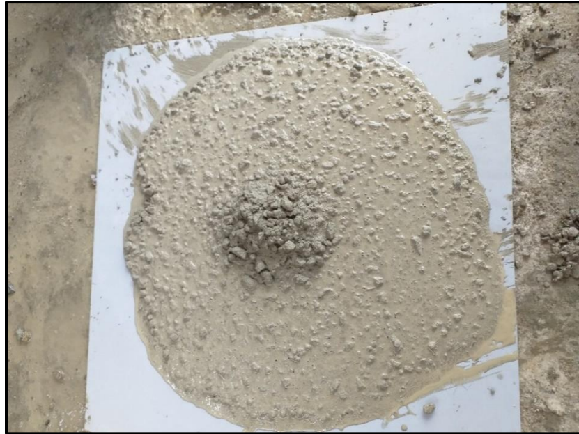
Figura 33. Mezcla con presencia de una relación no adecuada de agregados. Diseño fallido 3.
