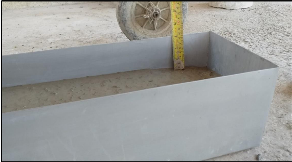
Fotografía 82. Medida para sacar la altura h_2 , grupo al 5% de adición – ensayo caja L.
