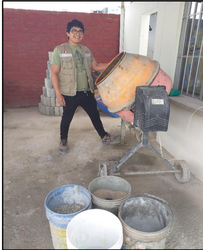
Figura 49. Materiales listos para realizar la tanda de 25 L.
