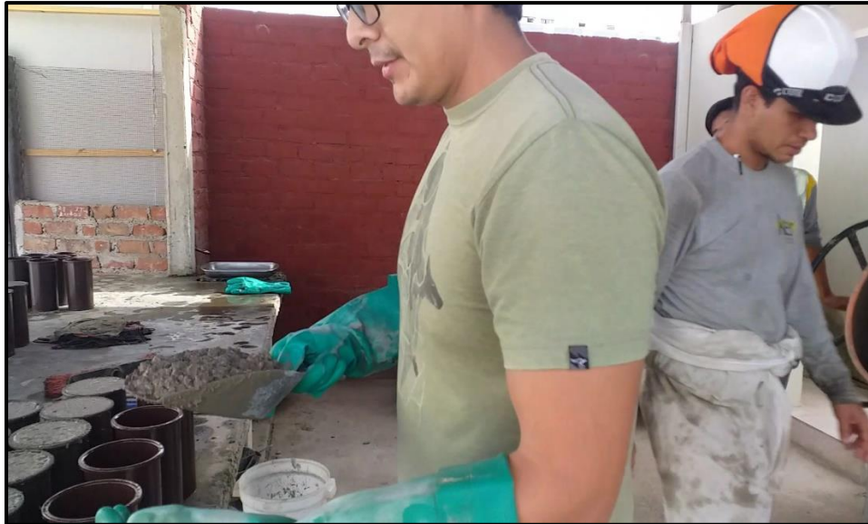
Fotografía 94. Llenado de probetas con mezcla de 10% y 15% de adición, no requiere compactación
