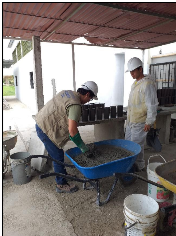
Fotografía 97. Elaboración de probetas, grupo patrón, al 5%, 10% y 15% para 7 días.
