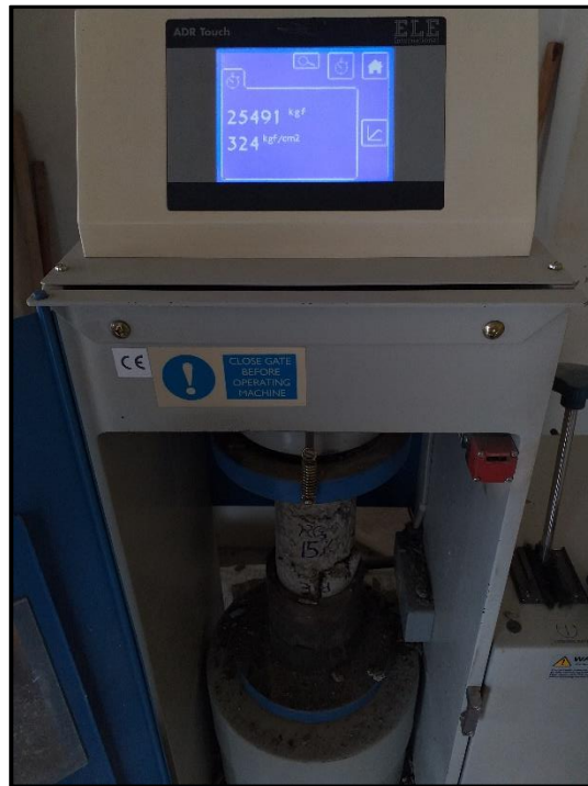
Fotografía 128. Ruptura de probetas grupo al 15% de adición 7 días.
