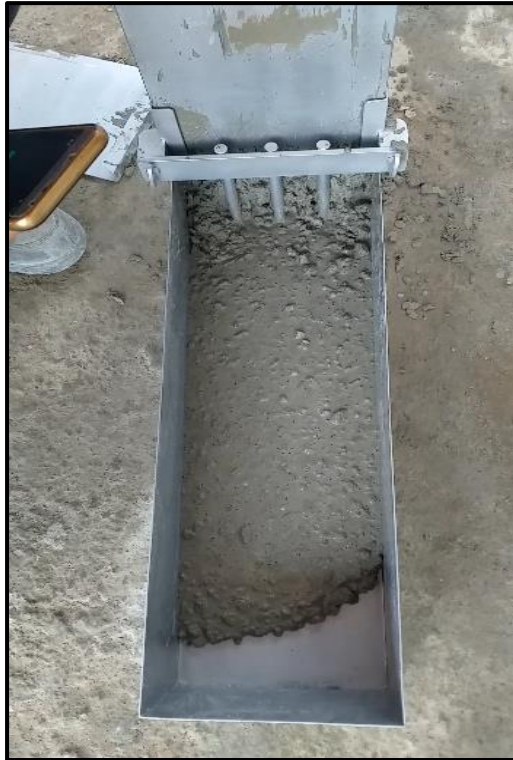
Fotografía 84. Ensayo de la capacidad de paso, caja L grupo al 10% de adición.
