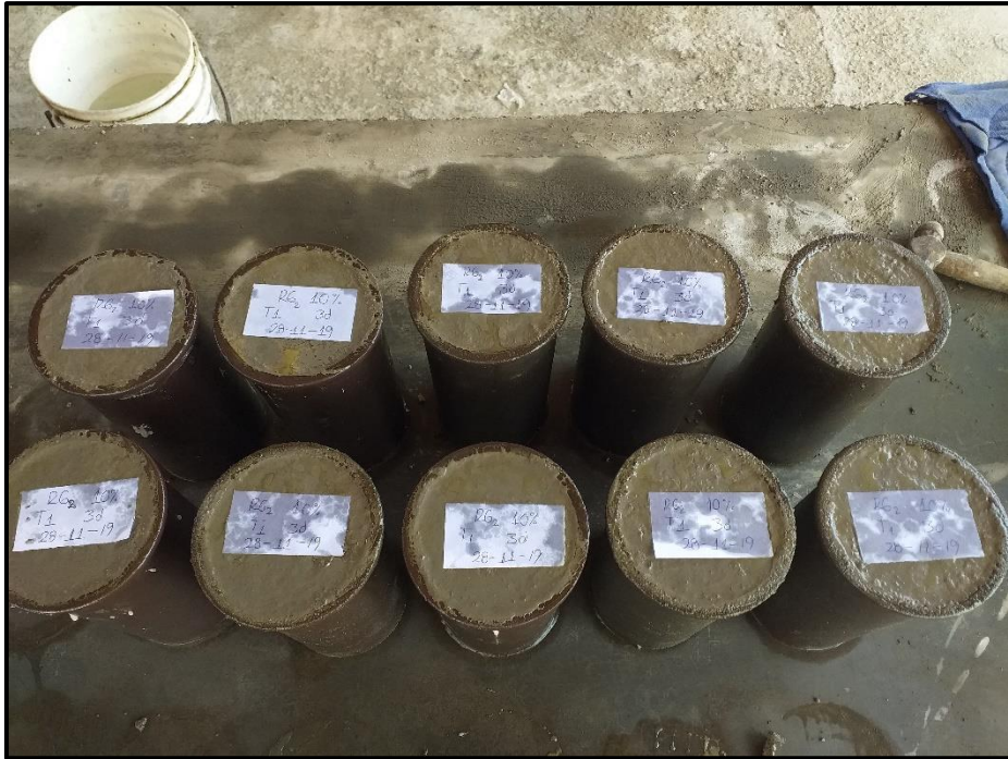
Fotografía 100. Elaboración de probetas, grupo al 10% para 3 días.
