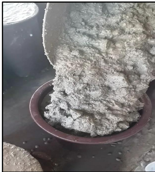
Fotografía 93. Consistencia de la mezcla patrón y al 5% de adición, no requiere compactación
