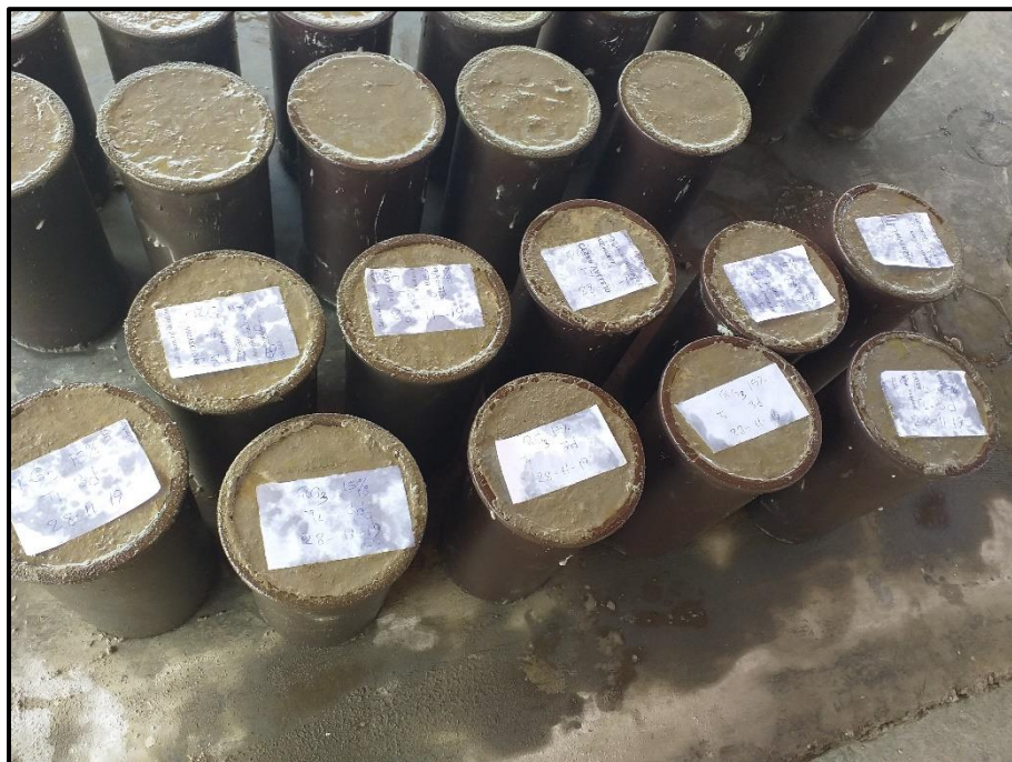
Fotografía 101. Elaboración de probetas, grupo al 15% para 3 días.
