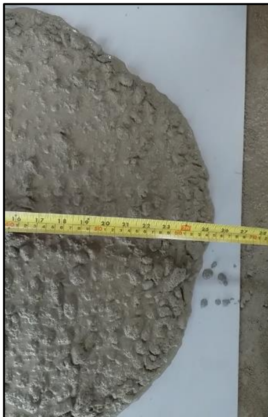
Figura 58. Ensayo de extensión de flujo del CAC grupo patrón.
