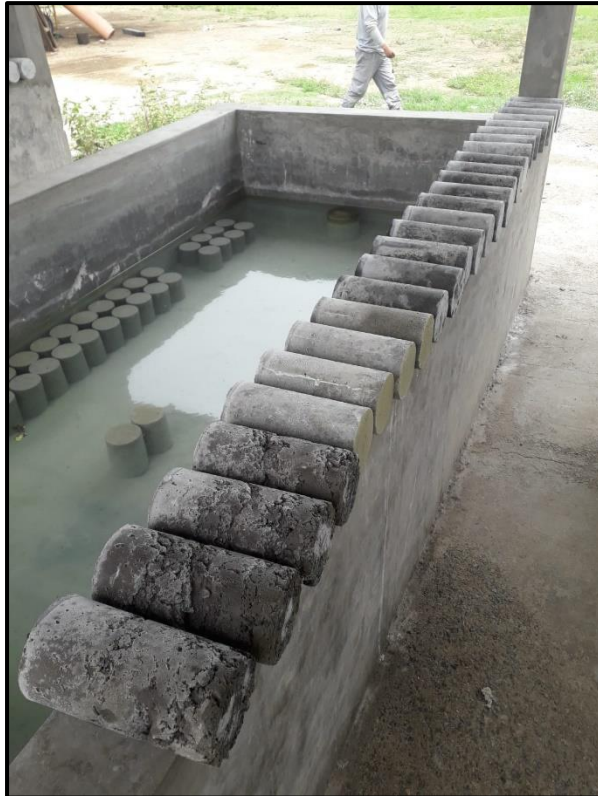
Fotografía 108. Extracción de probetas para realizar la rotura de las mismas
