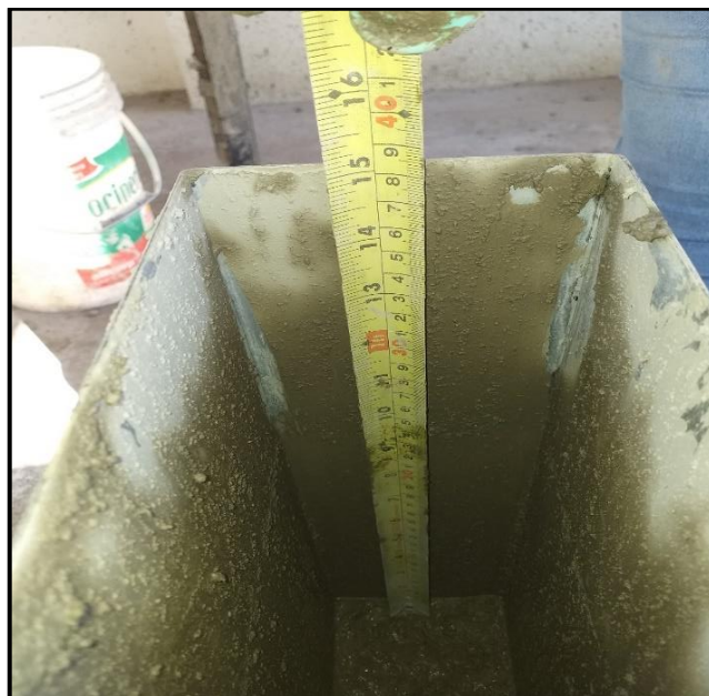
Fotografía 89. Medida para sacar la altura h_1 , grupo al 15% de adición – ensayo caja L.
