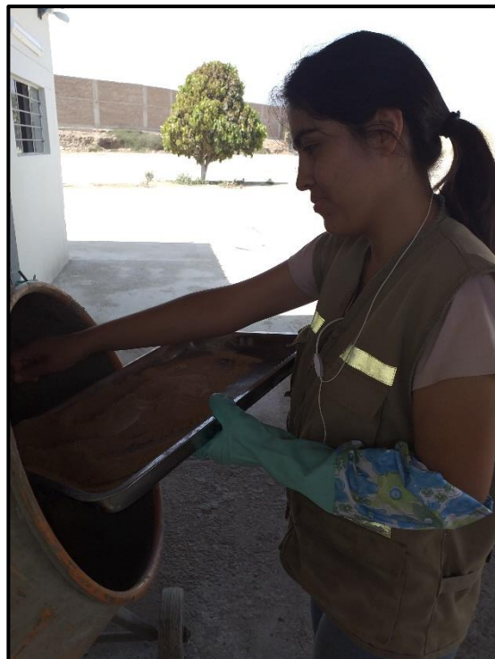
Figura 52. Vertido de adición a la mezcla.
