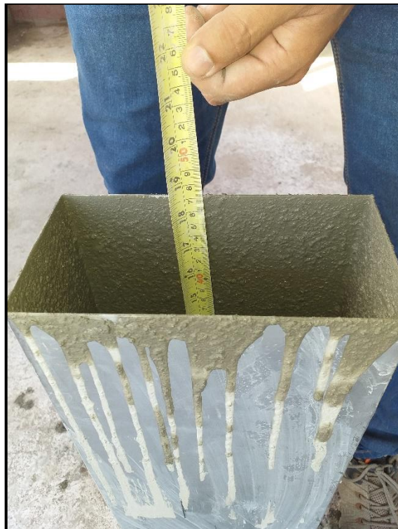
Fotografía 83. Medida para sacar la altura h_1 , grupo al 5% de adición – ensayo caja L.
