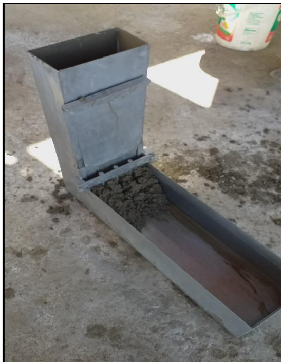
Fotografía 87. Ensayo de la capacidad de paso, caja L grupo al 15% de adición.
