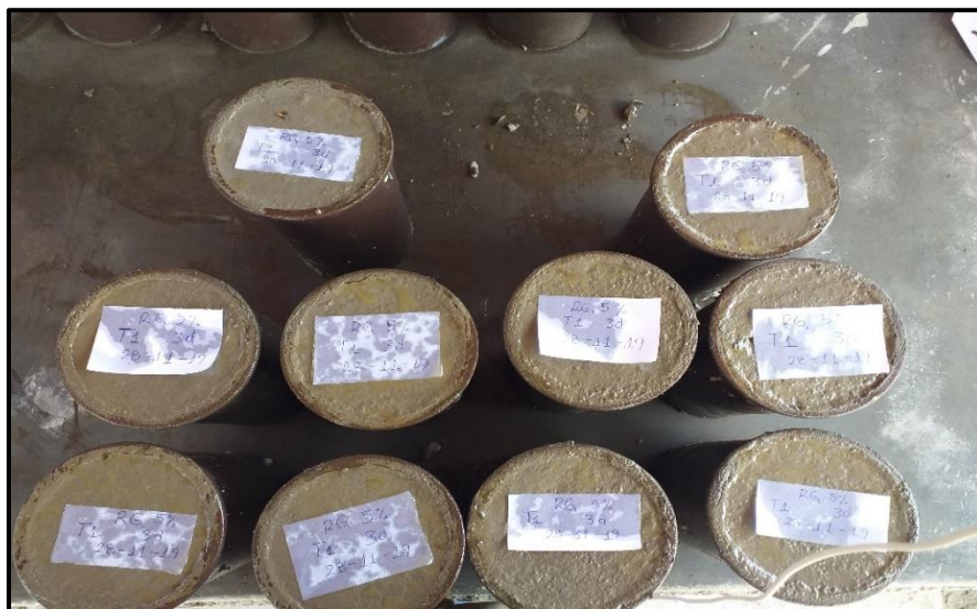
Fotografía 99. Elaboración de probetas, grupo al 5% para 3 días.
