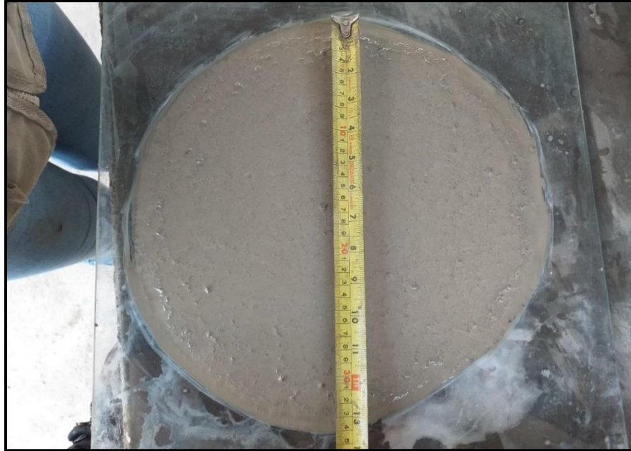
Figura 37. Ensayo de mini como, d_2 = 34 \text{ cm} . Ensayo con ajuste 01
