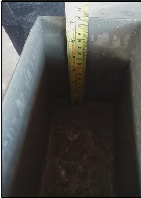
Fotografía 86. Medida para sacar la altura h_1 , grupo al 10% de adición – ensayo caja L.
