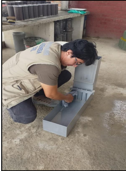
Fotografía 75. Humedecer la superficie del molde, ubicar en una superficie nivelada y cerrar las compuertas para su llenado.
