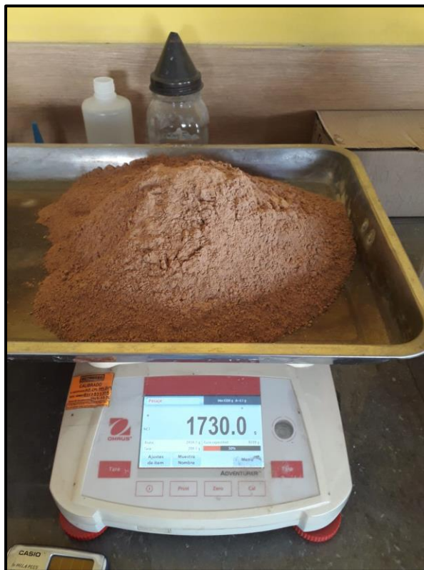
Figura 48. 1.725 kg de adición, arcilla tamizada por la malla 200, representa el 15 % del peso del cemento.
