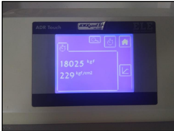
Fotografía 123. Ruptura de probetas grupo al 10% de adición 3 días.
