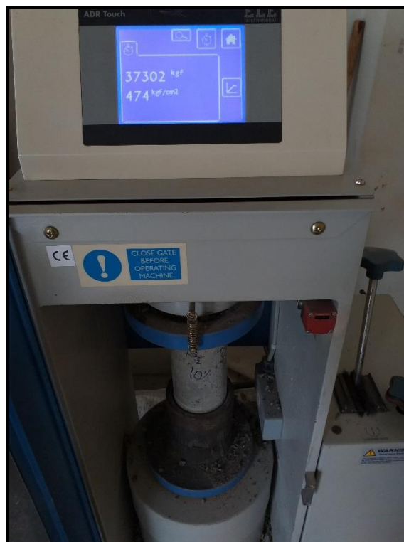
Fotografía 124. Ruptura de probetas grupo al 10% de adición 7 días.
