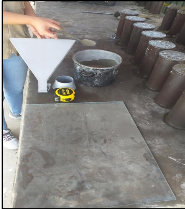
Figura 35. Ensayo de mini cono, para conocer la fluidez del mortero. Ensayo con ajuste 01
