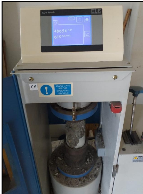
Fotografía 117. Ruptura de probetas grupo patrón 28 días.
