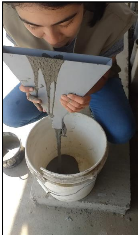
Figura 38. Ensayo de mini embudo V Funnel, para medir el tiempo de fluidez. Ensayo con ajuste 01.
