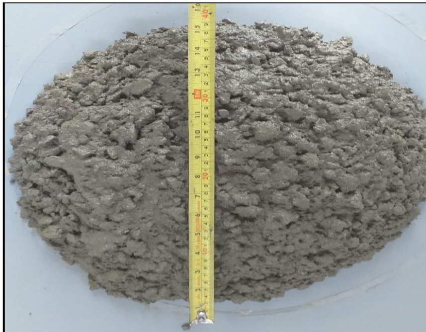
Figura 67. Ensayo de extensión de flujo del CAC grupo con adición al 15%
