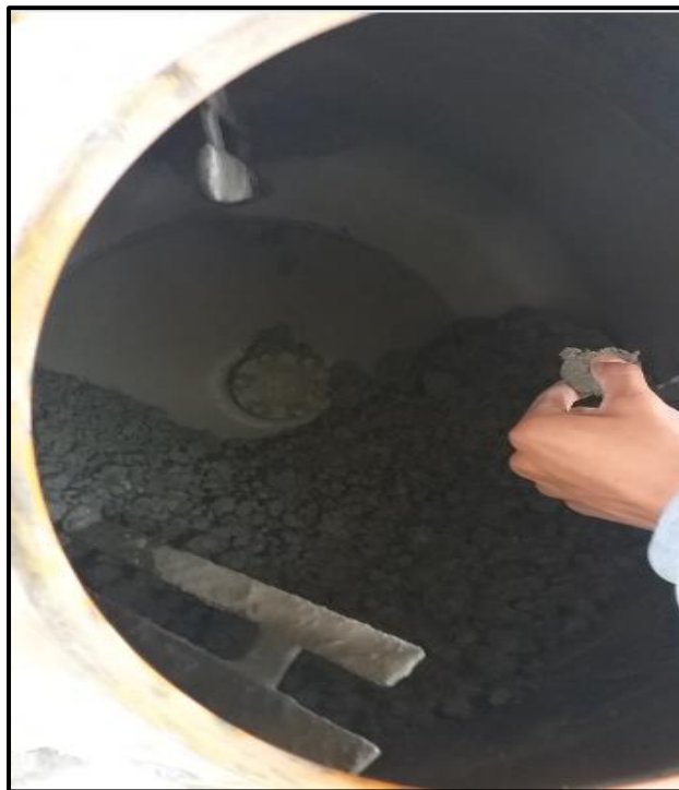
Figura 30. Apariencia grumosa, indicador de reacción del aditivo.
