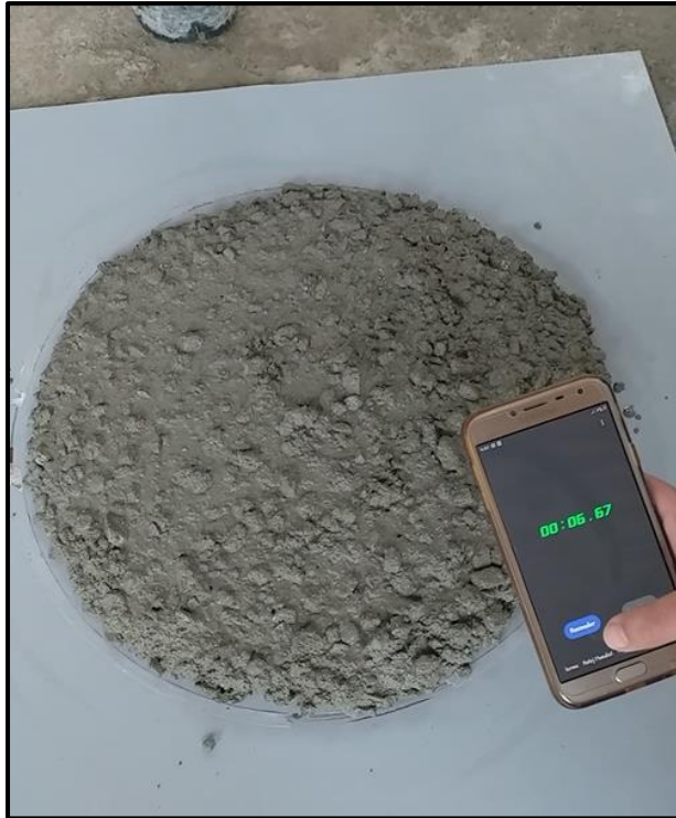
Figura 62. Ensayo para la medida del tiempo del grupo con adición al 5% - ensayo T500.
