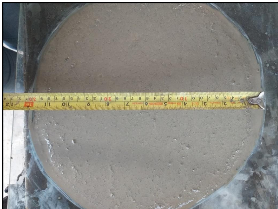
Figura 36. Ensayo de mini cono, d_1 = 29 \text{ cm} . Ensayo con ajuste 01
