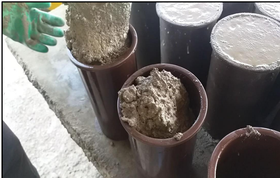
Fotografía 95. Llenado de probetas con mezcla de 10% y 15% de adición, no requiere compactación
