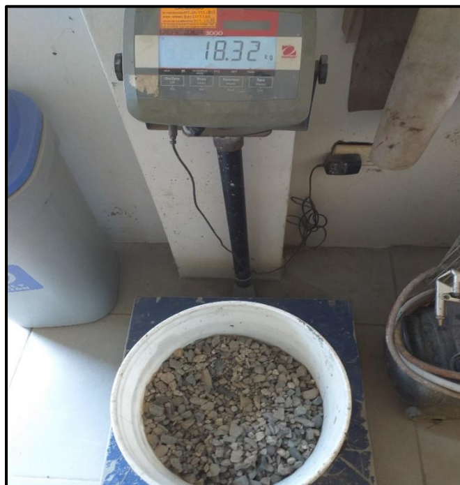
Figura 44. 18.32 Kg de piedra para una tanda de 25 L.
