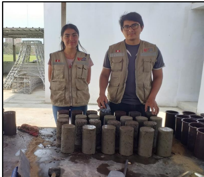
Fotografía 109. Colocado de probetas a las piscinas para su curado.
