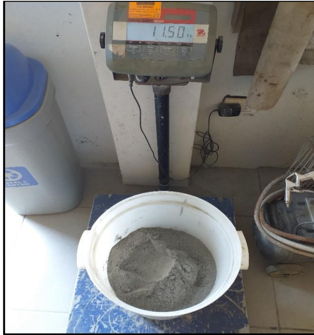
Figura 41. 11.5 kg de cemento para una tanda de 25 L.
