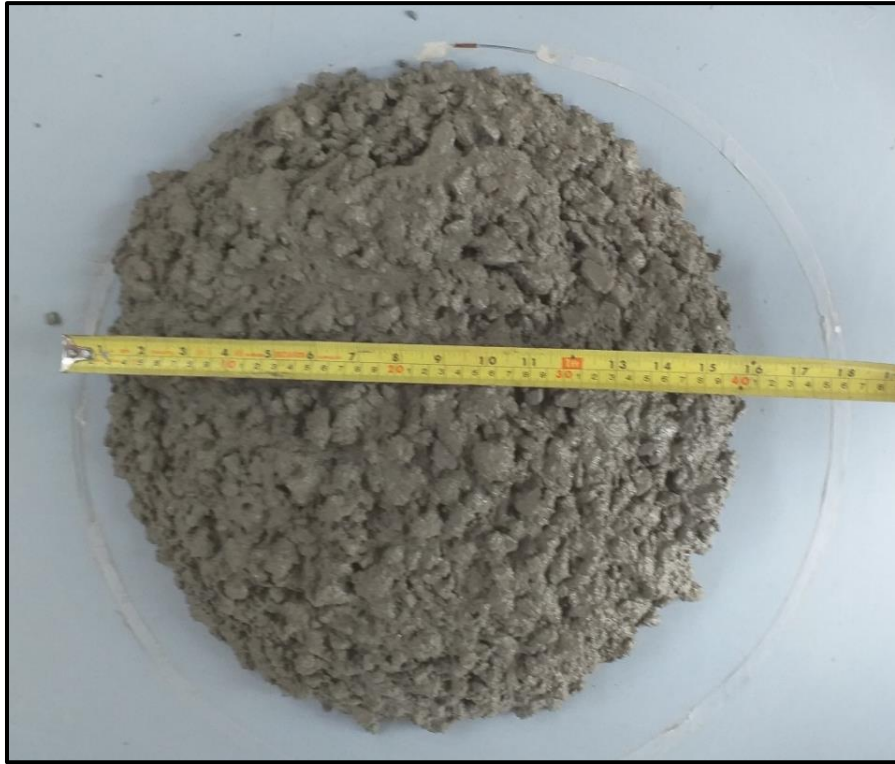
Figura 66: Ensayo de extensión de flujo del CAC grupo con adición al 15%.
