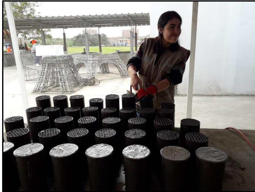
Fotografía 102. Se sacan del molde para su curado apropiado.
