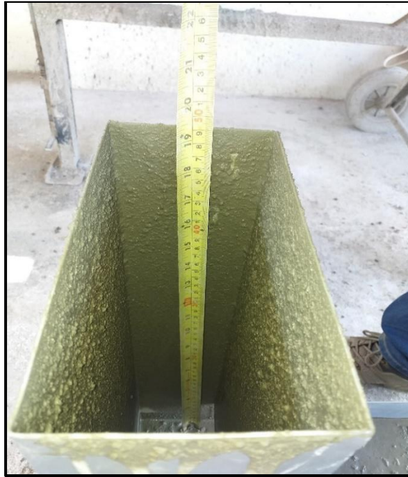
Fotografía 80. Medida para sacar la altura h_1 , grupo patrón – ensayo caja L.
