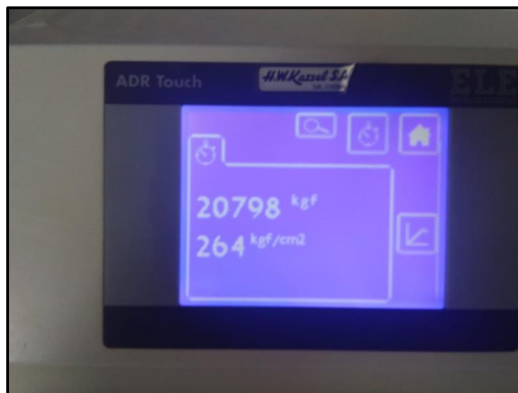
Fotografía 119. Ruptura de probetas grupo al 5% de adición 3 días.
