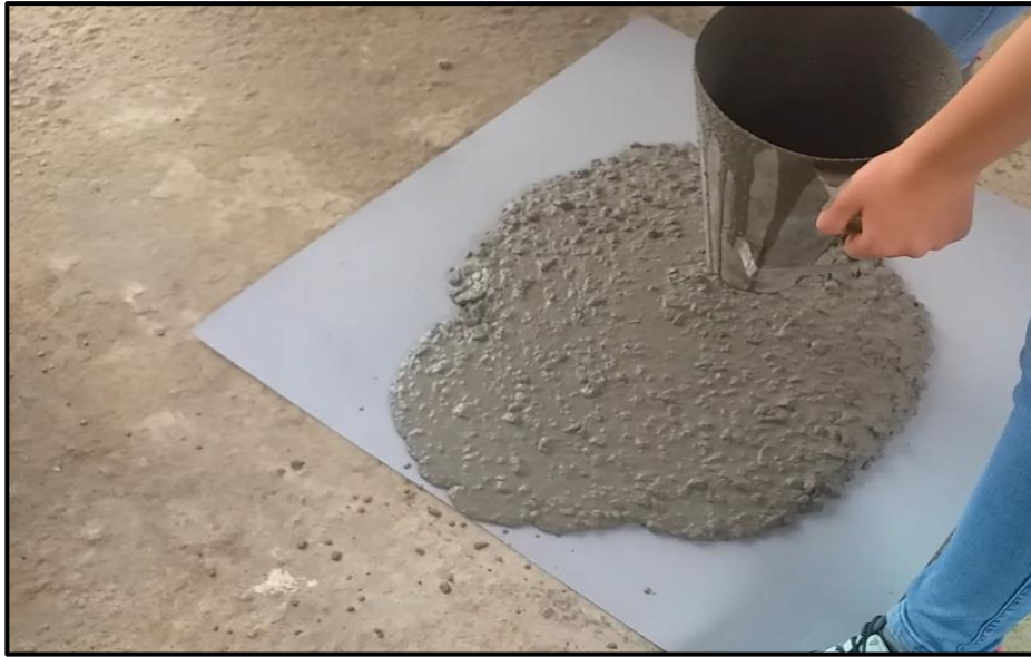
Figura 31. Se aprecia la separación entre la pasta y el agregado, indicando segregación y presencia excesiva de líquidos.
