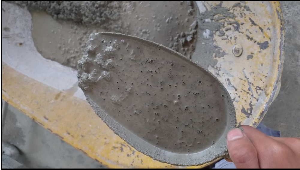
Figura 39. Mezcla con el 1.5% de aditivo, apariencia efervescente, indicador de exceso de aditivo.
