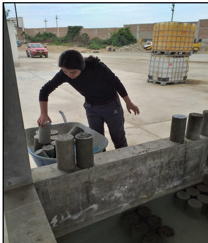
Fotografía 103. Colocado de probetas a las piscinas para su curado.
