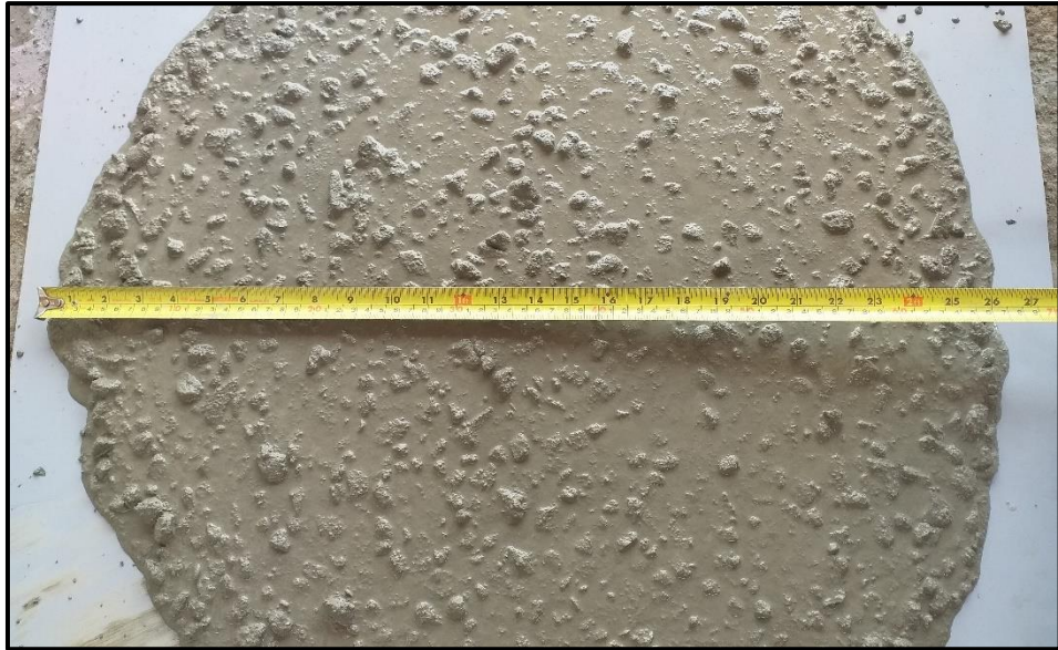
Figura 57. Ensayo de extensión de flujo del CAC. Grupo patrón.
