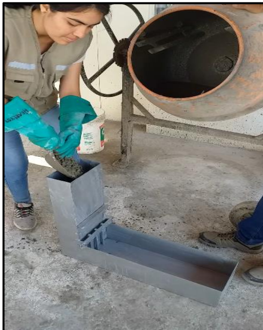
Fotografía 76. Llenado del molde para realizar el ensayo de la capacidad de paso, caja L.
