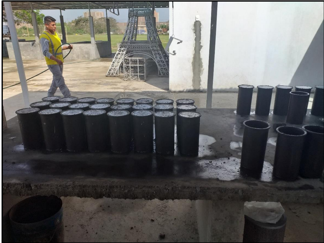
Fotografía 98. Elaboración de probetas, grupo patrón para 3 días
