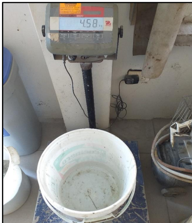
Figura 42. 4.58 kg de agua para una tanda de 25 L.
