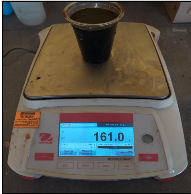
Figura 45. 0.161 kg de aditivo para una tanda de 25 L.
