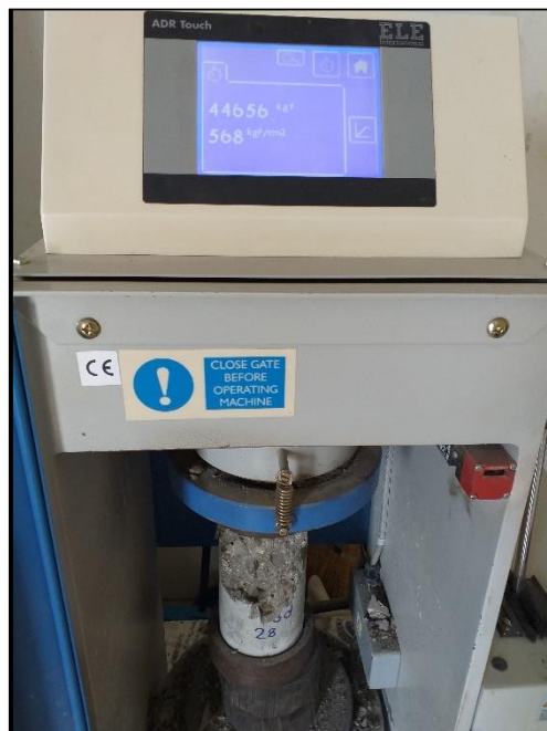
Fotografía 121. Ruptura de probetas grupo al 5% de adición 28 días.
