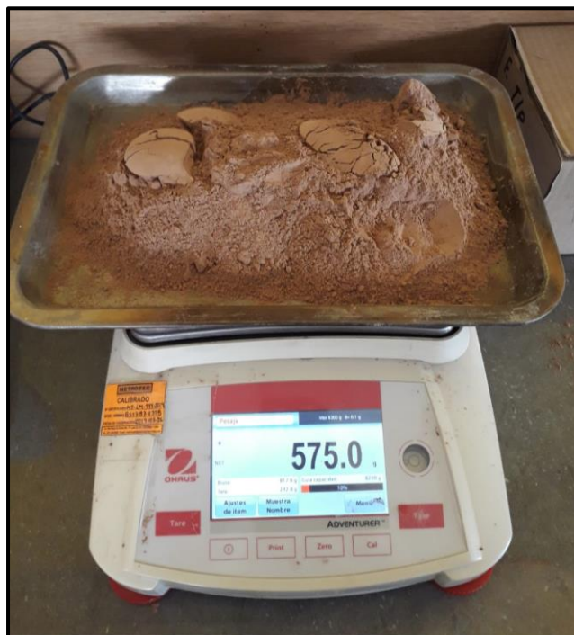
Figura 46. 0.575 kg de adición, arcilla tamizada por la malla 200, representa el 5% del peso del cemento.
