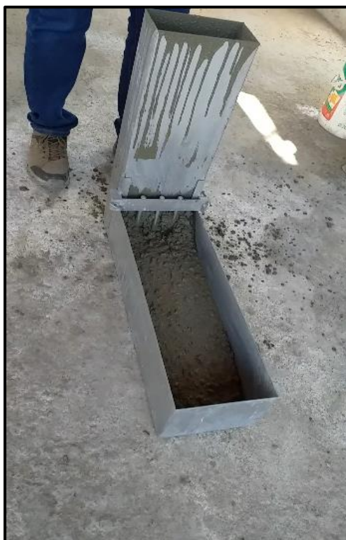
Fotografía 78. Ensayo de la capacidad de paso, caja L grupo patrón.
