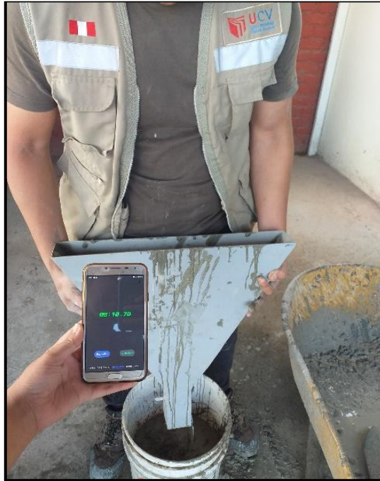
Fotografía 73. Ensayo para la medida del tiempo del grupo con adición al 10% - ensayo Funnel V.
