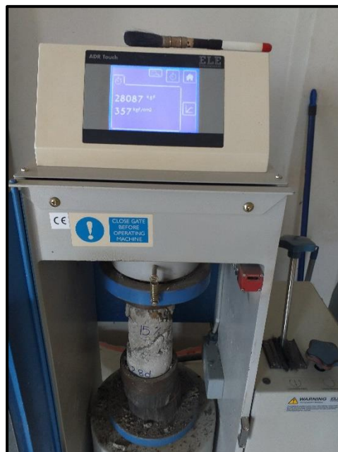
Fotografía 129. Ruptura de probetas grupo al 15% de adición 28 días.
