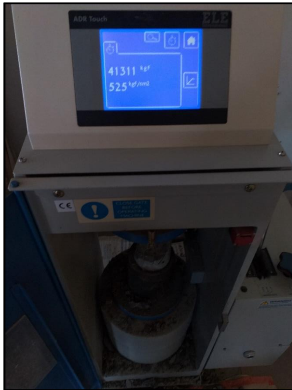
Fotografía 120. Ruptura de probetas grupo al 5% de adición 7 días.
