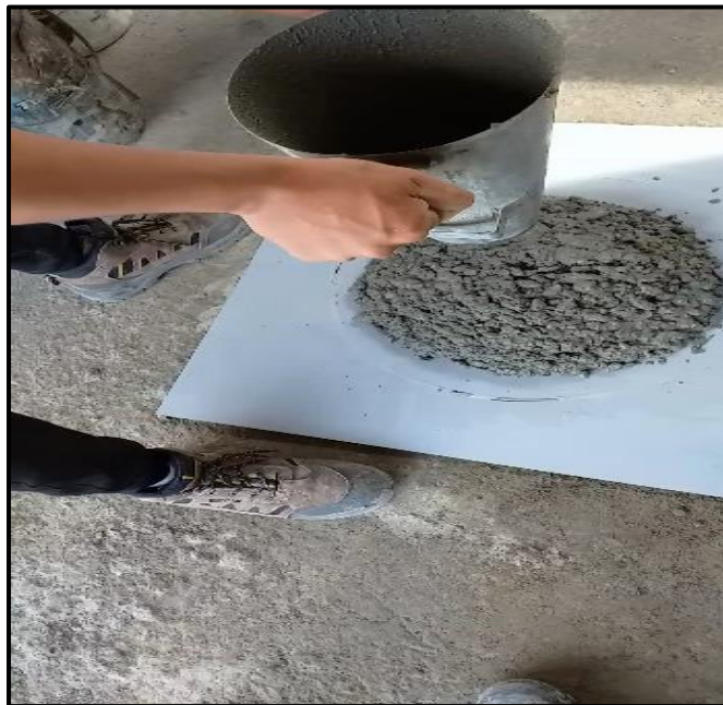
Figura 34. Mezcla consistente, sin indicadores de segregación, pero sin la fluidez requerida, por lo cual, se hace el ajuste a partir de este diseño. Diseño fallido 4.
