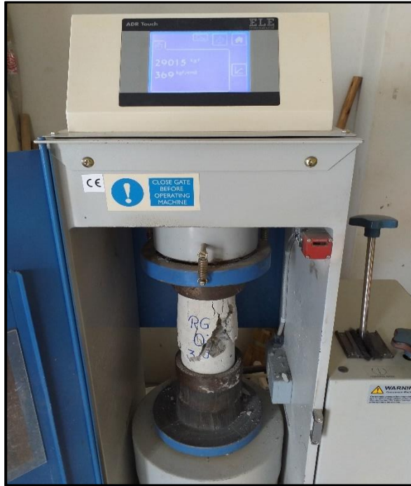
Fotografía 115. Ruptura de probetas grupo patrón 3 días.
