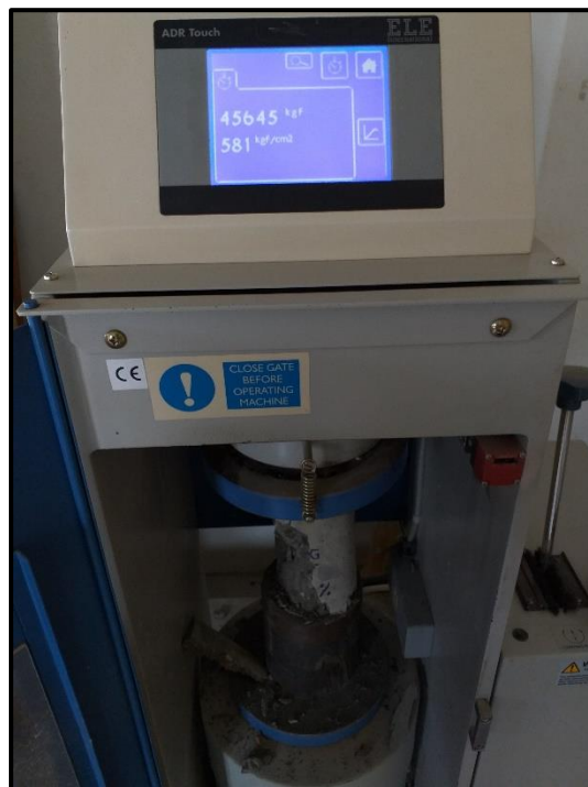
Fotografía 116. Ruptura de probetas grupo patrón 7 días.
