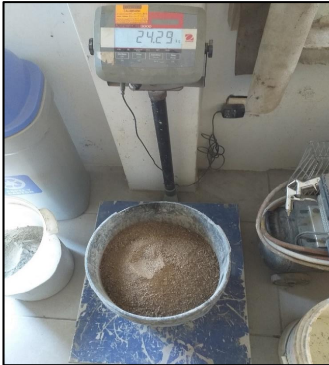
Figura 43. 24.29 kg de arena para una tanda de 25 L.
