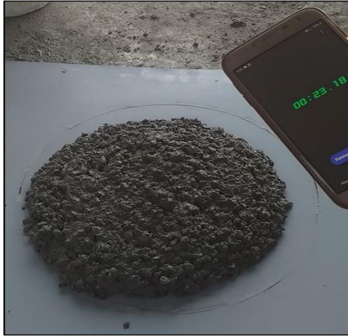
Figura 68. Ensayo para la medida del tiempo del grupo con adición al 15% - ensayo T500.
