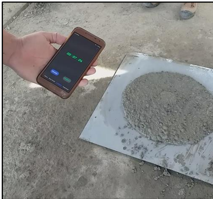
Figura 65. Ensayo para la medida del tiempo de grupo con adición al 10% - ensayo T500.
