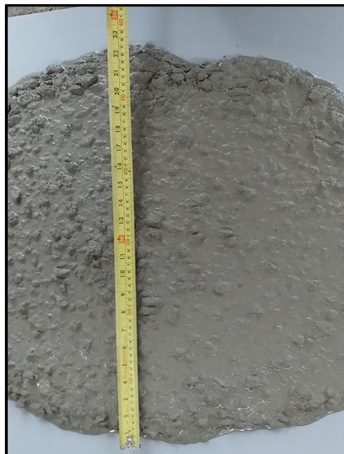
Figura 63. Ensayo de extensión de flujo del CAC. Grupo con adición al 10%.
