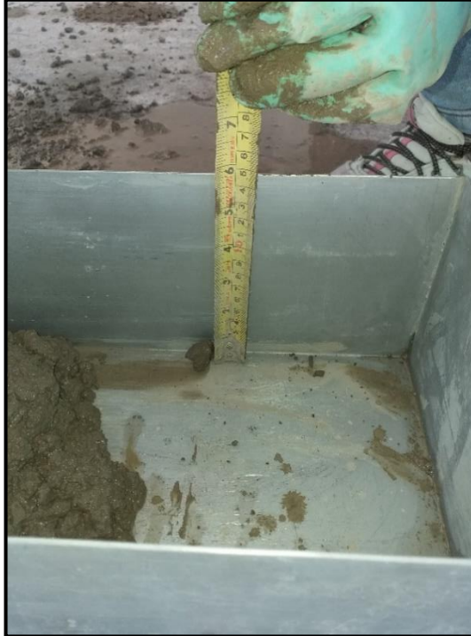
Fotografía 88. Medida para sacar la altura h_2 , grupo al 15% de adición – ensayo caja L.
