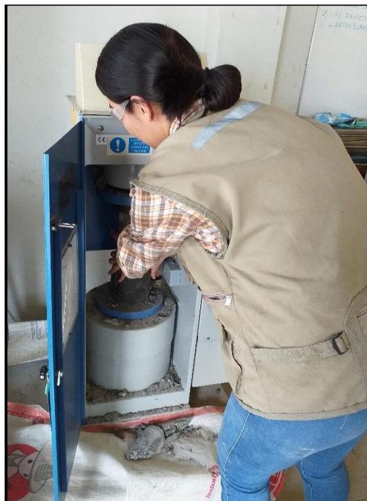
Fotografía 113. Se coloca las probetas en la prensa.
