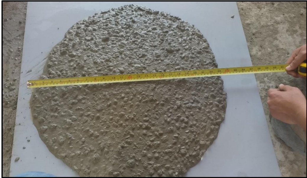
Figura 64. Ensayo de extensión de flujo del CAC – grupos con adición al 10%.
