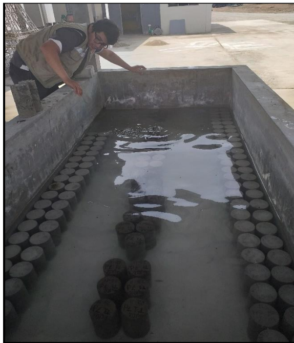
Fotografía 105. Grupos de probetas de patrón, 5%, 10% y 15% de adición para 28, 7 y 3 días.
