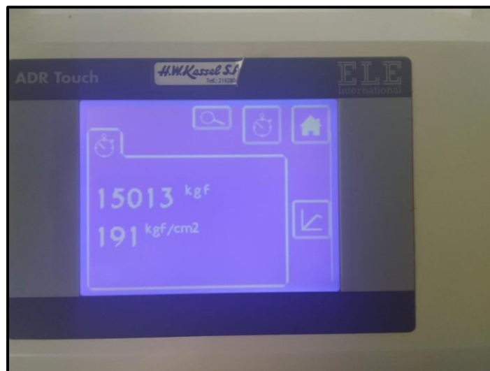
Fotografía 127. Ruptura de probetas grupo al 15% de adición 3 días.
