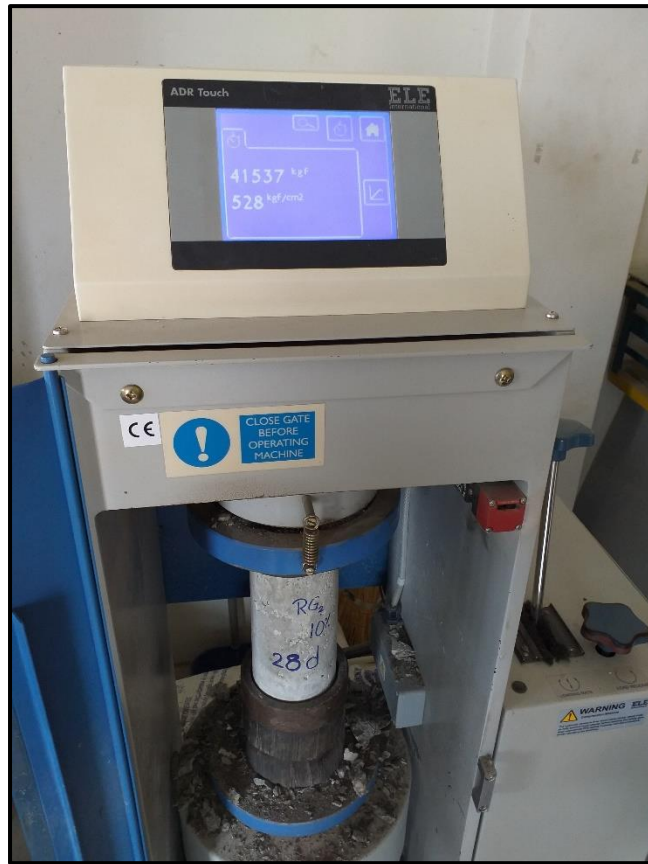
Fotografía 125. Ruptura de probetas grupo al 10% de adición 28 días.
