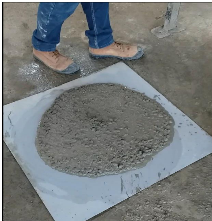
Figura 32. Se observa una mezcla con fluidez, sin embargo, presenta segregación, indicando exceso de líquido. Diseño fallido 2.
