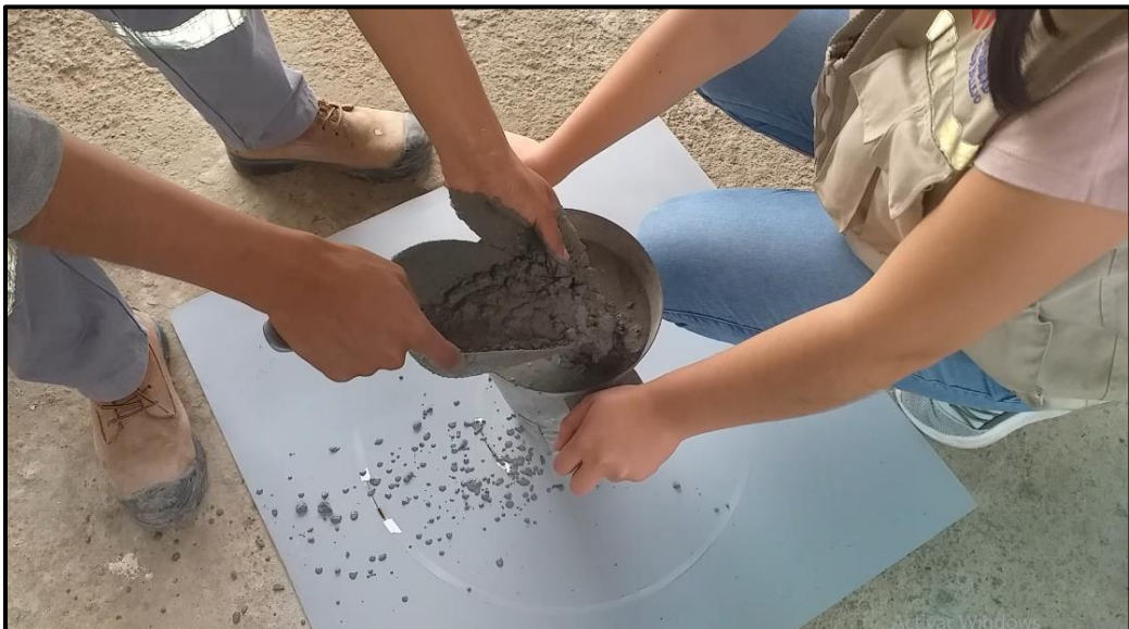
Figura 56. Vertido de la mezcla al cono, para realizar el ensayo de flujo.
