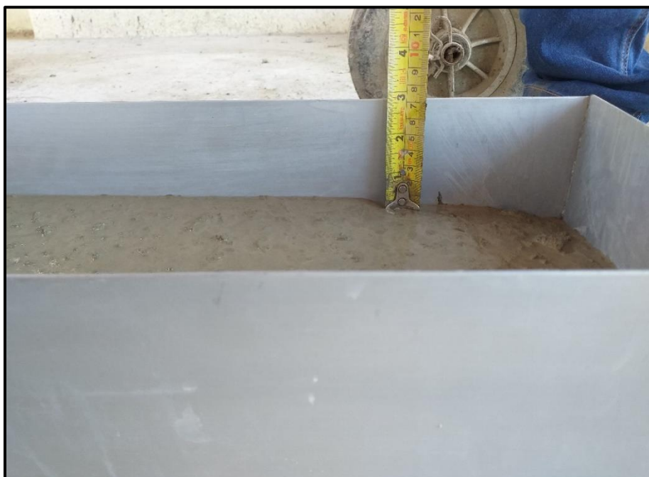
Fotografía 79. Medida para sacar la altura h_2 , grupo patrón – ensayo caja L.
