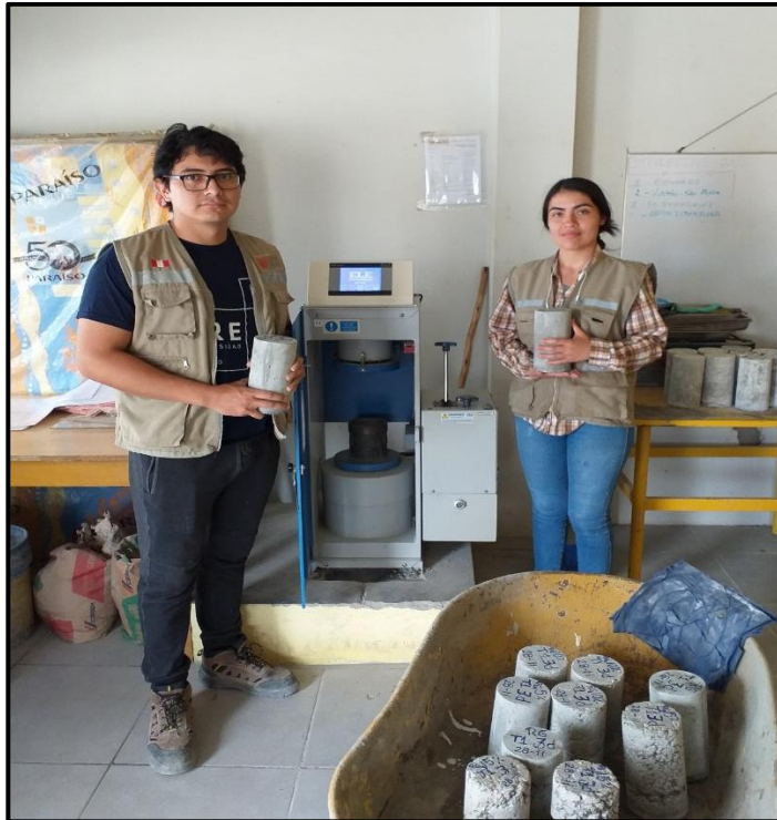
Fotografía 110. Organización de probetas para su debida rotura.
