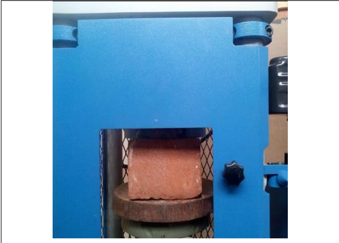
Fotografía 15. Ensayo de resistencia a compresión
