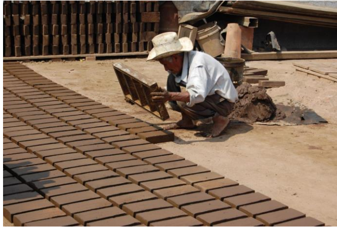
Figura 5. Retiro de molde de ladrillo, fuente (Editorial Restauero)
