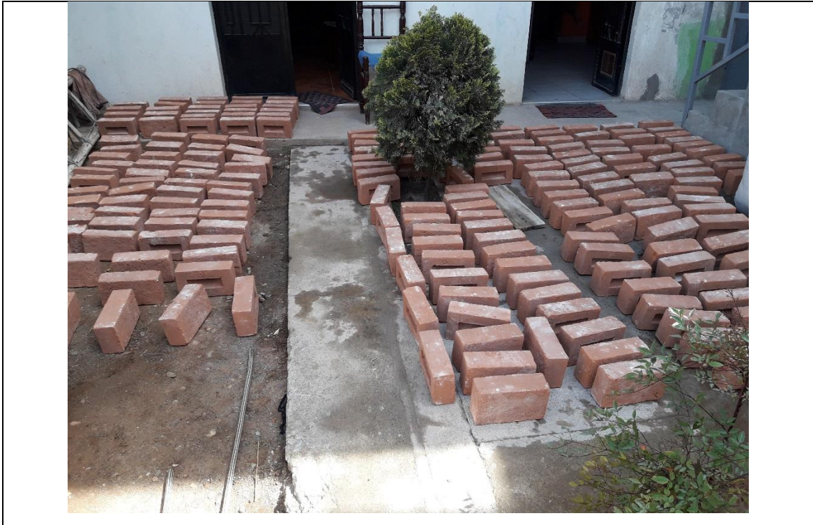
Fotografía 13. Enfriamiento de los ladrillos, ya listos para comenzar con los ensayos
