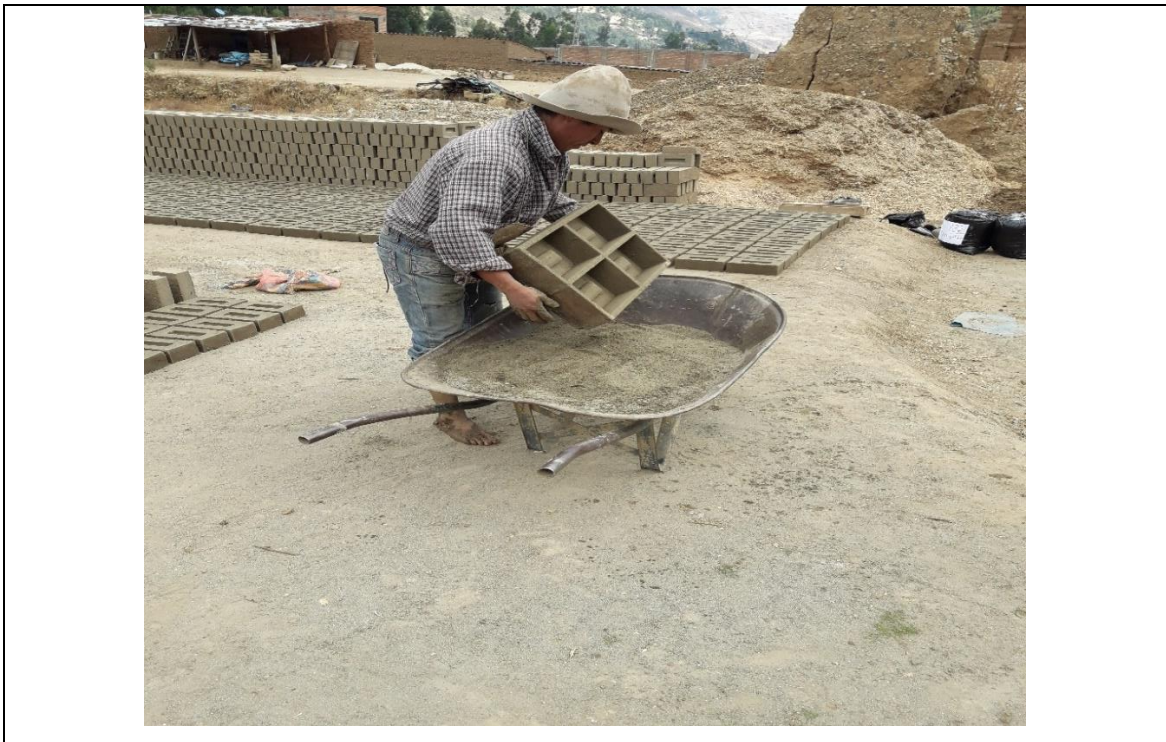
Fotografía 06. Proceso de moldeo de ladrillos
