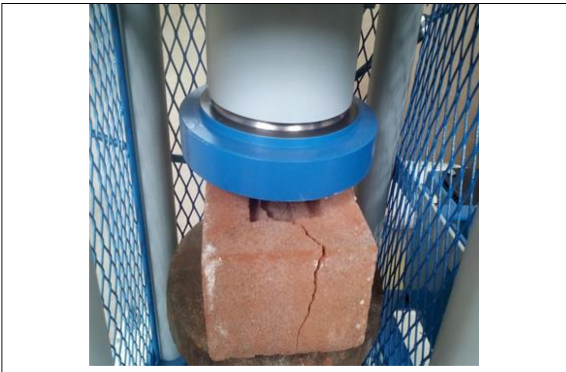
Fotografía 16. Momento de rotura de la muestra sometida a resistencia a compresión
