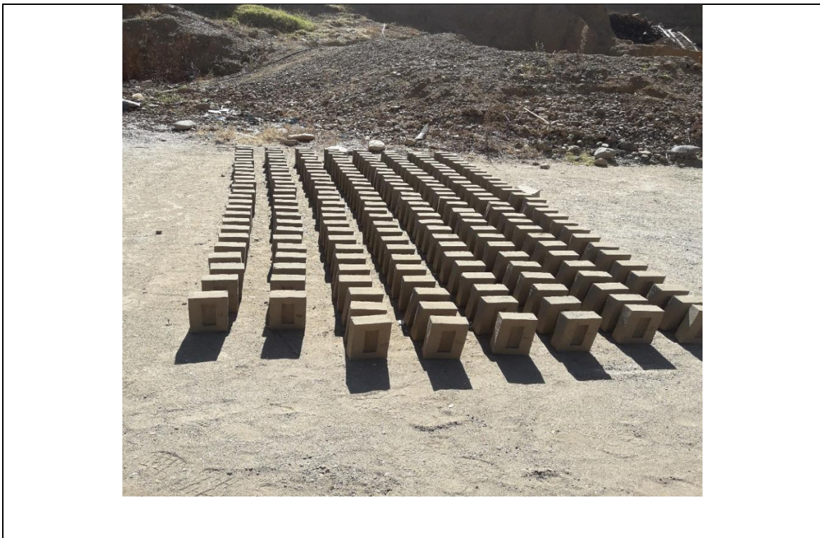
Fotografía 10. Volteado de los ladrillos para que termine de secar
