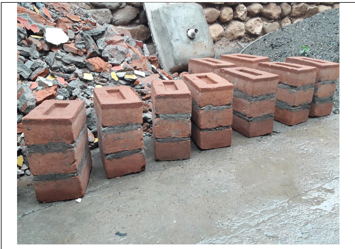
Fotografía 14. Elaboración de pilas de ladrillo
