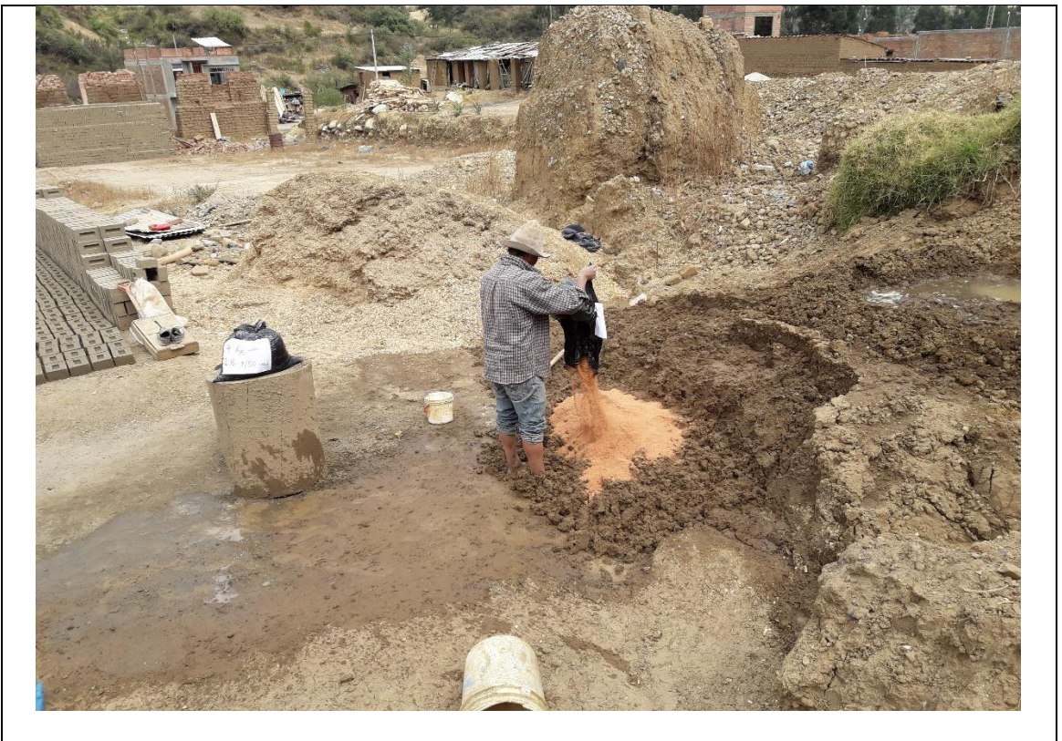
Fotografía 04. Proceso de incorporación del aserrín para su posterior amasado.
