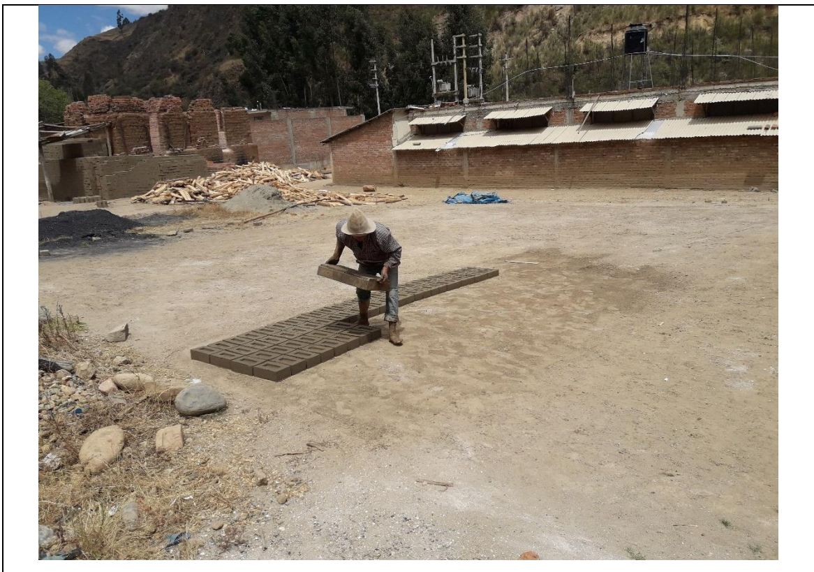
Fotografía 08. Inicio del proceso de secado
