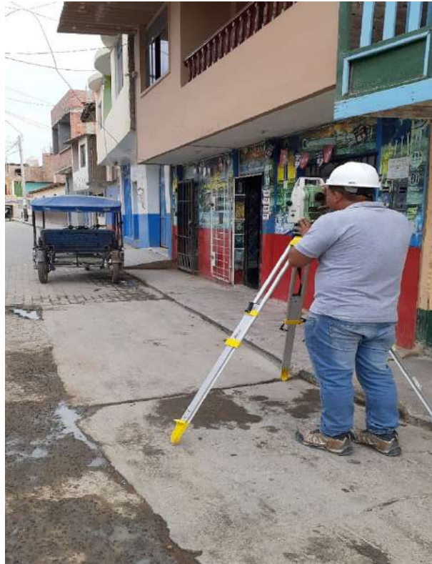
Figura 16. Utilizando estación total
