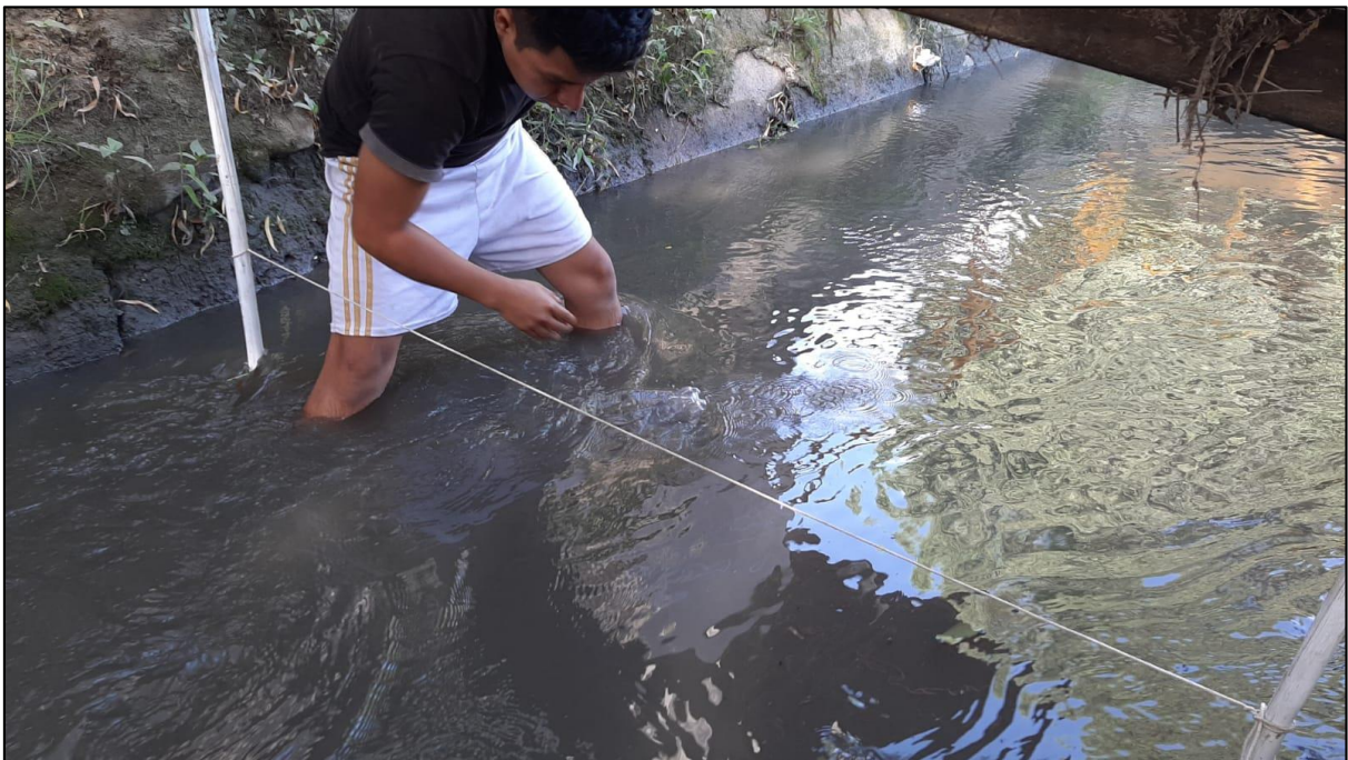
Medición de velocidad con flotadores en el canal Vichanzao
