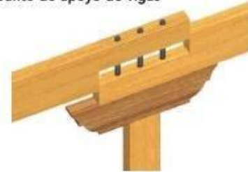
• punto de apoyo de vigas
