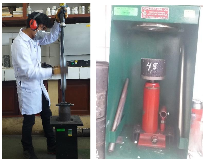
Compactación y desmolde de briquetas
