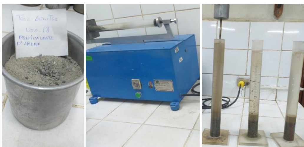
Figura 18: Equivalente de arena
