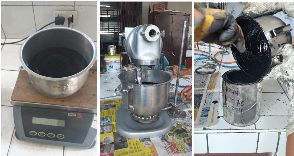
Incorporación y mezclado del grano de caucho – cemento asfáltico
