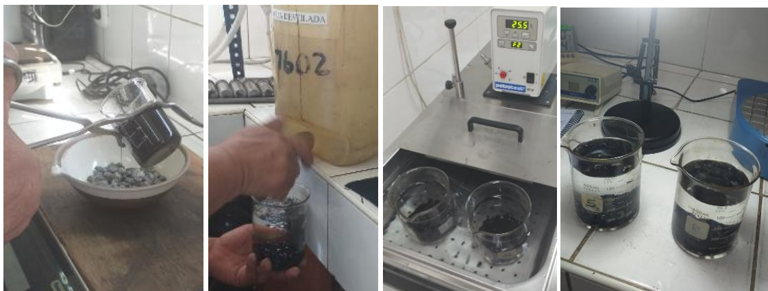
Figura 28: Adherencia (agregado grueso)
