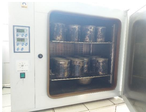
Agregados en el horno a 145 °C - 150 °C
