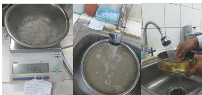
Figura 30: Granulometría y lavado por la malla N.º 200
