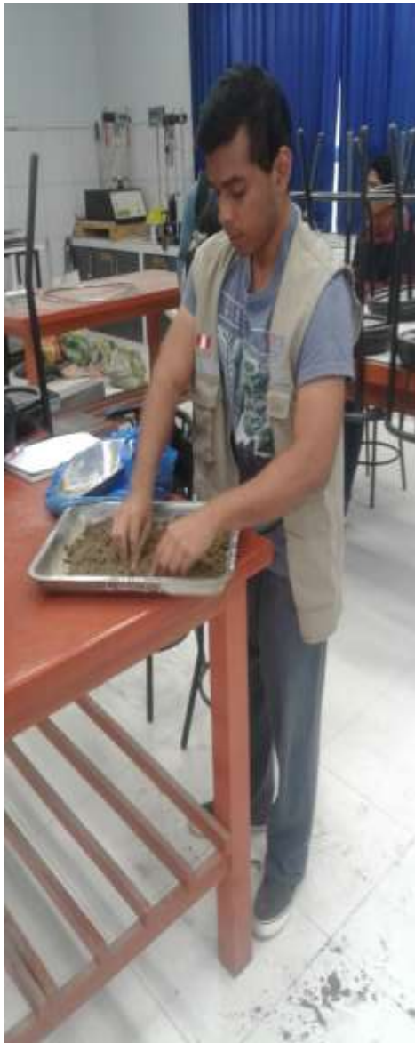
IMAGEN N°10: Limpieza de la muestra de materiales que no sirvan para realizar el ensayo
