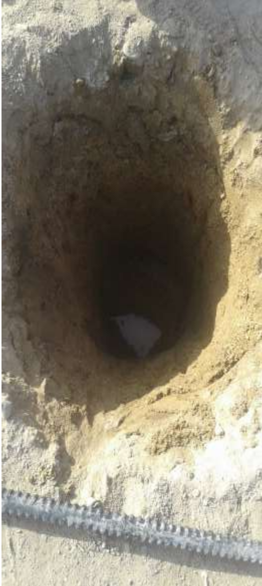
IMAGEN N°7: se puede apreciar la profundidad de capa de agua a los 0.90 m de la calicata realizada en la av. aviación
