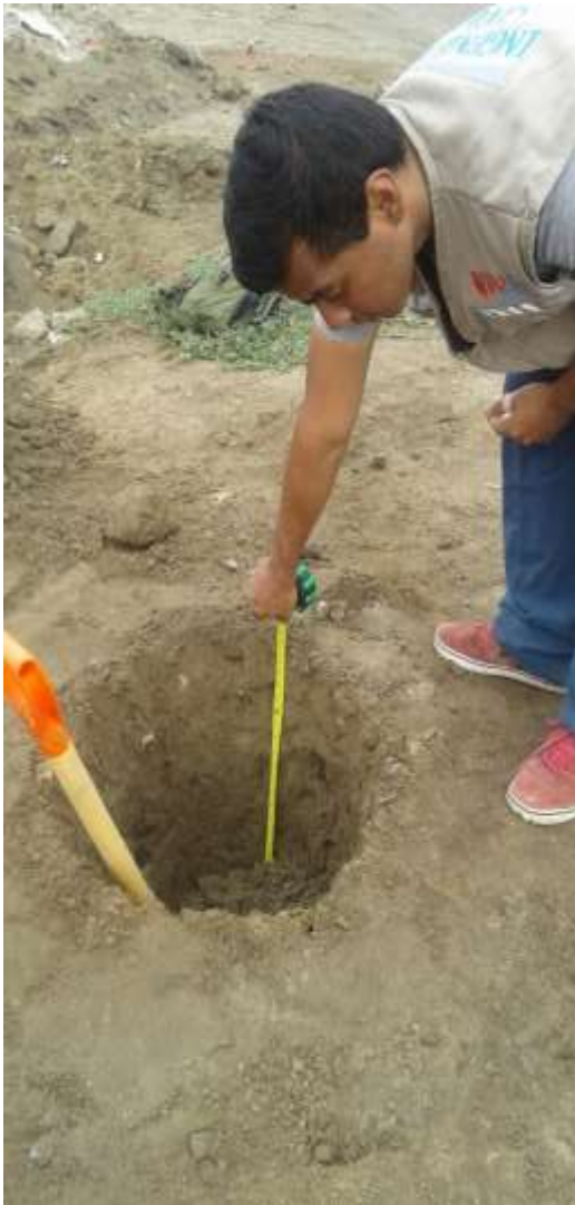
IMAGEN N°1: Medición de la profundidad de la primera calicata para la toma de la primera muestra a los 0.50 m, realizada en la av. Portuaria
