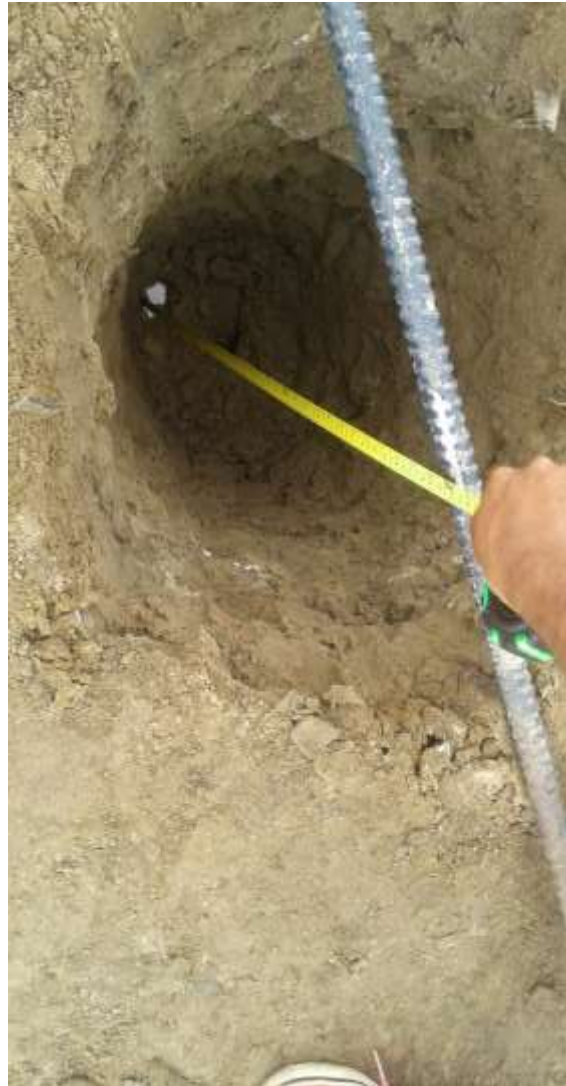
IMAGEN N°2: Medición en la que se encontró la profundidad de la napa freática, la cual fue 0.92 m (av. Portuaria), de la cual también se tomo una muestra
