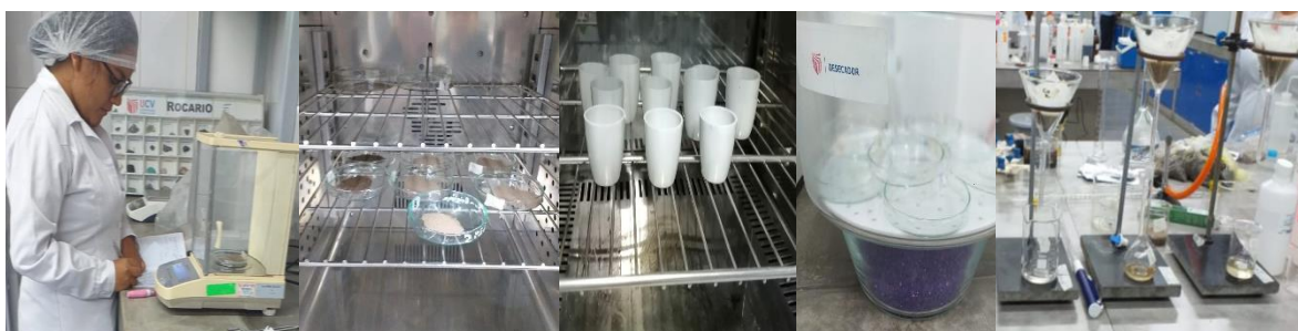
Figura 7: Determinación de Humedad, Materia Orgánica y CIC - Lab. Biotecnología, UCV.
