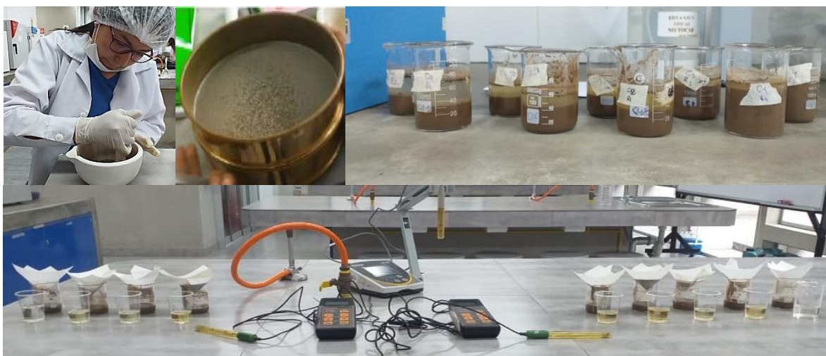
Figura 6: Determinación de pH, C.E y Potencial Redox – Lab. Biotecnología, UCV.
