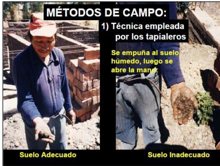
Figura 56: Tipo de suelo Adecuado e Inadecuado.
