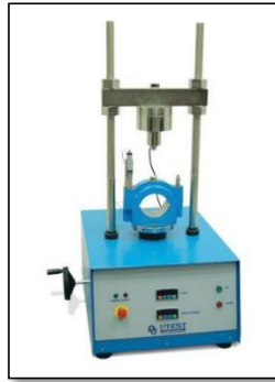
Imagen 5: Maquina Marshall (fuente: UTEST Equipo para ensayo de materiales)
