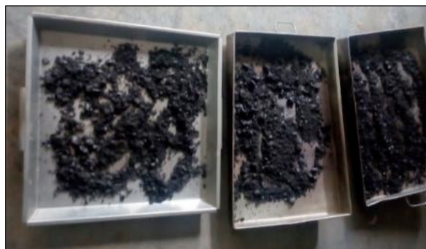
Imagen 16: Mezcla asfáltica en frío, pérdida de humedad
