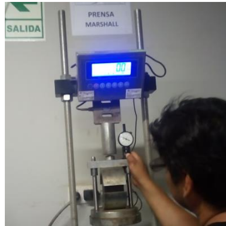
Imagen: Ensayo Marshall
