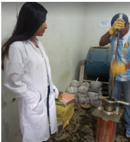
Imagen: Compactación de la mezcla
