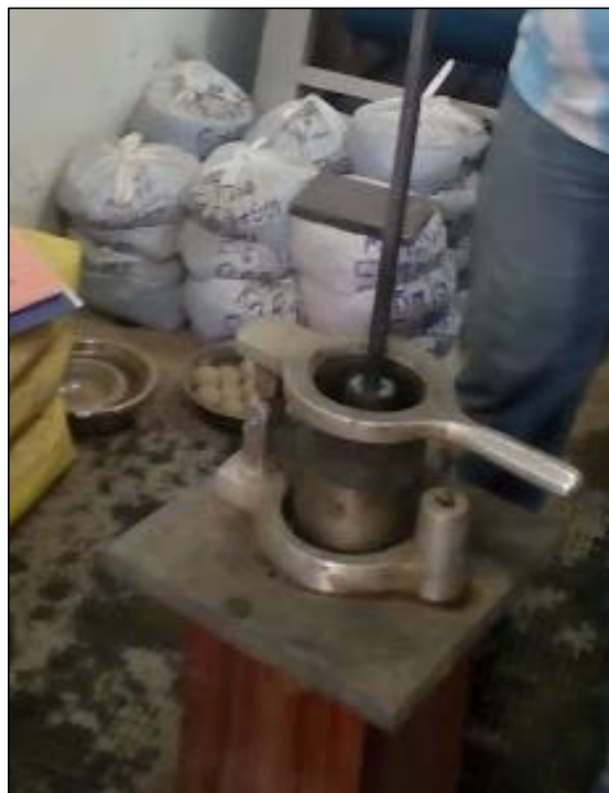
Imagen 9: Compactación de 75 golpes
