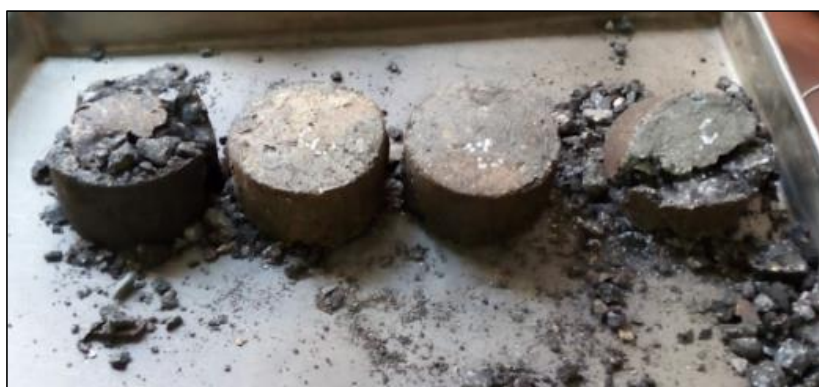
Imagen 17: Rotura de briquetas en maquina Marshall a 24hr.
