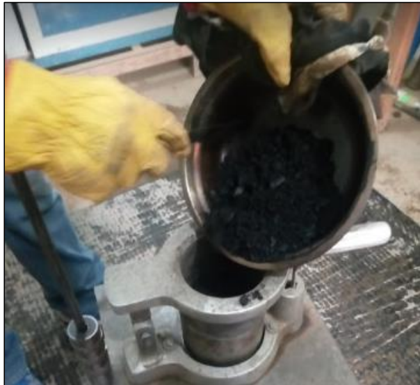
Imagen 8: Colocada de la mezcla al molde
