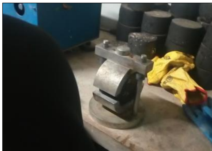
Imagen 13: Colocado de briqueta en el molde Marshall
