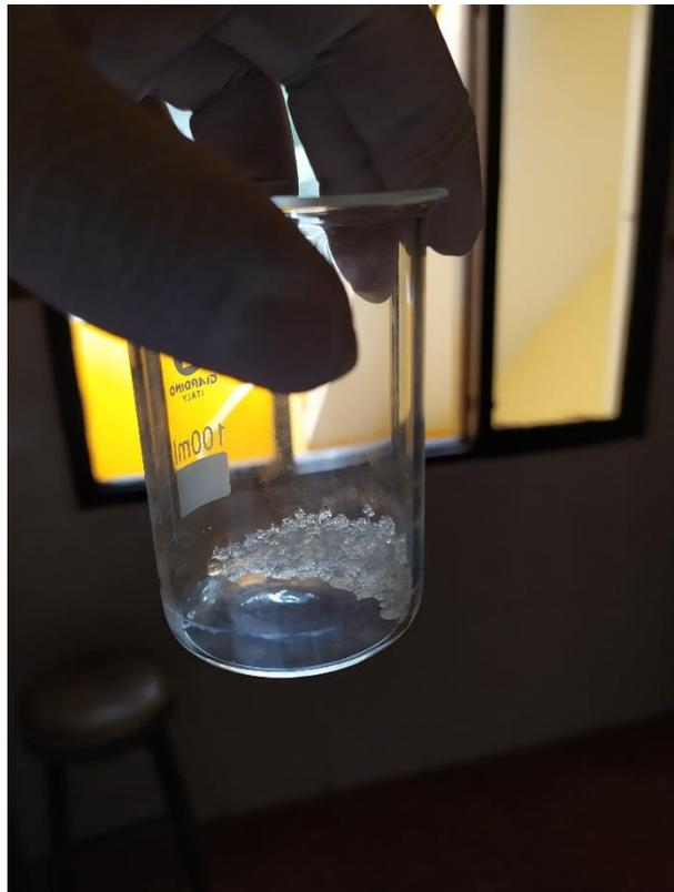
Figura 7. Utilización de una pizca de sulfato de Magnesio para eliminar agua
