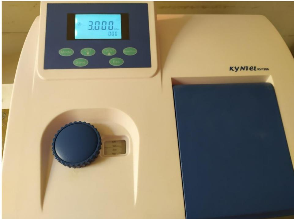
Figura 22. Medición de las Absorbancias a 515nm en espectrofotómetro KynTel 1200.
