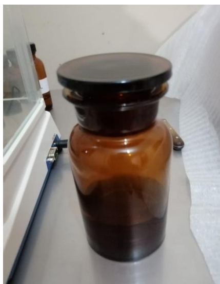
FIGURA 10 ALMACENAMIENTO DE LA MUESTRA HIDROETANÓLICA DEL FRUTO DE HYLOCEREUS UNDATUS EN UN FRASCO COLOR ÁMBAR
