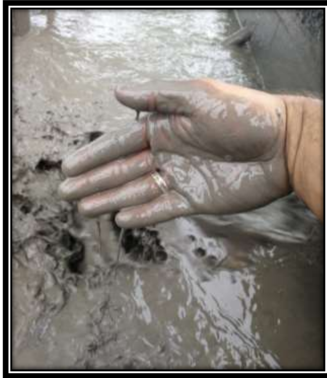
Figura 17. Descarga líquida. El fluido tiene propiedades muy cercanas al agua, por lo que luego de que las pruebas son realizadas este fluido es transportado al siguiente pozo para su reutilización
