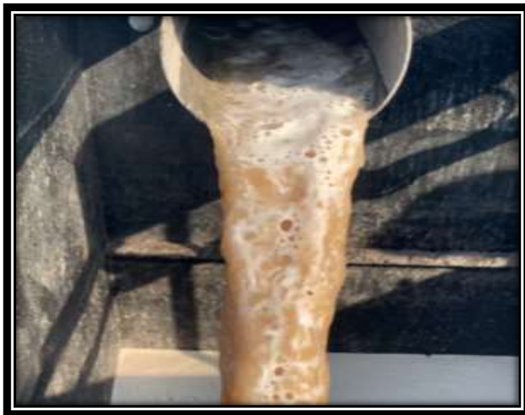
Figura 17. Descarga líquida. El fluido tiene propiedades muy cercanas al agua, por lo que luego de que las pruebas son realizadas este fluido es transportado al siguiente pozo para su reutilización
