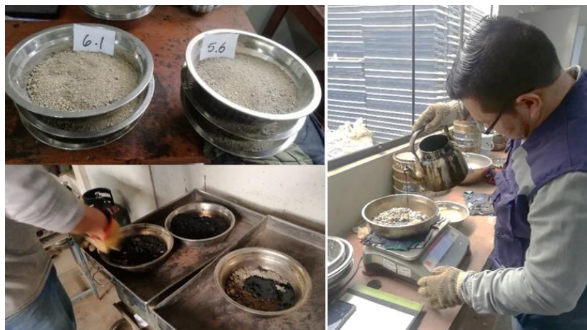
Figura 13. Elaboración de la mezcla asfáltica por porcentaje de agregados
