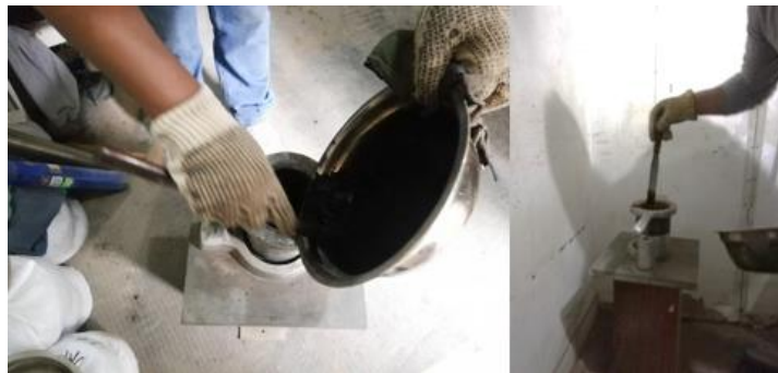
Figura 41. Ingreso de la mezcla asfáltica en el molde pre calentado
