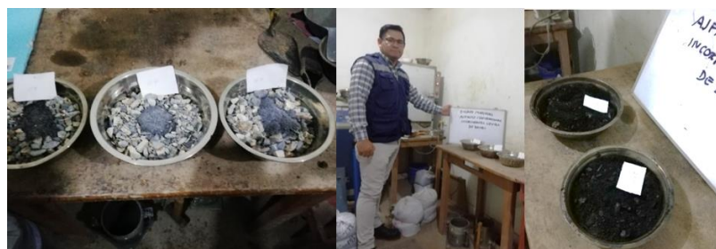
Figura 48. Elaboración mezcla asfáltica incorporando cenizas de bambú
