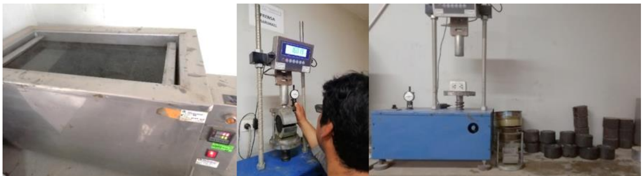
Figura 45. Baño María, lectura estabilidad y fluencia (mezcla patrón)
