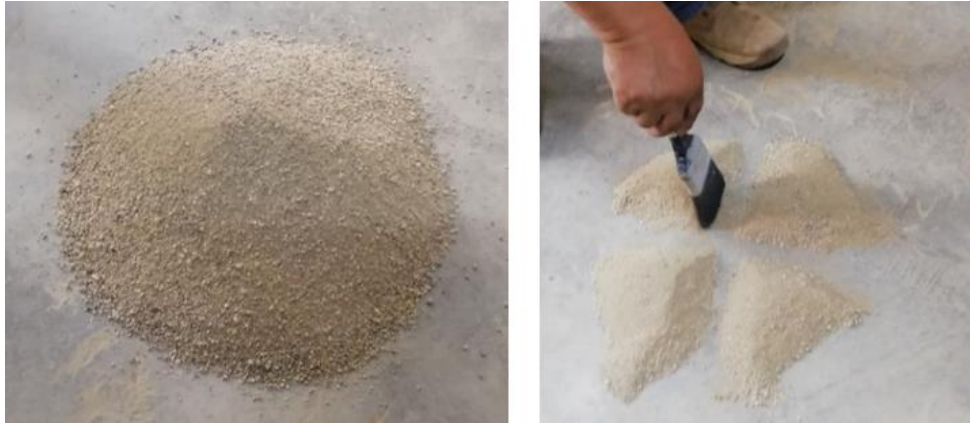
Figura 8. Cuarteo agregado fino
