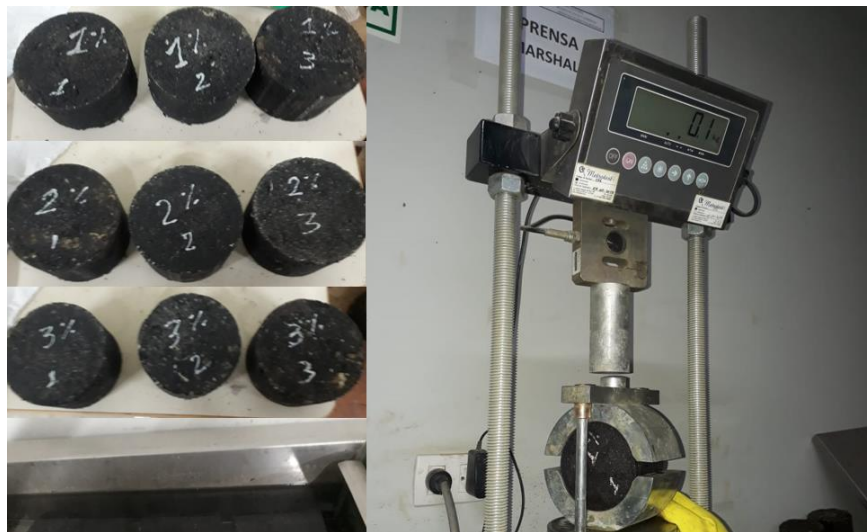
Figura 25. Especímenes Marshall, baño maría y ensayo de estabilidad/flujo
