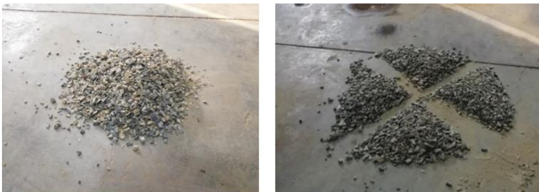
Figura 7. Cuarteo agregado grueso
