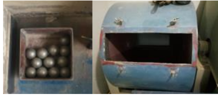
Figura 36. Esferas y máquina Los Ángeles
