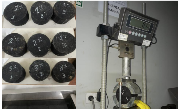
Figura 49. Lectura estabilidad y fluencia (% de ceniza de bambú)
