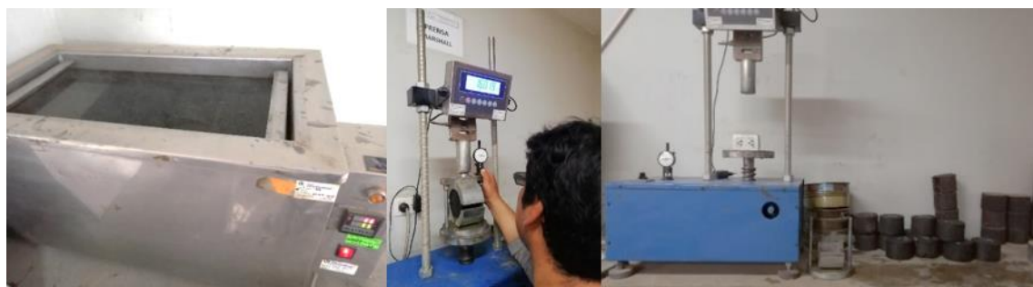
Figura 17. Baño maría y uso de prensa Marshall
