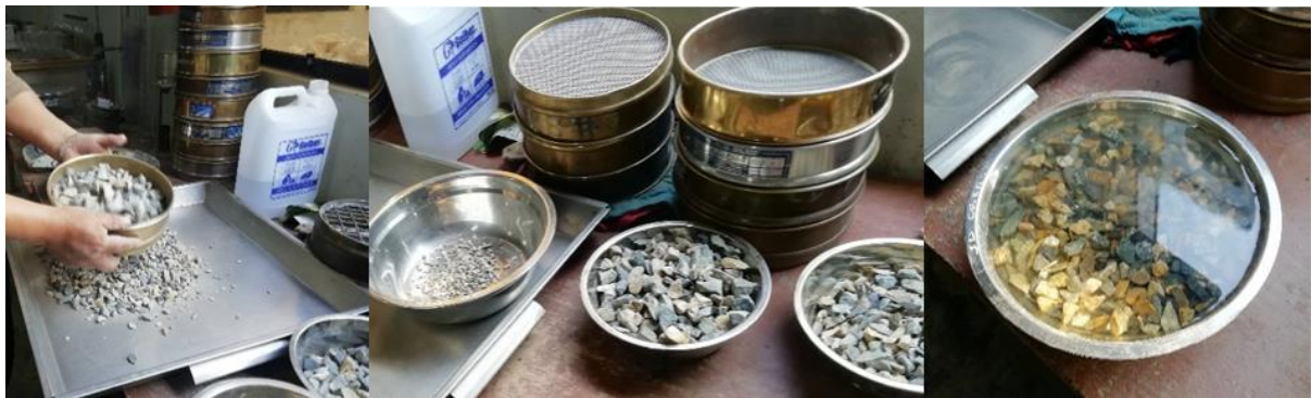
Figura 9. Tamizado y saturación agregado grueso
