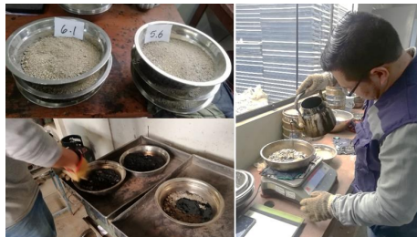
Figura 38. Preparación mezcla asfáltica en caliente (patrón)
