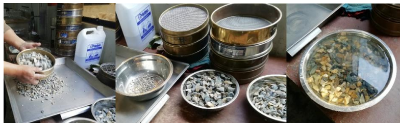
Figura 34. Tamizado y saturación agregado grueso (grava triturada)
