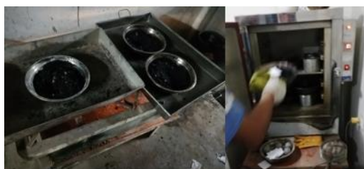
Figura 39. Mezcla asfáltica patrón llevada a horno
