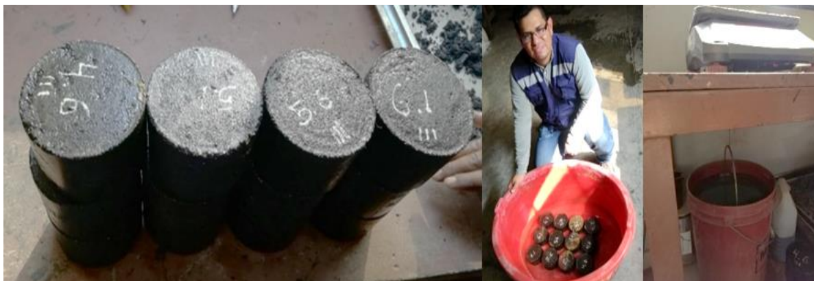
Figura 16. Saturación y densidad Bulk mezcla compactada
