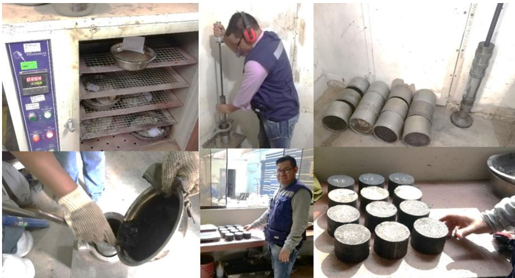
Figura 14. Elaboración de las briquetas Marshall Patrón
