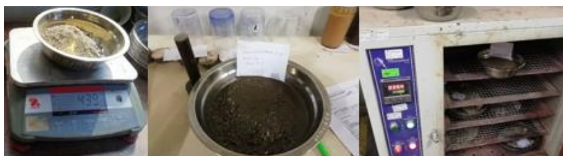
Figura 35. Tamizado, saturación y secado al horno diseño MAC-2
