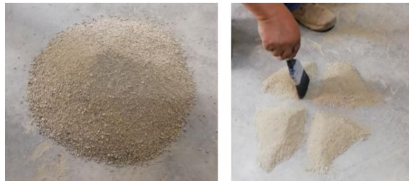
Figura 33. Cuarteo manual agregado fino (arena zarandeada)
