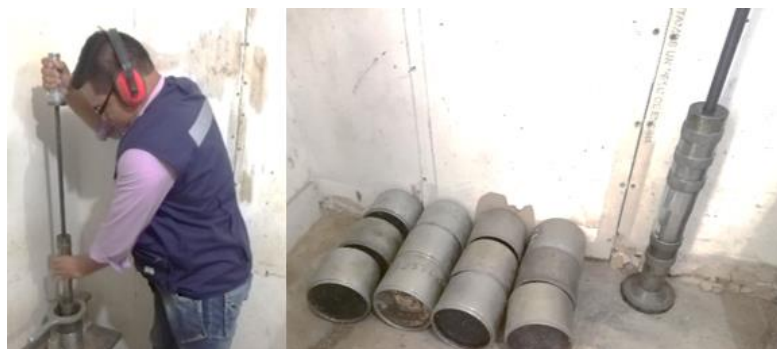
Figura 42. Compactación y especímenes enfriados a temperatura ambiente
