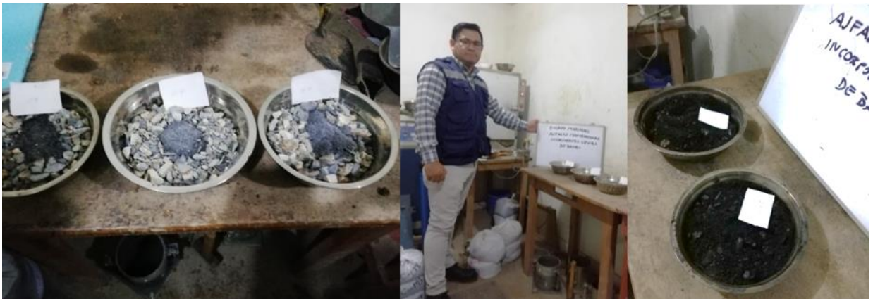
Figura 24. Mezcla asfáltica en caliente incorporando cenizas de bambú
