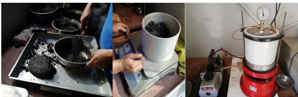
Figura 15. Bomba de vacíos y densidad mezcla suelta
