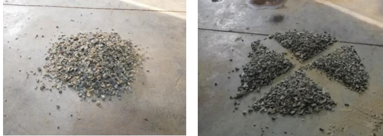
Figura 32. Cuarteo manual agregado grueso (piedra triturada)
