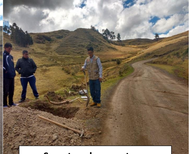
Se extrae la muestra y cuartearlo para poder escoger la mayor conveniente para el ensayo.
