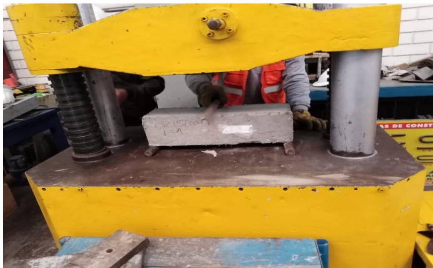
Figura 3. Ensayo de viga carga central
