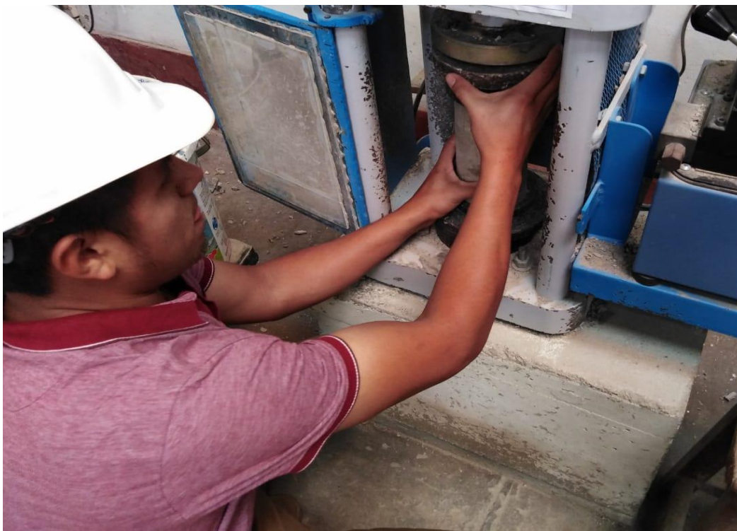
Figura 13. Ensayo de resistencia a la compresión
