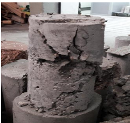
Figura 11. Probeta sin la incorporación de fibra de acero Wirand FF3
