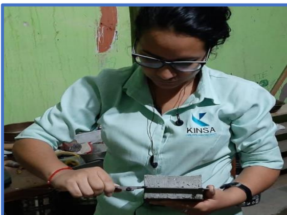
Imagen N° 23. Tomando las dimensiones de los adoquines.
