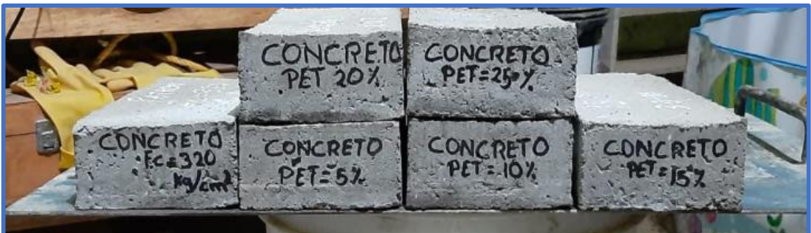
Imagen N° 22. Adoquines listos para ser evaluados.
