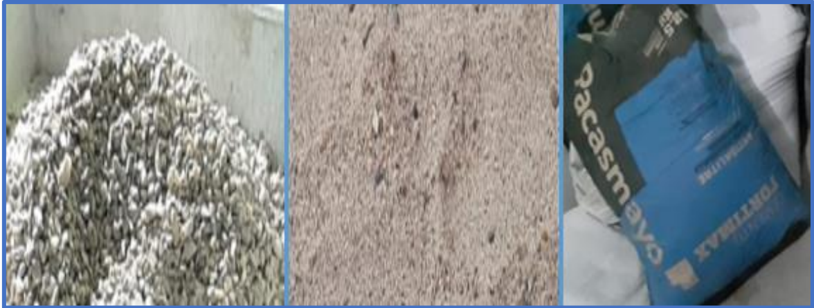
Imagen N° 8. Materiales usados (piedra, arena y cemento).
