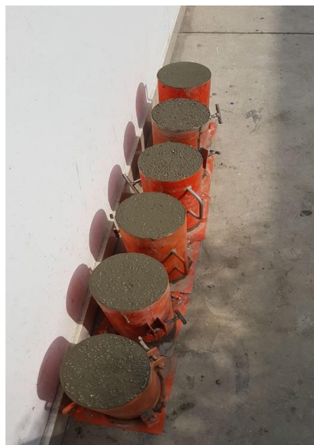
Ilustración 75. ENSAYO N° 7, Diseño de mezcla incorporando poliestireno expandido 20 %
