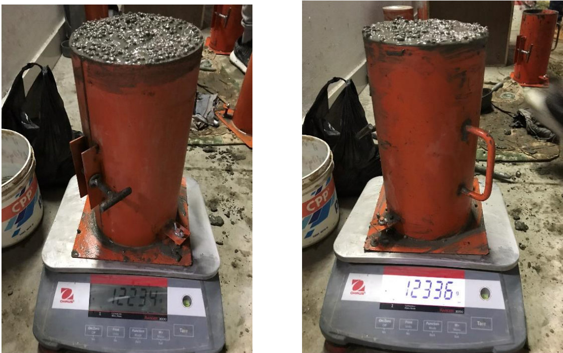
Ilustración 66. ENSAYO N° 5, Muestras con poliestireno expandido 10%
