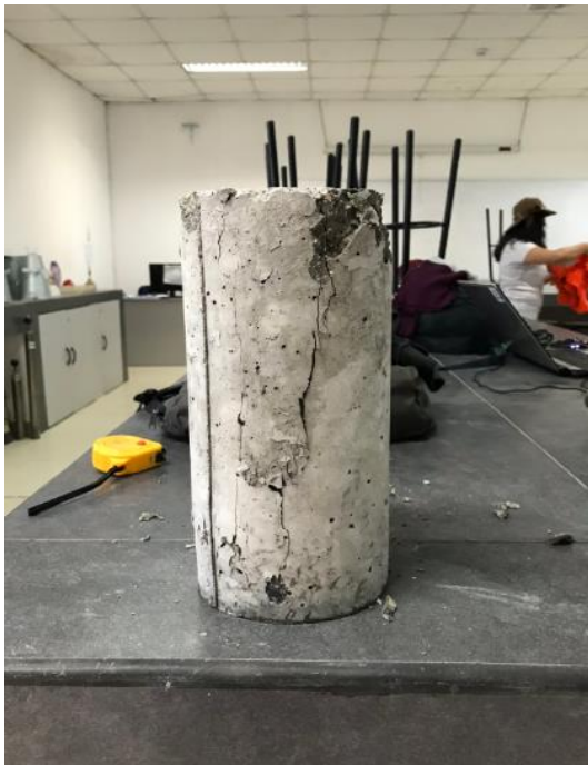
Ilustración 52. MUESTRA 04, ensayo de resistencia a la compresión a los 3 días.
