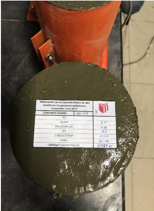
Ilustración 57. ENSAYO N° 4, Muestras con poliestireno expandido 10%
