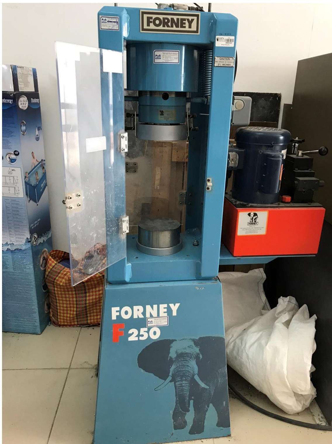
Ilustración 33. PRENSA DE CONCRETO, FORNEY. F-1100KNB-CPILOT, Serie 17027.
