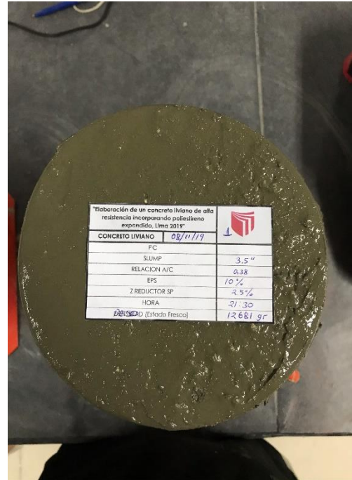
Ilustración 55. ENSAYO N° 4, Diseño incorporando poliestireno expandido 10%
