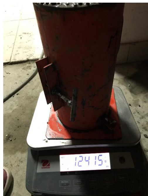
Ilustración 70. ENSAYO N° 6, Muestras con poliestireno expandido 15 %
