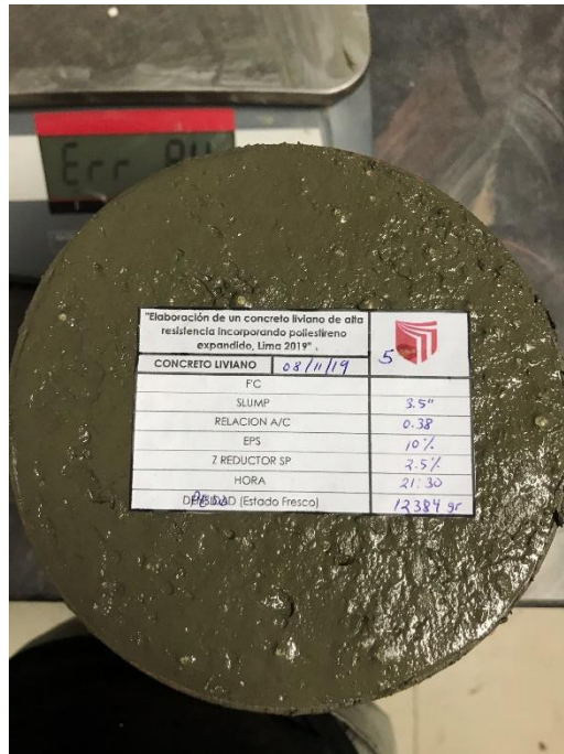
Ilustración 57. ENSAYO N° 4, Muestras con poliestireno expandido 10%
