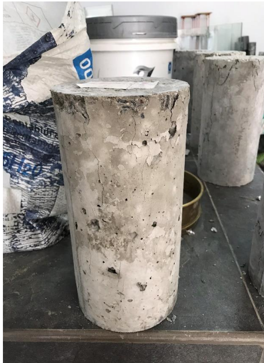
Ilustración 44. MUESTRA 01 – Tipo de falla
