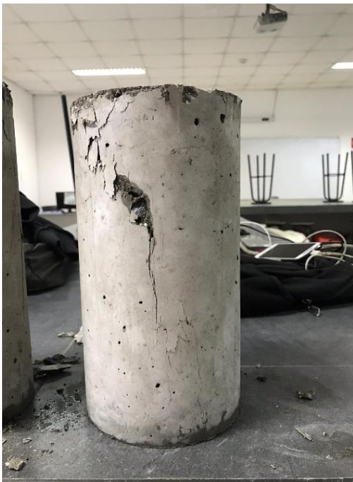
Ilustración 54. MUESTRA 05, ensayo de resistencia a la compresión a los 3 días.
