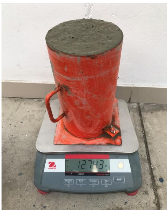
Ilustración 42. ENSAYO N° 2 – Peso de las muestras en estado fresco.
