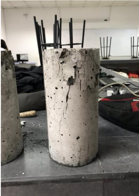
Ilustración 53. MUESTRA 05, ensayo de resistencia a la compresión a los 3 días
