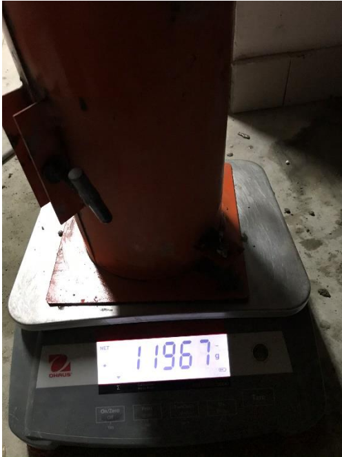
Ilustración 71. ENSAYO N° 6, Muestras con poliestireno expandido 15 %
