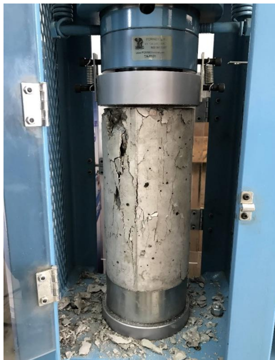
Ilustración 48. MUESTRA 03 – Tipo de falla.
