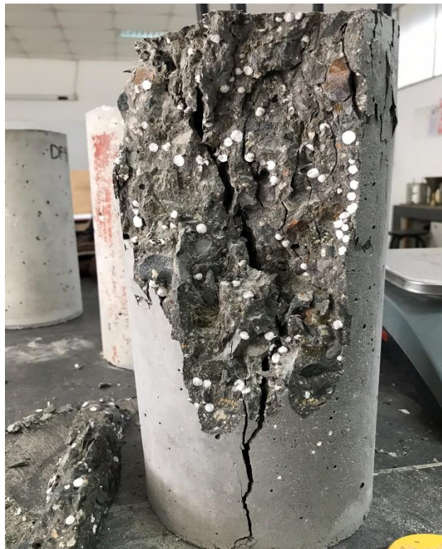
Ilustración 86 Tipo de falla, EPS = 15%
