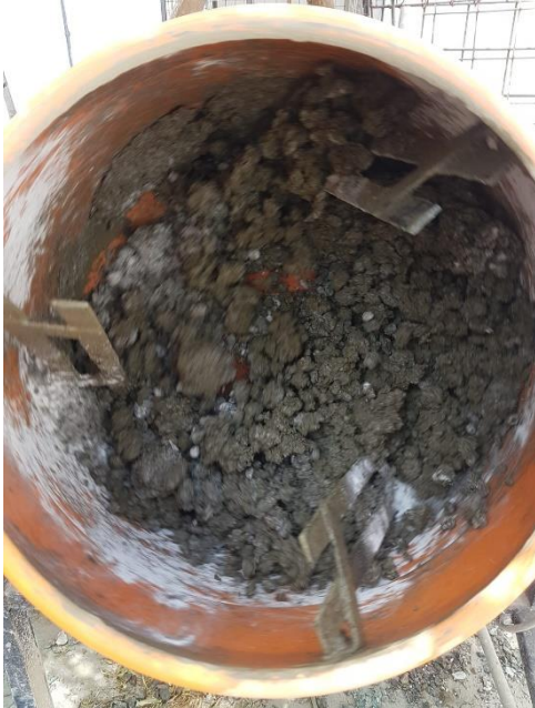
Ilustración 72. ENSAYO N° 7, Diseño de mezcla incorporando poliestireno expandido 20 %
