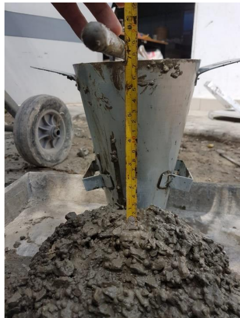
Ilustración 72. ENSAYO N° 7, Diseño de mezcla incorporando poliestireno expandido 20 %
