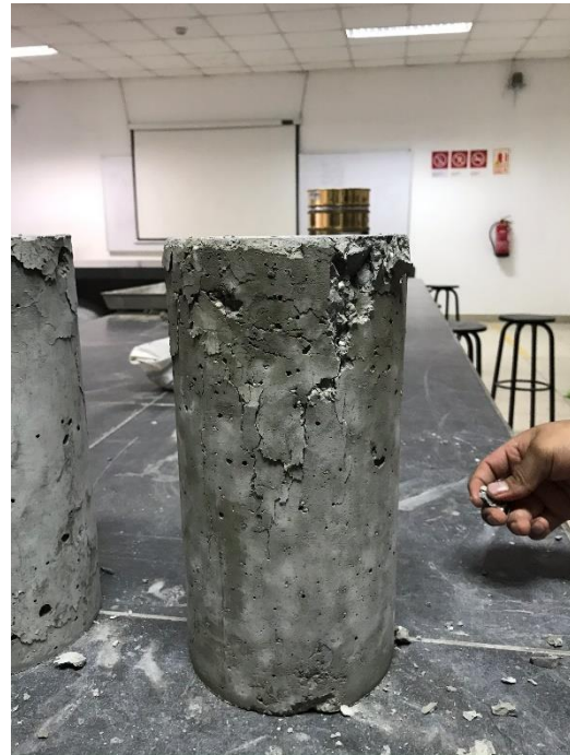
Ilustración 63. MUESTRA N° 15, Carga máxima debido al esfuerzo de compresión – EPS = 10%
