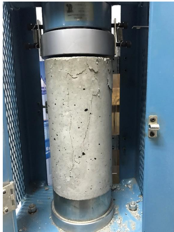
Ilustración 60. MUESTRA N° 13, tipo de falla – EPS= 10%
