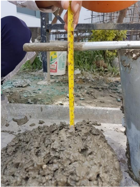
Ilustración 73. ENSAYO N° 7, Asentamiento de la mezcla con poliestireno expandido 20 %
