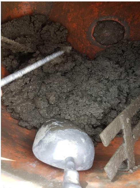
Ilustración 74. ENSAYO N° 7, Diseño de mezcla incorporando poliestireno expandido 20 %
