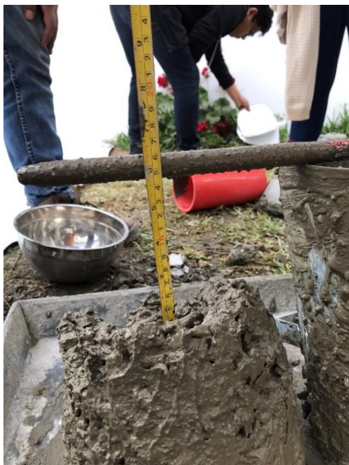
Ilustración 41. ENSAYO N° 2 – Concreto patrón, medida del asentamiento entre de 5 a 10 minutos.
