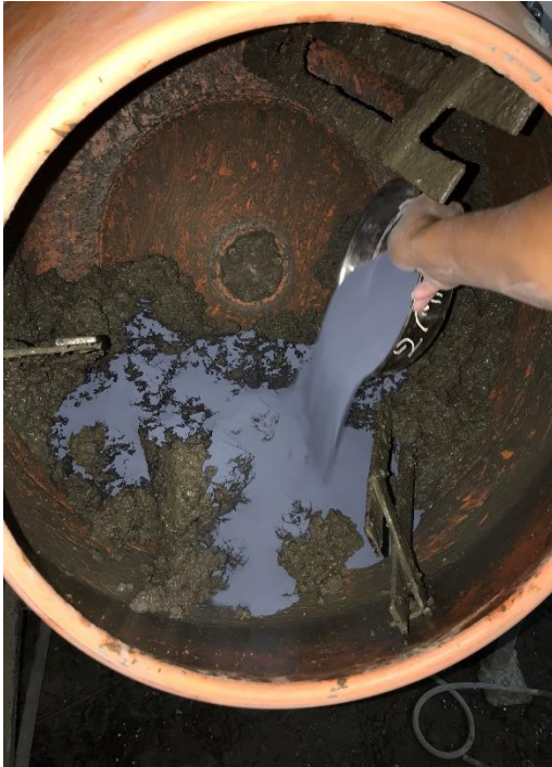
Ilustración 69 . ENSAYO N° 6, Diseño de mezcla incorporando poliestireno expandido 15 %
