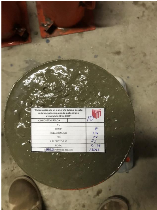
Ilustración 51. ENSAYO N° 3, Muestras en estado fresco.
