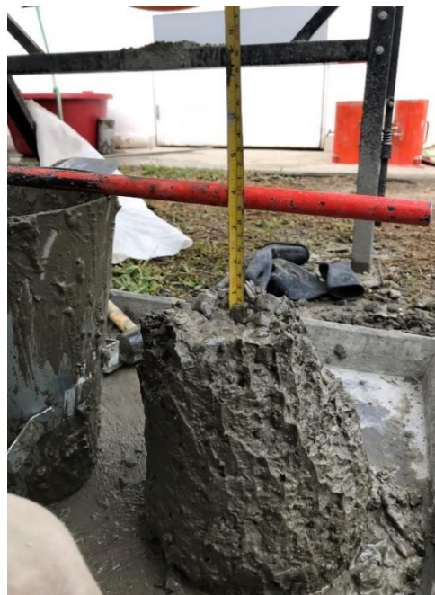
Ilustración 41. ENSAYO N° 2 – Concreto patrón, medida del asentamiento entre de 5 a 10 minutos.
