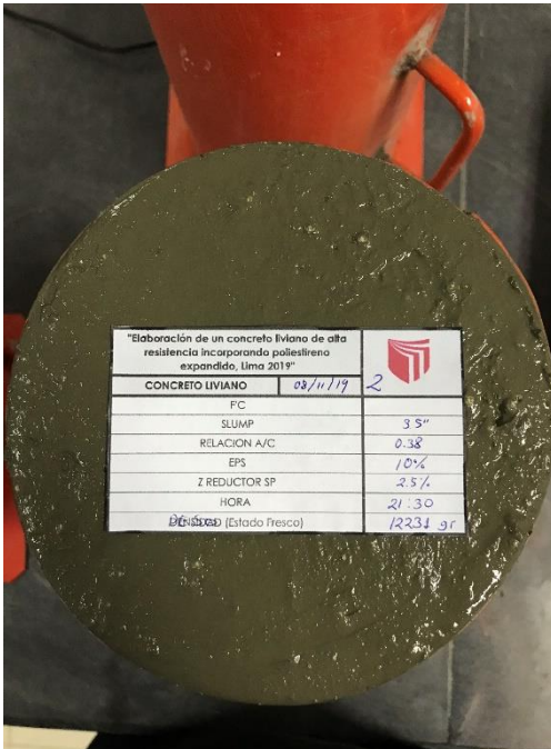
Ilustración 56. ENSAYO N° 4, Muestras con poliestireno expandido 10%
