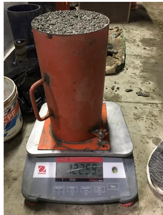
Ilustración 64. ENSAYO N° 5, Muestras con poliestireno expandido 10%
