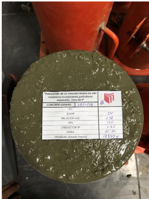
Ilustración 58. ENSAYO N° 4, Muestras con poliestireno expandido 10%
