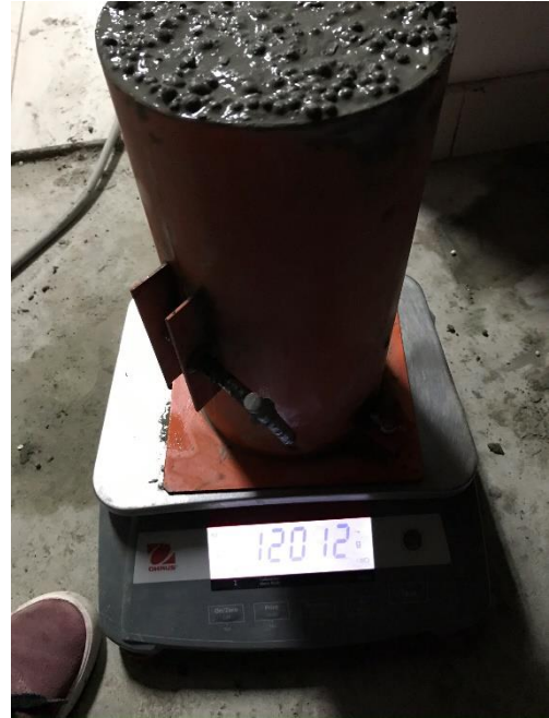
Ilustración 71. ENSAYO N° 6, Muestras con poliestireno expandido 15 %
