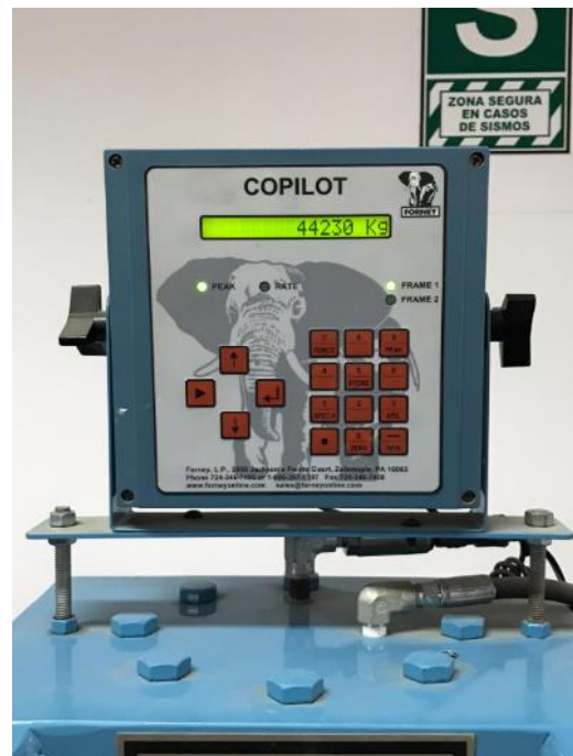
Ilustración 52. MUESTRA 04, ensayo de resistencia a la compresión a los 3 días.
