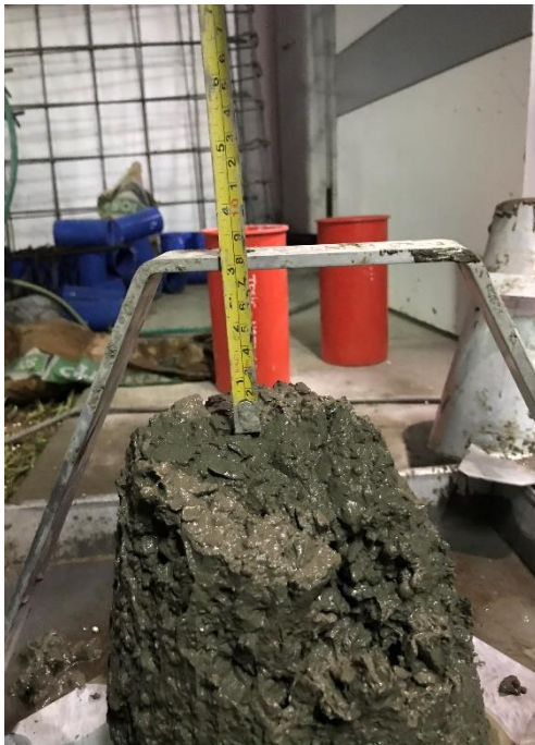
Ilustración 55. ENSAYO N° 4, Diseño incorporando poliestireno expandido 10%
