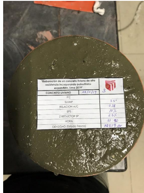
Ilustración 56. ENSAYO N° 4, Muestras con poliestireno expandido 10%
