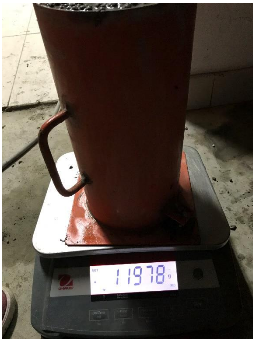
Ilustración 70. ENSAYO N° 6, Muestras con poliestireno expandido 15 %
