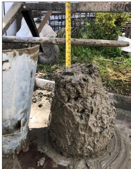
Ilustración 16. Medida del asentamiento en pulgadas.
