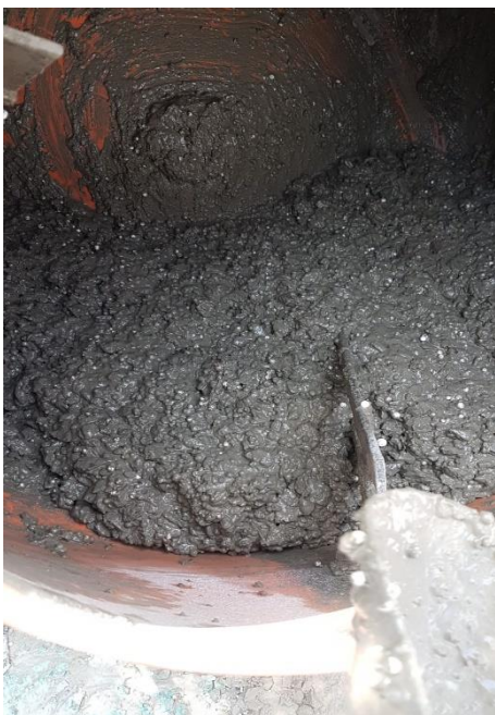
Ilustración 75. ENSAYO N° 7, Diseño de mezcla incorporando poliestireno expandido 20 %
