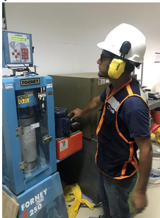
Ilustración 76. Rotura de probetas, EPS = 15%
