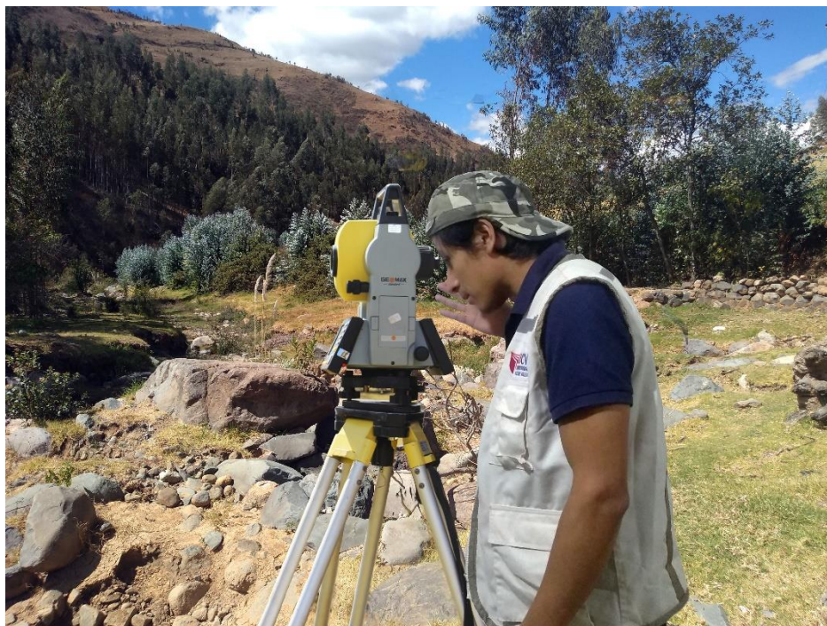
Figura 15. Levantamiento topográfico con estación total
