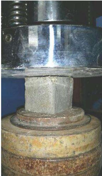
Foto N° 06: Resistencia a compresión de cubos
