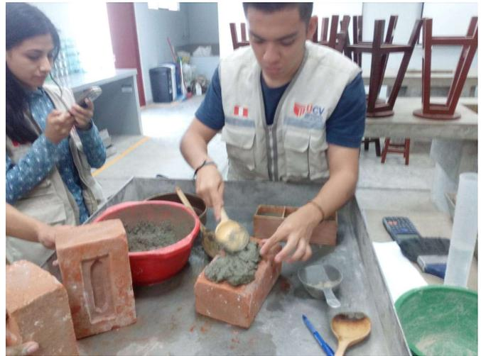
Foto N° 09: Resistencia a la compresión de unidades de albañilería
