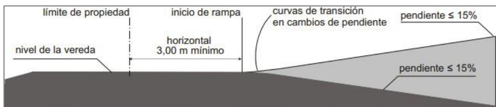
Figura 164. Rampa de acceso a sótano
