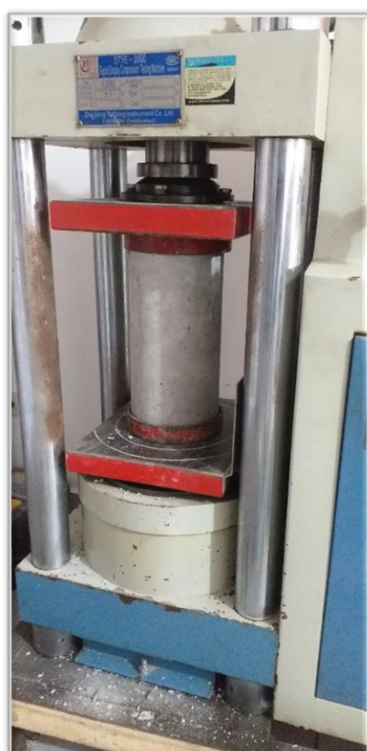
Figura 20: Roturas de las probetas a los 7, 14, 28 días.
