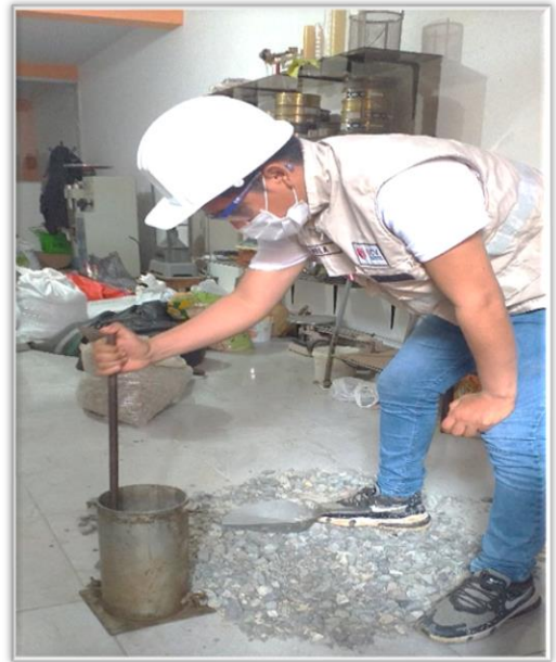
Figura 04: Peso unitario varillado del agregado grueso.
