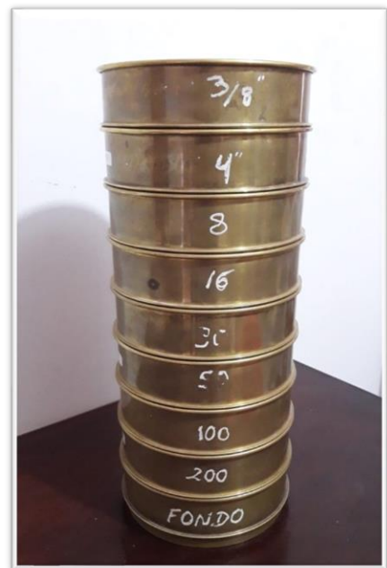
Figura 08: Tamices ordenado de acuerdo a la normativa, para determinar la granulometría agregado fino.
