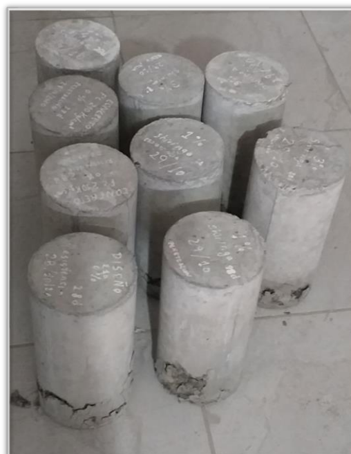
Figura 21: Probetas después del ensayo a compresión.
