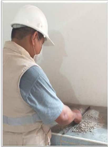
Figura 07: Cuarteo del agregado fino para luego pasar por los tamices.
