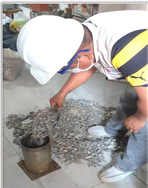
Figura 05: Peso unitario suelto del agregado grueso.
