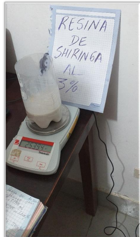
Figura 17: Pesando la resina de shiringa en base al 3%.
