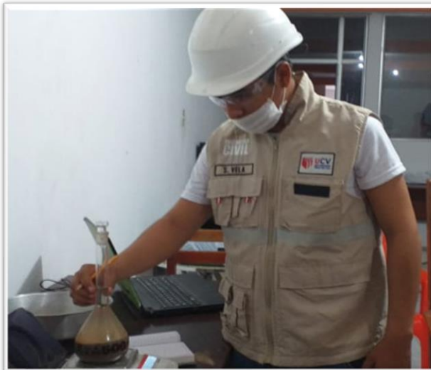
Figura 11: Peso específico y absorción del agregado fino.
