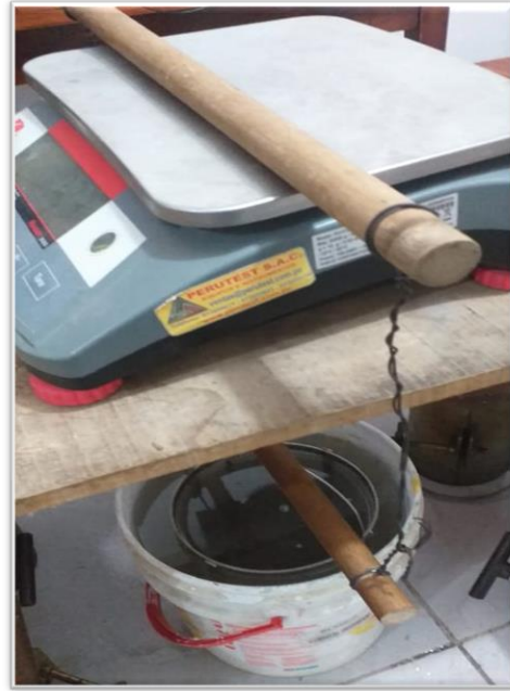
Figura 14: Ensayo de peso específico y absorción del agregado grueso.
