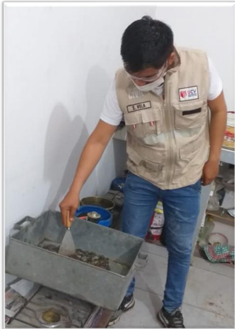
Figura 15: Secado del agregado grueso.
