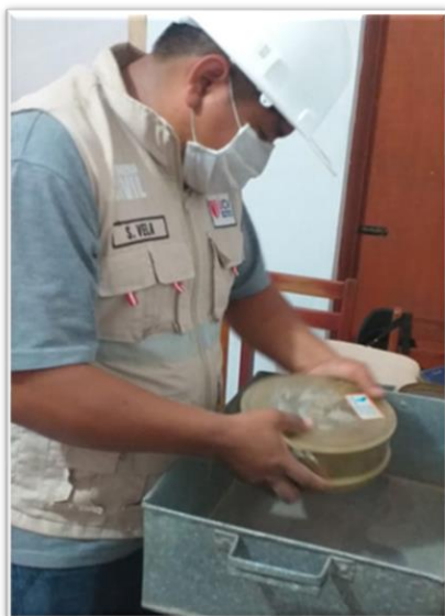
Figura 09: Tamizado manual, del agregado fino.
