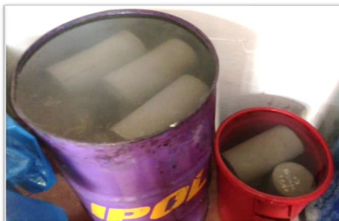
Figura 19: Curado del concreto.
