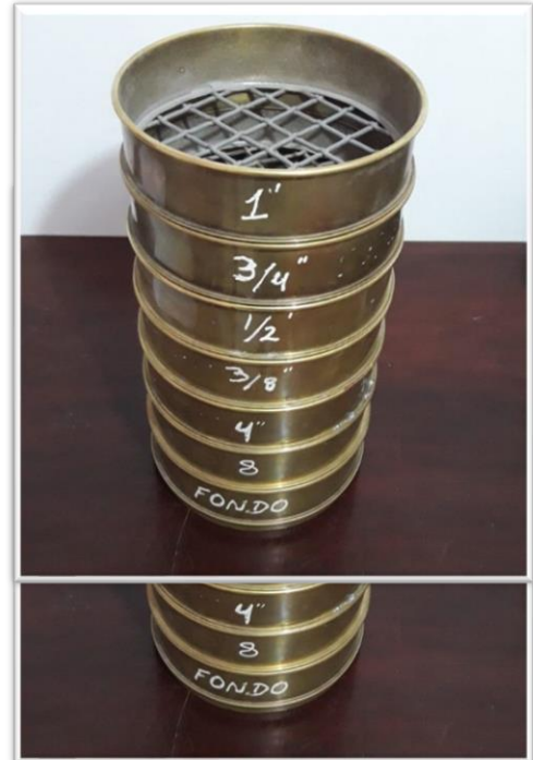
Figura 10: Tamices ordenado de acuerdo a la normativa, para determinar la granulometría del agregado grueso.
