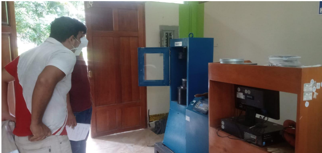
Foto N° 3: Preparando la prensa para empezar con la rotura
