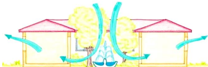
Ilustración 95 – Ventilación a través de patios
