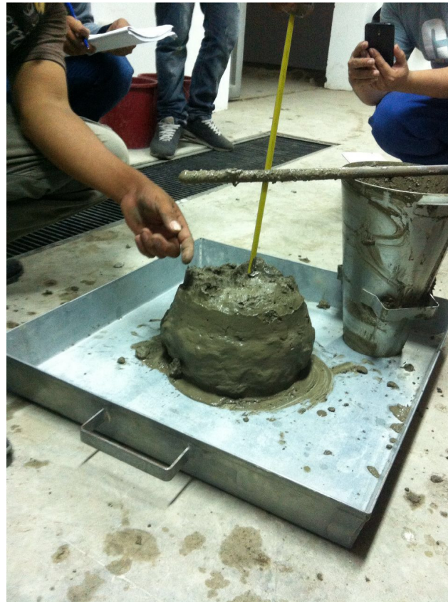
Figura 6: Asentamiento del concreto.
