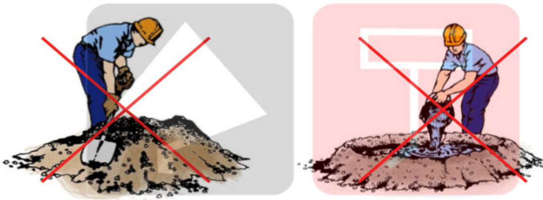
Figura 5: mezclado a mano está prohibido. Fuente: SENCICO (2014).
