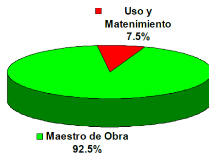
Figura 23: distribución de fallas según las etapas del proceso constructivos. Fuente: IX convención del ACI Perú.
