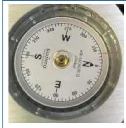
Figura 17: Brújula para determinar el 1er segmento
