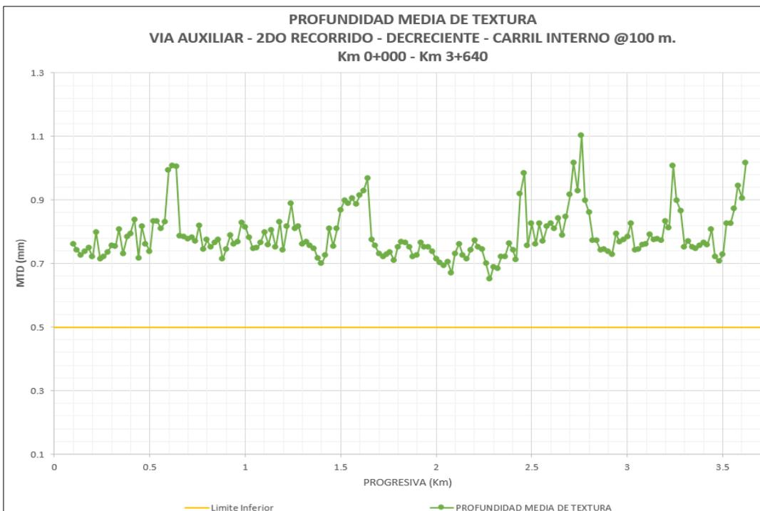
*Figura 113. Textura – Vía Auxiliar – 2do Recorrido – km 0+00 – km 3+640 – Calzada Decreciente – Carril Interno.*
