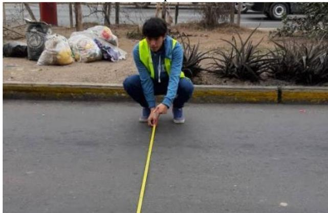
*Figura 28. Medición de la Profundidad del Ahuellamiento – km 0+325 – Calzada Creciente – Carril Interno.*
