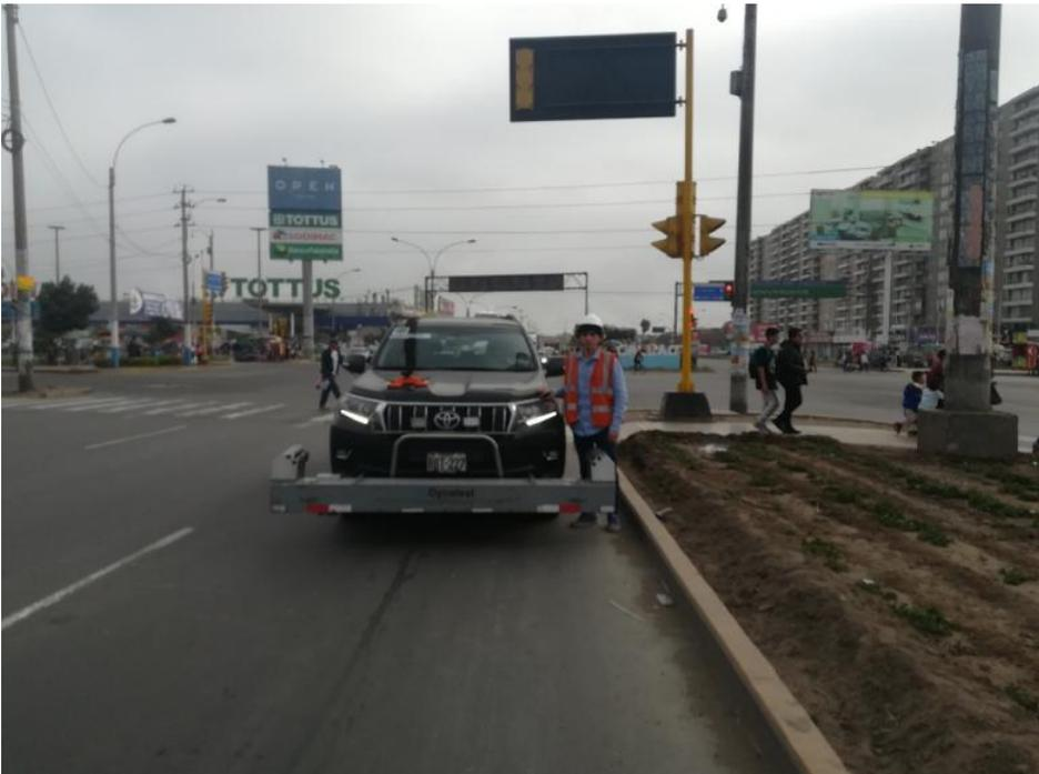
*Figura 17: Vehículo del Perfilómetro.*
