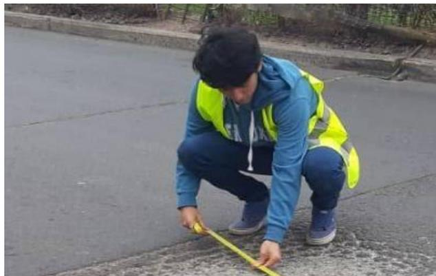
*Figura 44. Medición del área del Parche – km 1+325 – Calzada Creciente – Carril Interno.*
