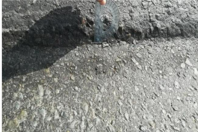
*Figura 42. Medición de la Profundidad del Ahuellamiento – km 1+250 – Calzada Decreciente – Carril Externo.*
