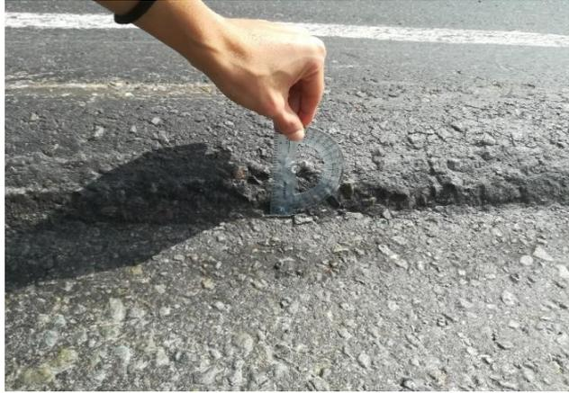
*Figura 26. Medición de la Profundidad del Ahuellamiento – km 0+250 – Calzada Decreciente – Carril Externo.*
