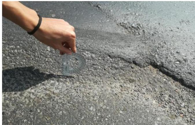
Figura 72. Medición de la Profundidad del Ahuellamiento – km 3+130 – Calzada Decreciente – Carril Interno.
