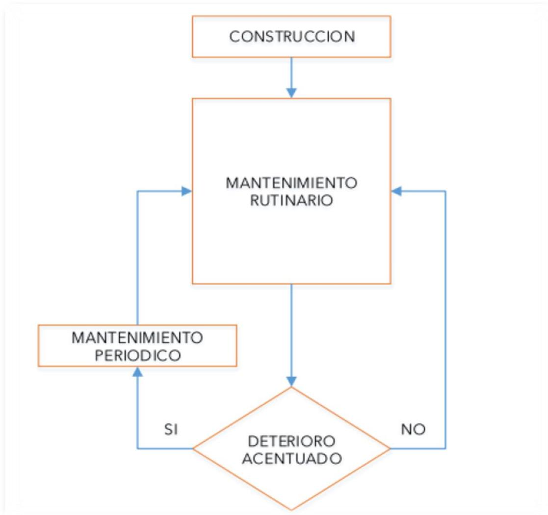
Figura 10. Diagrama del flujo de Ciclo de vida del Pavimento con Mantenimiento.
