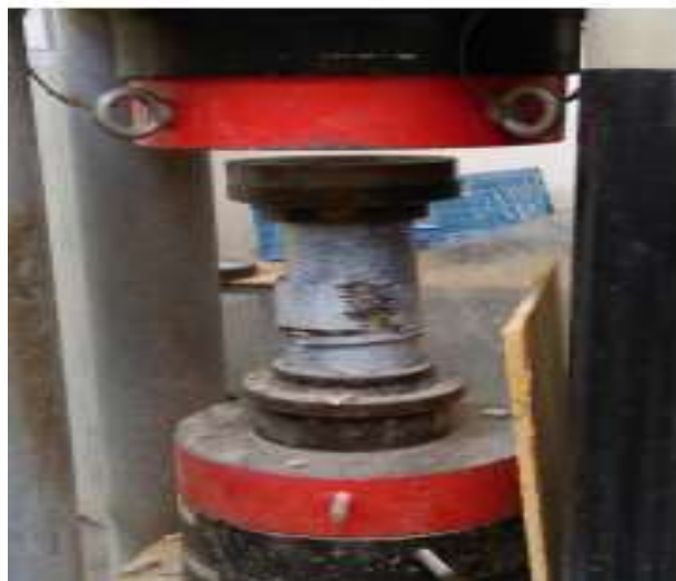
Figura 6. Ensayo a Compresión con Fibra de Carbono.
