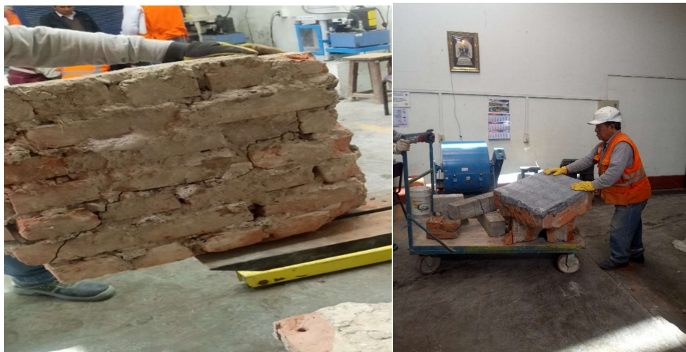
Figura 32. Traslado del Espécimen con Fibra de Carbono después de ser Ensayado a Compresión Diagonal donde se observa que no se desprende la Fibra.
