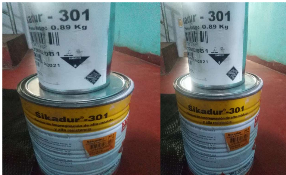
Figura 26. Sikadur 301 componentes A y B. Usados para adherir la Fibra.
