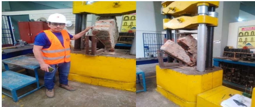
Figura 23. Espécimen sin Refuerzo Ensayado a Compresión Diagonal.
