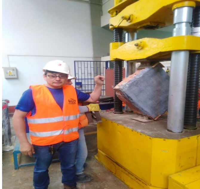
Figura 29. Espécimen con Fibra de Carbono antes de ser Ensayado a Compresión Diagonal.
