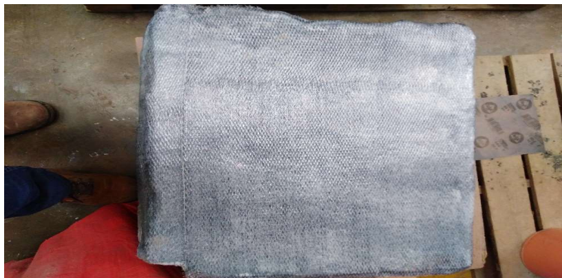
Figura 28. Murete Reforzado con Fibra de Carbono.
