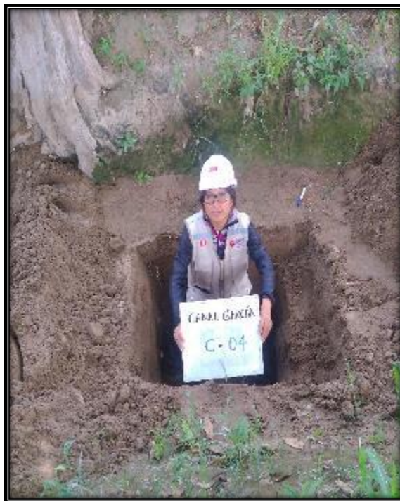
FOTO 04: Excavación y extracción de muestras en la calicata N° 04.
