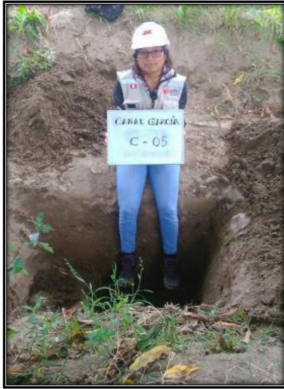
FOTO 05: Excavación y extracción de muestras en la calicata N° 05.
