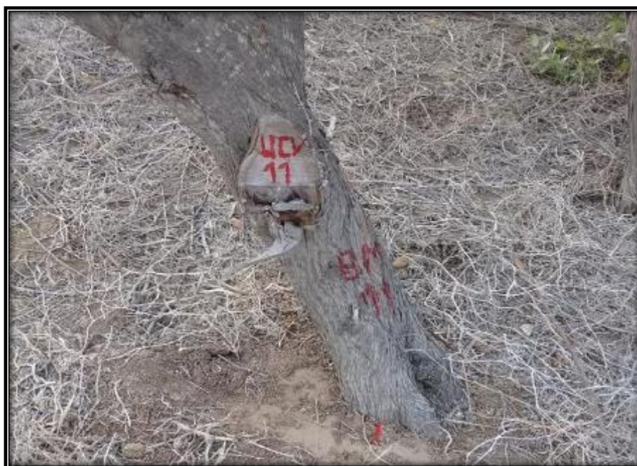
FOTO 07: Se observa BM11, se localiza en una estaca de fierro
