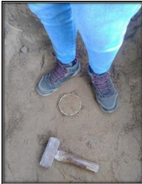
FOTO 08: Excavación de muestra para corte directo.
