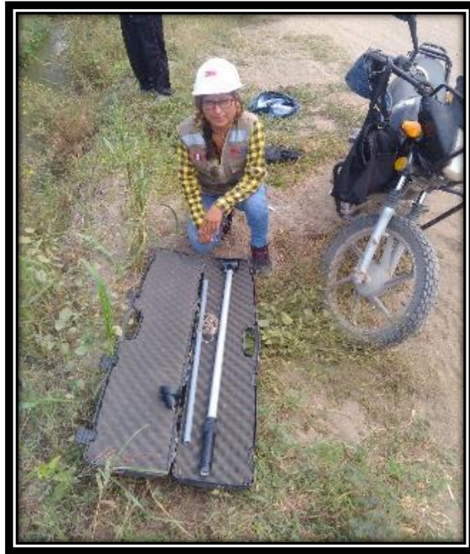
FOTO 01: vista del equipo (correntómetro) para aforar el canal García
