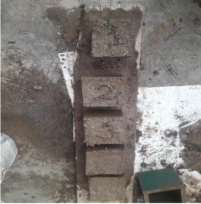
6 muestras de adobe con adición de 3.5% de fibra de eucalipto (10x10x10)
