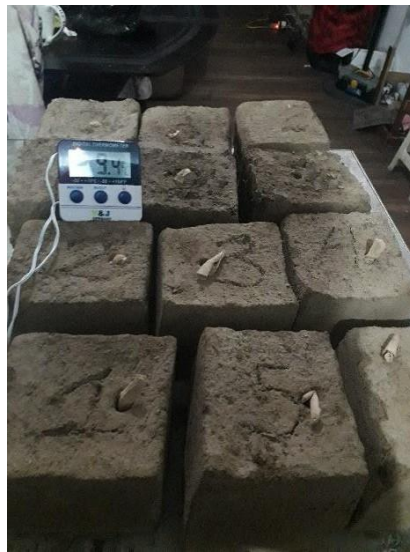
De esta forma se realizó la toma de medidas de la temperatura antes de introducir al refrigerador y durante las 24H, 48H y 72H
