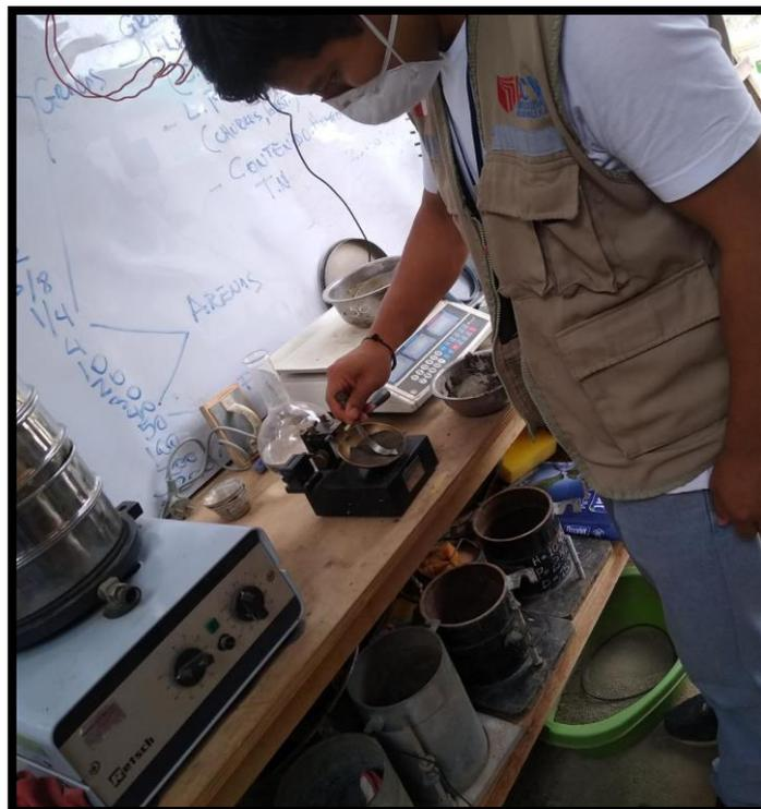
Fotografía: Ensayo de límites de consistencia
