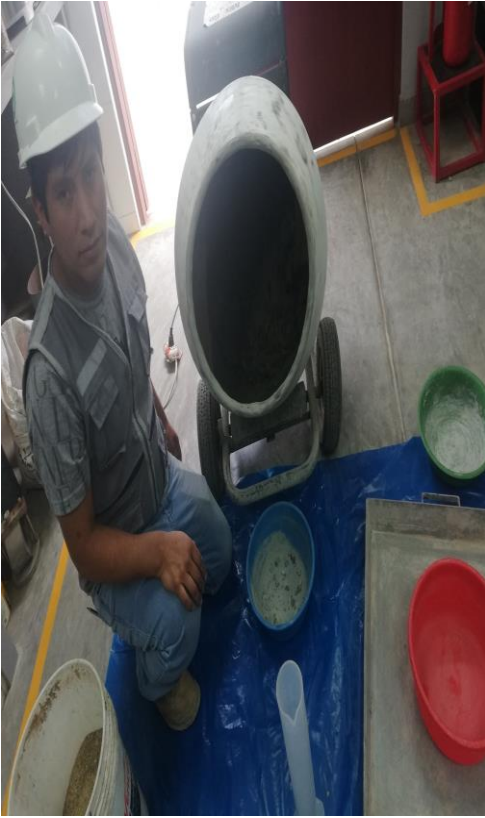
Ilustración 12: Preparación de concreto para probetas.
