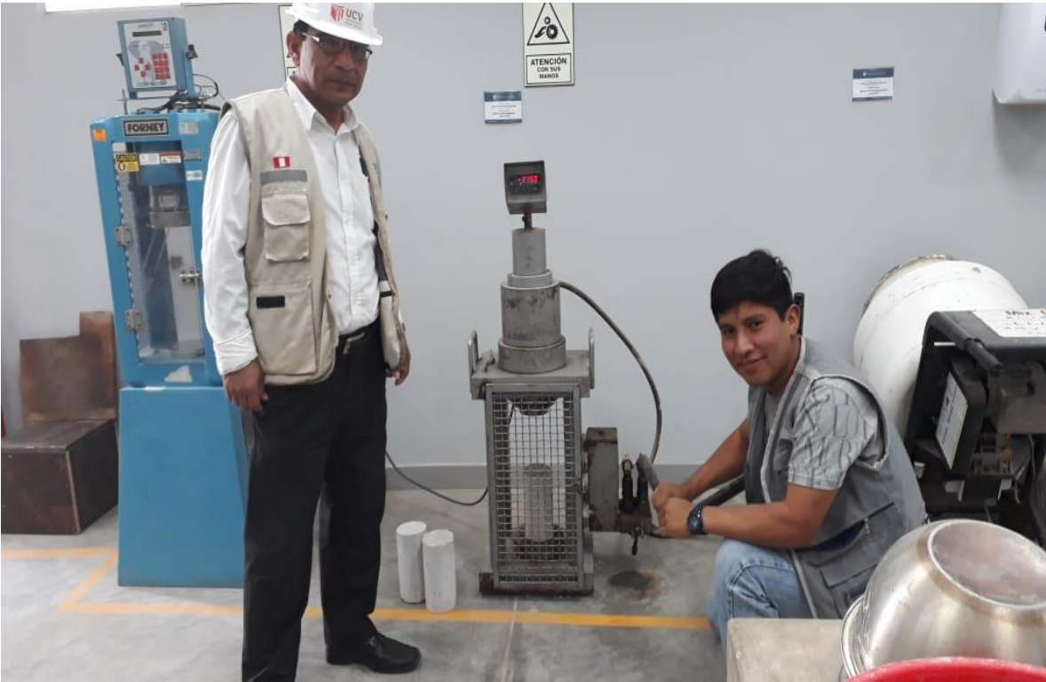
Ilustración 15: Rotura de probetas con el asesor de tesis.
