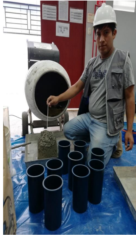
Ilustración 13 Fabricación de probetas
