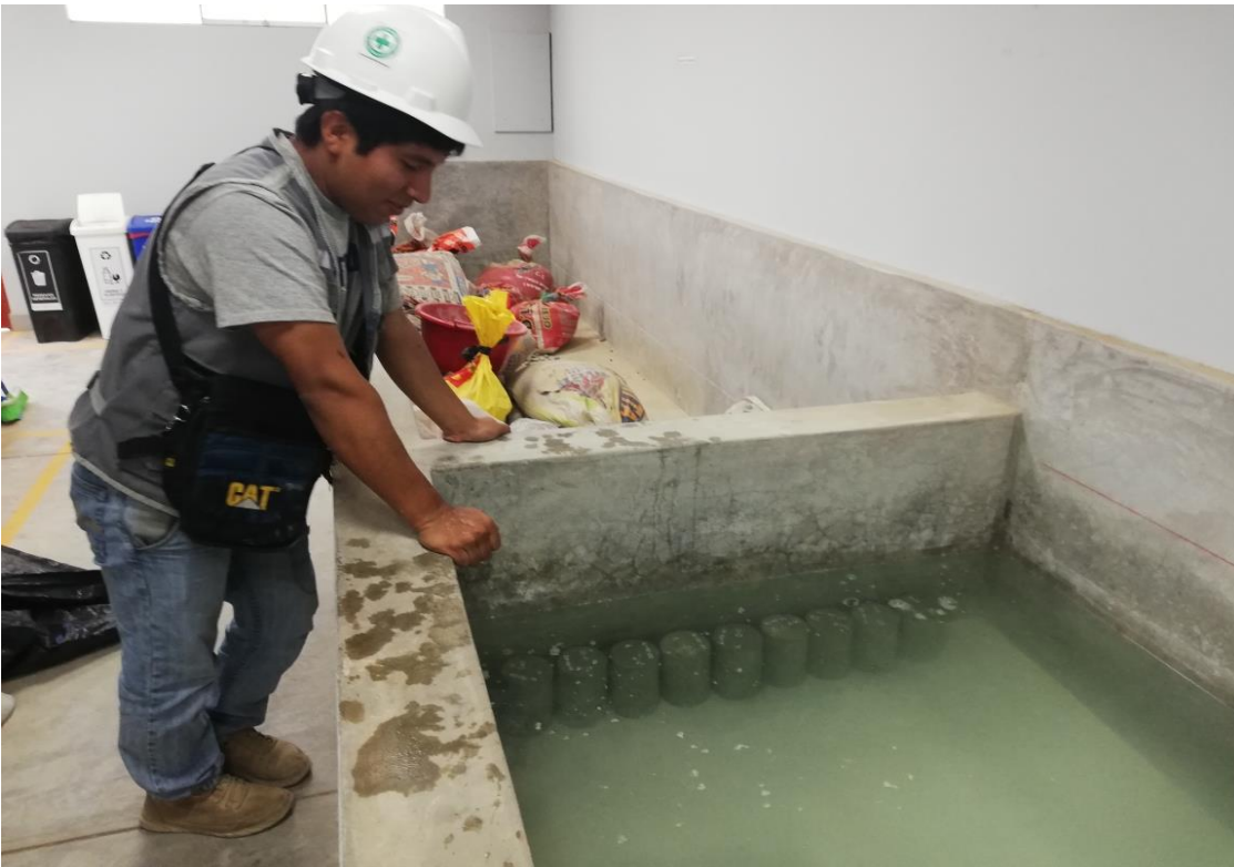
Ilustración 14 Curado de Probetas
